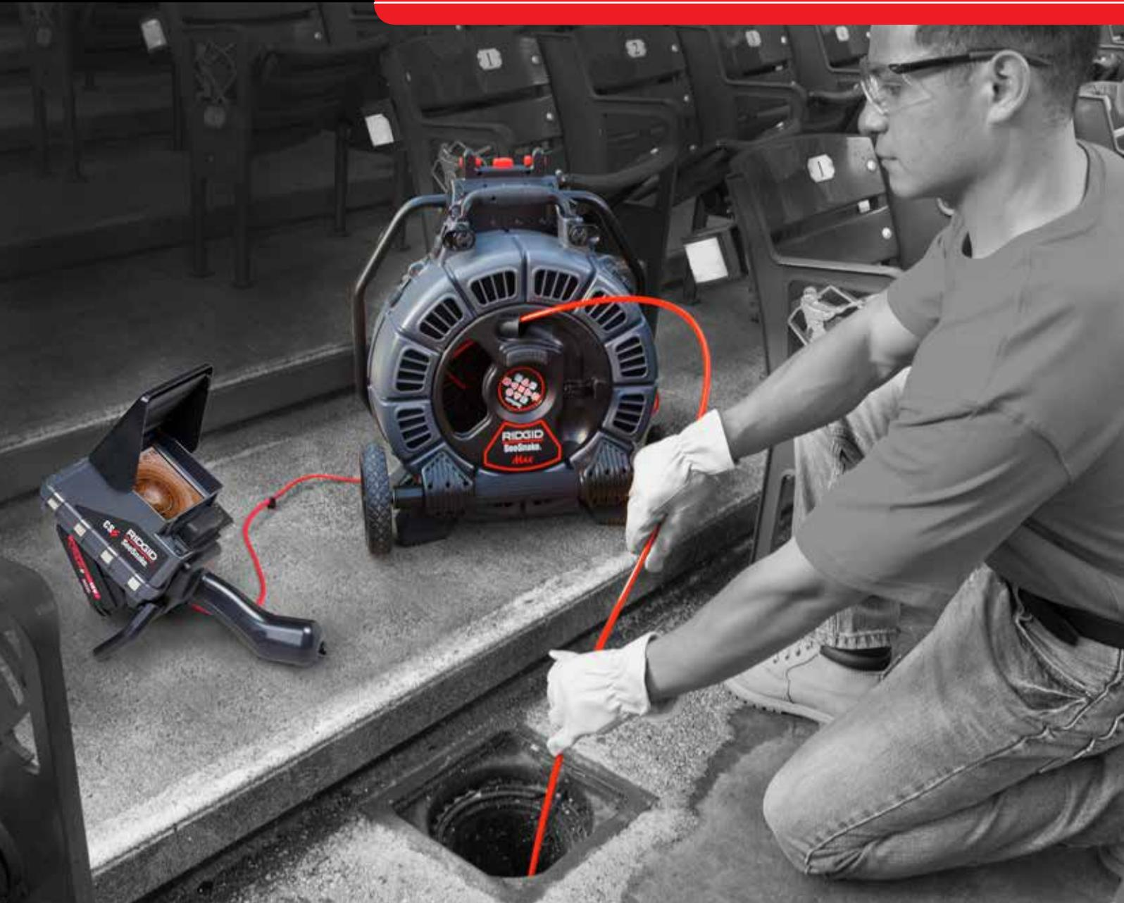
**Das rM200 Kamerasystem verbindet Mobilität mit der Vielseitigkeit der D2 Trommeln, die verschiedene Steifigkeiten des Schubkabels und der Feder aufweisen, um jede Art von Inspektion zu meistern.**
