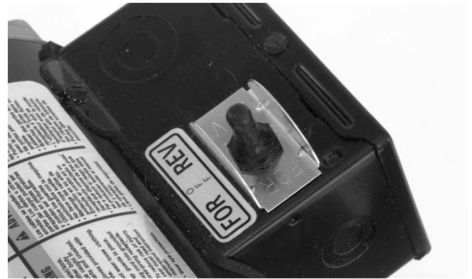
Figure 4 – Interrupteur directionnel en position OFF (arrêt)
