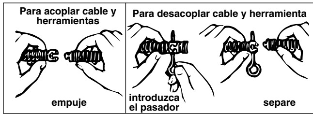
Figura 5 – Acoplamiento y desacoplamiento de las herramientas
