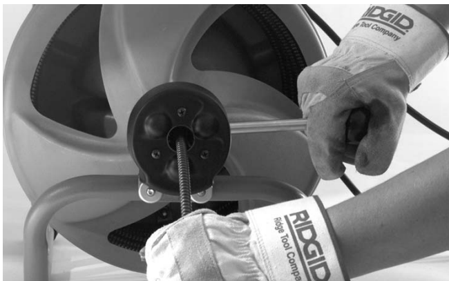
Figura 8 – Auto-alimentador en posición de reversa
