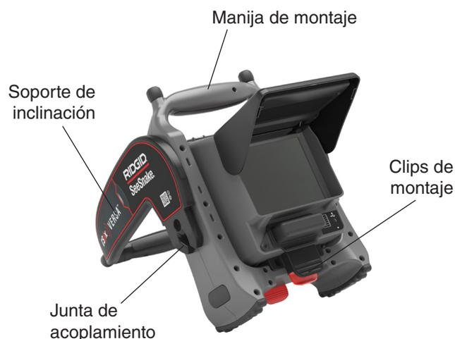
2. Centre el CS6x Versa sobre las aletas de acoplamiento y alinee las juntas de acoplamiento con los brazos de conexiones.
