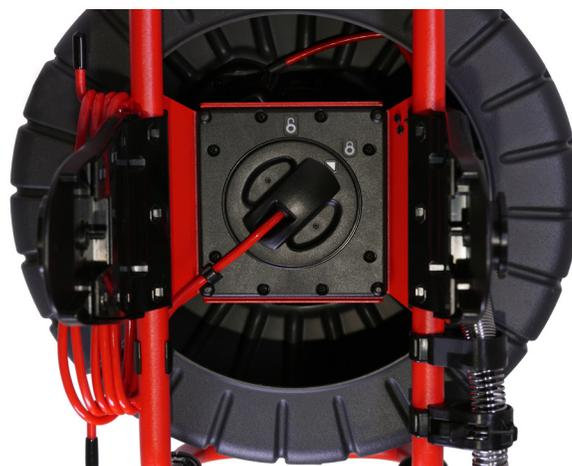
3. Enganche el cable del sistema en el gancho del cuadro y encaje el anclaje del cable en el cuadro.
