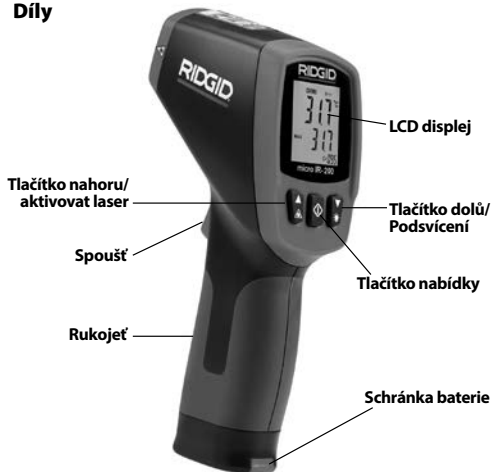
Obrázek 2 - Díly micro IR-200
