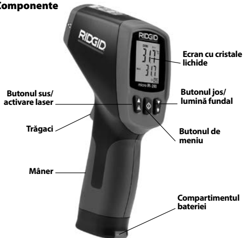
Figura 2 – Componentele micro IR-200
