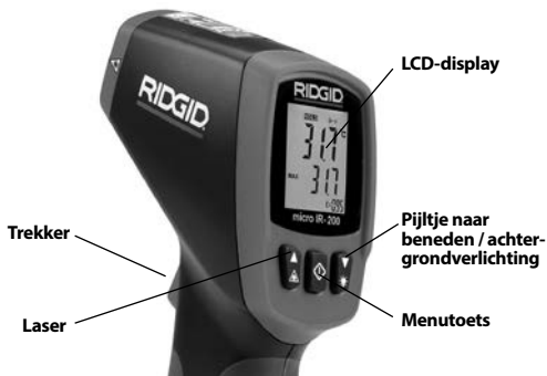
Figuur 8 – Display/Toetsen van de micro IR-200
