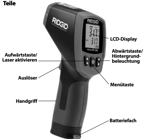
Abbildung 2 – Teile des micro IR-200
