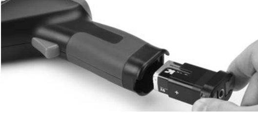
Şekil 5 – Pil Tutucu ve Kutup Yönü İşareti
