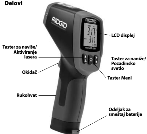
Slika 2 – Delovi uređaja micro IR-200
