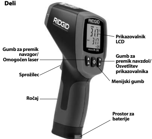
Slika 2 – Deli instrumenta micro IR-200
