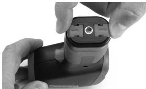
Figur 4 – Sådan fjernes batterirummet
