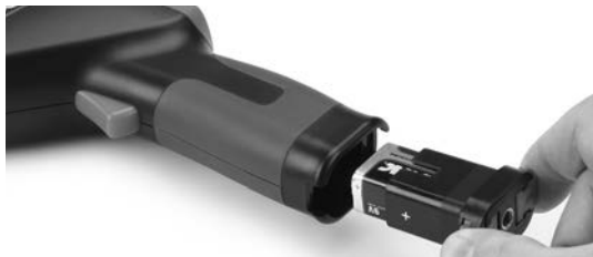
Obrázok č. 5 – Držiak batérie a označenie polarity
