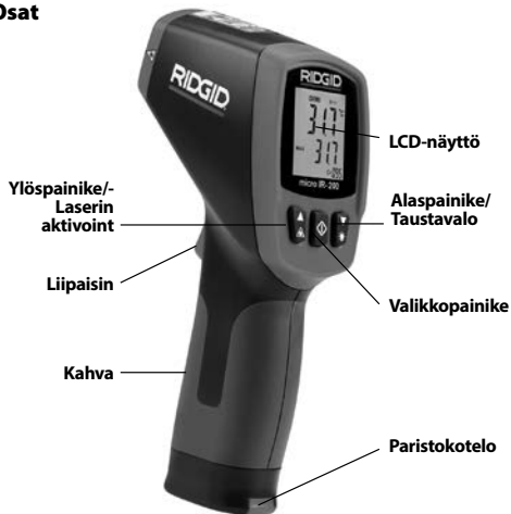
Kuva 2 – micro IR-200:n osat
