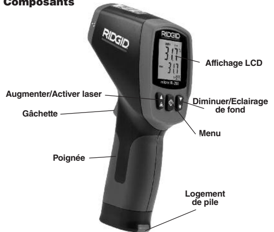
Figure 2 – Composants du micro IR-200
