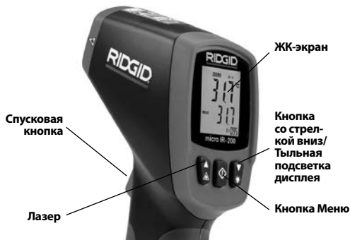
Рис. 9 – Дисплей и кнопки прибора micro IR-200
