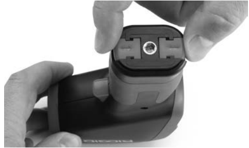
Şekil 4 – Pil Bölmesinin Çıkarılması
