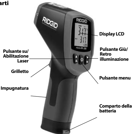
Figura 2 - Parti del micro IR-200
