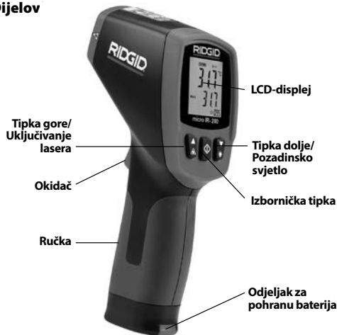
Slika 2 – Dijelovi uređaja mikro IR-200
