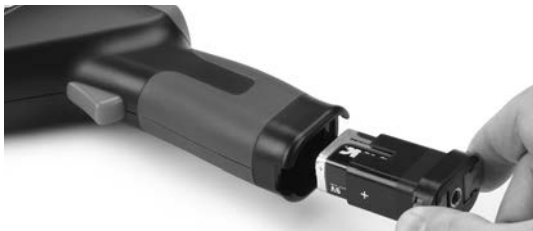
Figur 5 – Batteriholder og polaritetsmarkering
