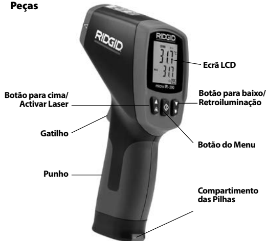
Figura 2 – Peças do micro IR-200
