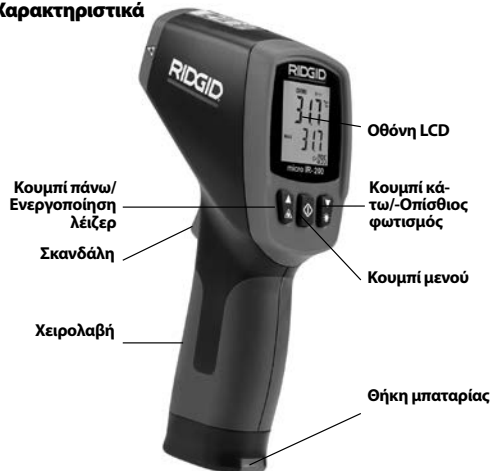
Εικόνα 2 – Εξαρτήματα του micro IR-200
