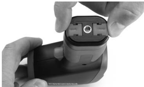
Slika 4 – Odstranjevanje prostora za baterije
