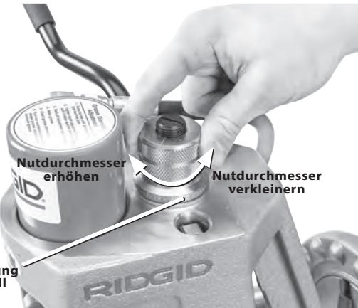
**Abbildung 13 - Einstellung der Tiefeneinstellmutter**
