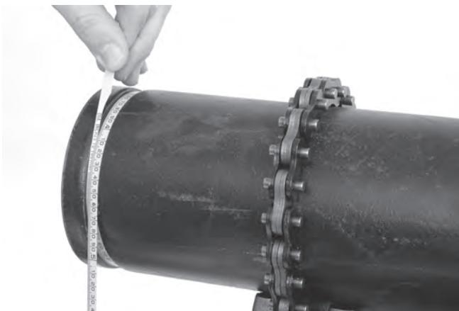
**Abbildung 17 - Prüfen des Nutdurchmessers mit einem Durchmesserband**
