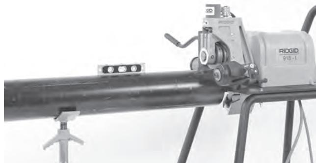
Abbildung 11 - Rohr nivellieren
