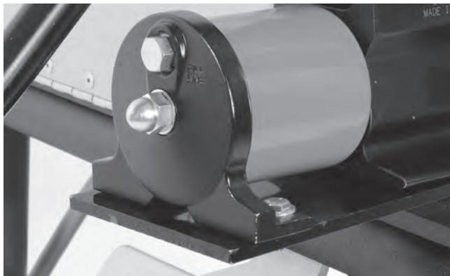
Figure 19 – Bouchon de remplissage d'huile
