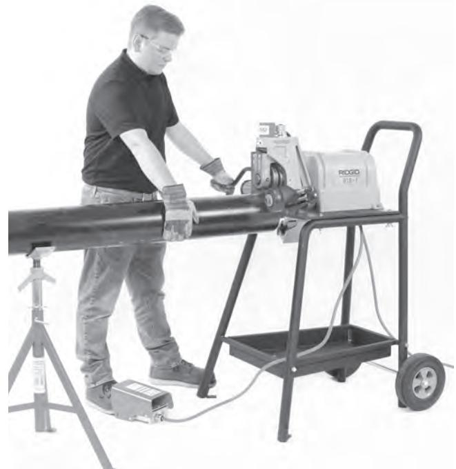
**Abbildung 16 – Ausüben von Druck am Rohr**
