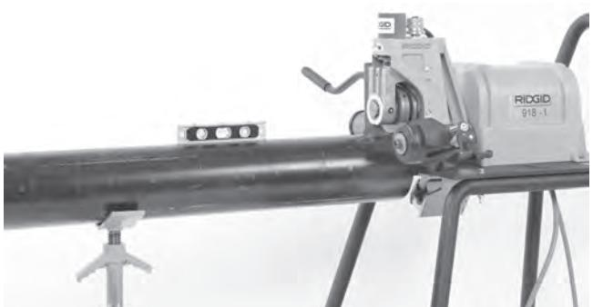
**Figura 11 – Nivelación del tubo**
