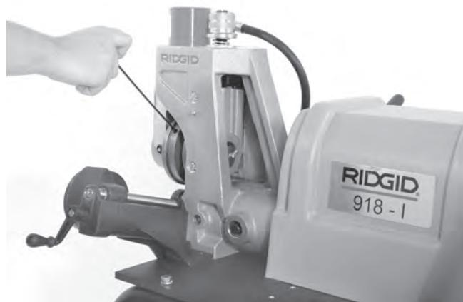
Abbildung 20 - Lösen der Stellschraube der Nutrolle
