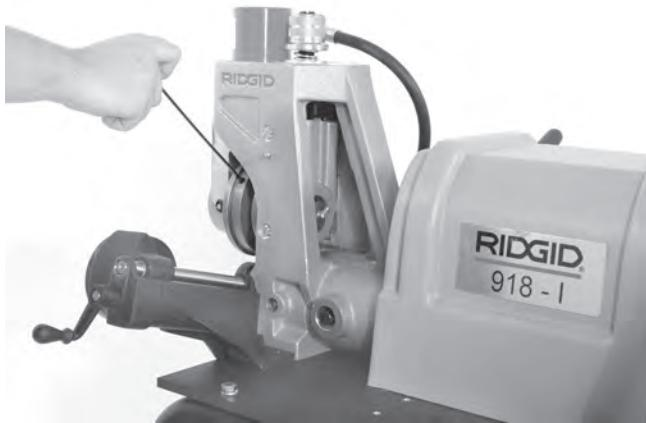
**Figura 20 – Afloje el tornillo de montaje del juego de rodillos ranuradores**
