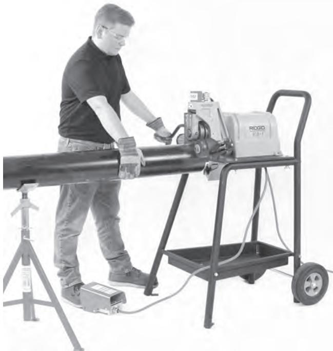
Figura 16 – Aplicación de presión sobre el tubo
