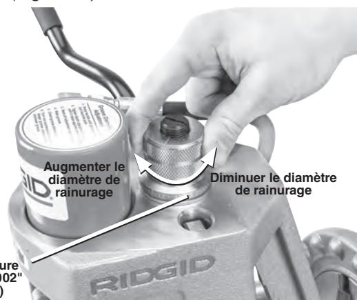
**Figure 13 – Réglage de l'écrou de profondeur de rainurage**
