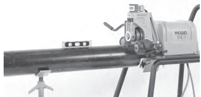
Figure 11 – Nivellement du tuyau
