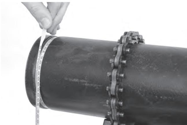
Figure 17 – Vérification du diamètre en fond de rainure à l'aide d'un ruban
