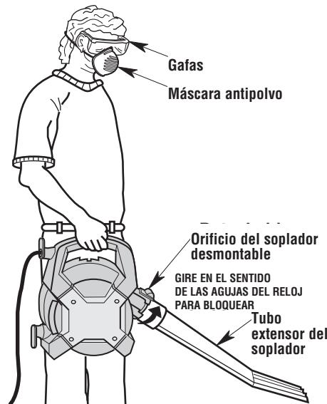
2. La aspiradora para mojado/seco también puede utilizarse para soplar utilizando la manguera de siete pies de longitud suministrada con la aspiradora para mojado/seco. Instale el extremo con botón pulsador de la manguera de aspiración en el orificio de soplado del soplador desmontable. Para tener control adicional, se puede añadir un tubo extensor y/o una boquilla para auto en el extremo opuesto de la manguera. Una vez hecho esto, la unidad estará lista para realizar aplicaciones de soplado.
