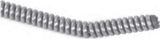
Şekil 15 – Spiral Ucunda Büküm
