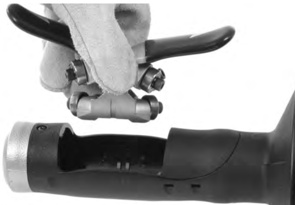
Figura 12B – Extracción del mecanismo de la AUTOFEED
