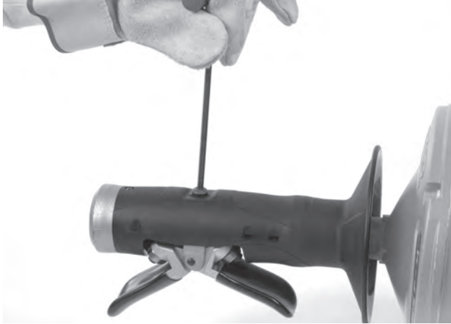
Şekil 12A – AUTOFEED Vidasının Çıkartılması
