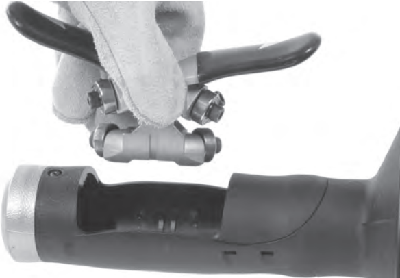
Şekil 12B – AUTOFEED Mekanizmasının Muhafazadan Çıkartılması
