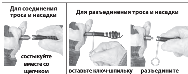
Рис. 7 – Подсоединение и отсоединение насадок
