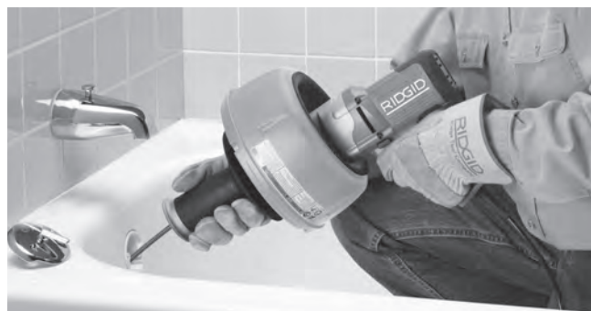
Рис. 9 – Протолкните трос дальше в канализационную трубу
