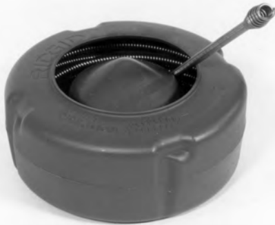
Figura 16 – Enrolle el cable dentro del tambor interior en el sentido de las manecillas del reloj
