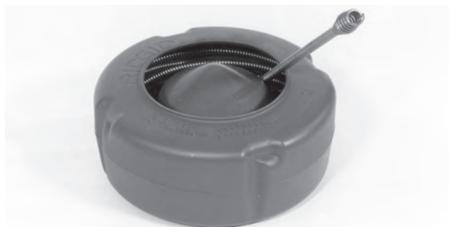
Рис. 16 – При заправке троса во внутренний барабан наматывайте трос ПО ЧАСОВОЙ СТРЕЛКЕ.
