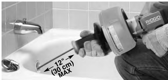
Figure 8 – Ramener la poignée vers le tambour pour que le mandrin appréhende le câble
