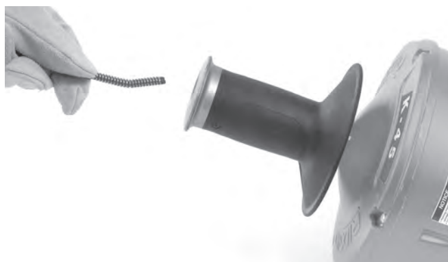
Рис. 17 – Заправка троса без замены внутреннего барабана
