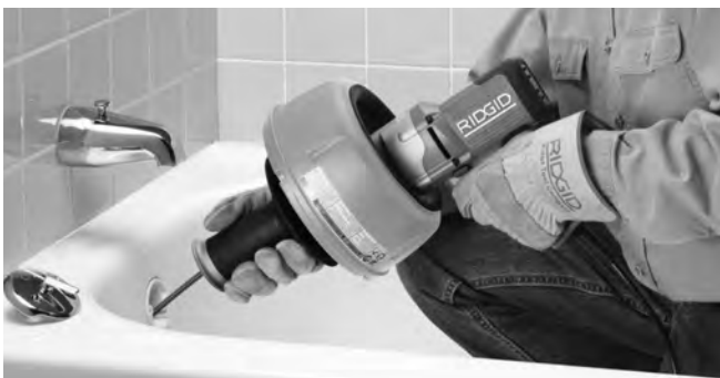
Figure 9 – Pousser le câble dans la conduite
