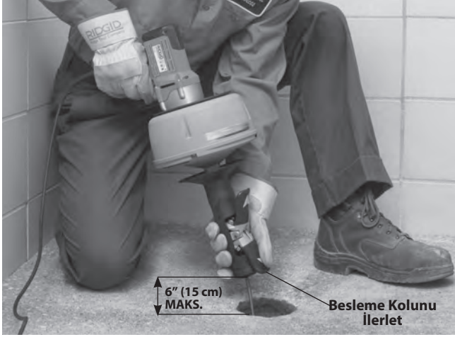
Şekil 10 – Kablonun AUTOFEED İle Beslenmesi
