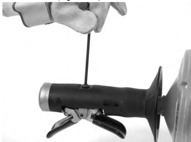
Figure 12A – Retrait de la vis de l'AUTOFEED
