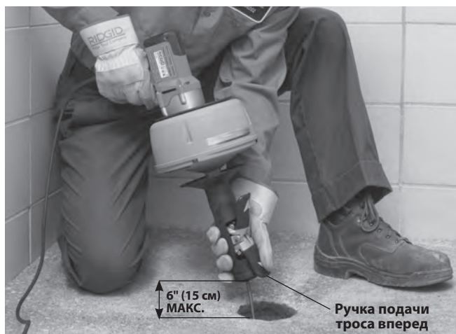
Рис. 10 – Подача троса с помощью устройства AUTOFEED
