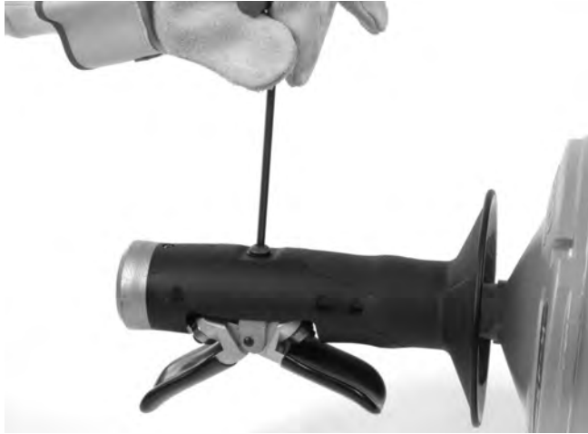
Figura 12A – Extracción del tornillo de la AUTOFEED
