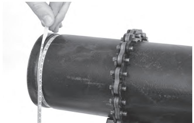
Abbildung 18 - Prüfen des Nutdurchmessers mit einem Durchmesserband
