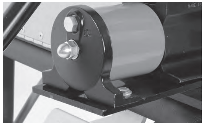
Abbildung 20 - Einfülldeckel des Behälters
