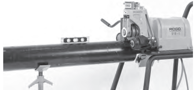
Figura 12 – Nivelación del tubo
