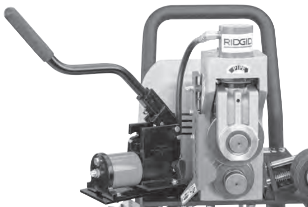
Abbildung 7B – Pumpe in Transportposition [oben]
