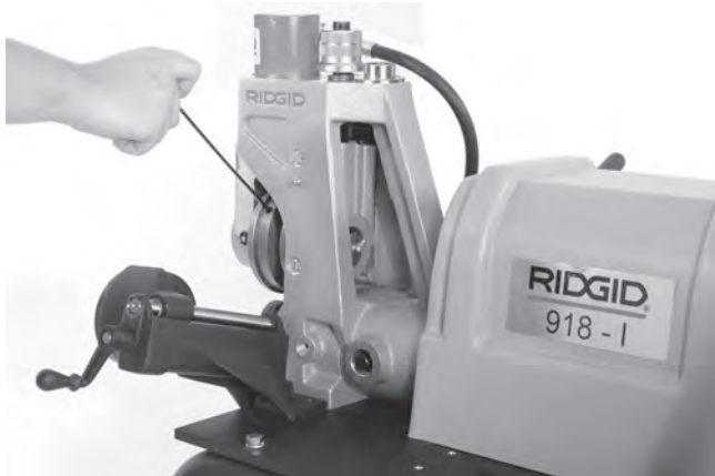
Abbildung 21 - Lösen der Stellschraube der Nutrolle
