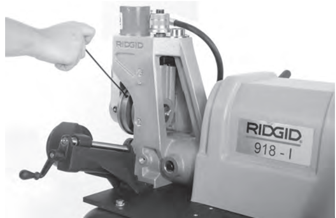
Figure 21 – Desserrage de la vis de blocage du galet de rainurage
