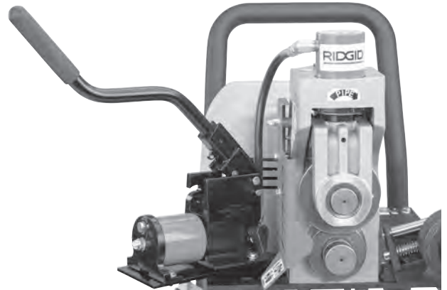
Figura 7 B – La bomba en posición de transporte [elevada]
