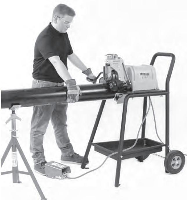
Figura 17 – Aplicación de presión sobre el tubo
