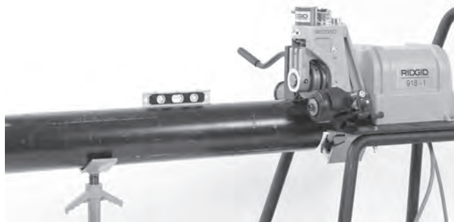
Figure 12 – Nivellement du tuyau
