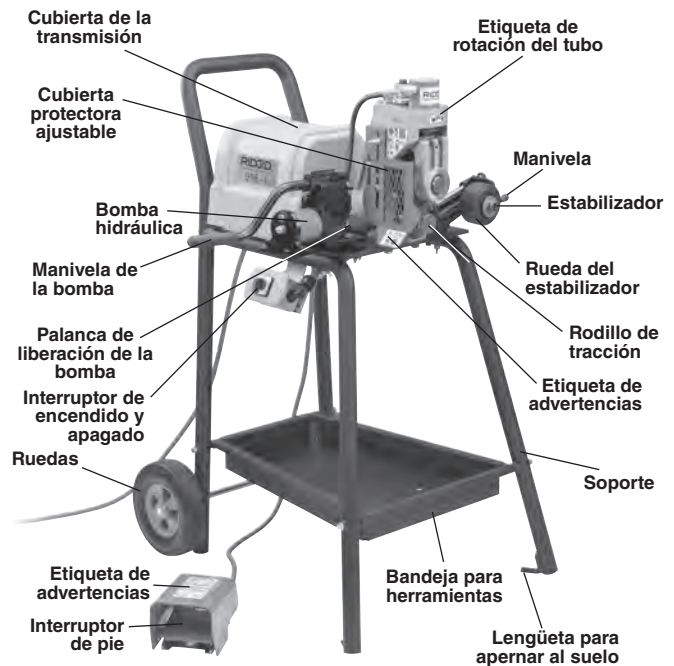
Figura 1 A – Ranuradora a rodillos 918-I
