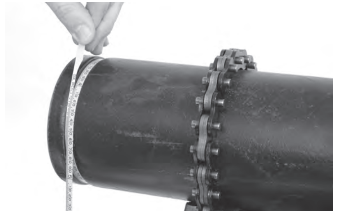
Figura 18 – Medición del diámetro en la ranura con la cinta de diámetros
