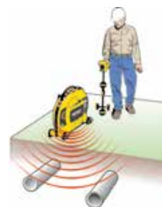
Indusere et signal for å lokalisere forsyningsledninger.
