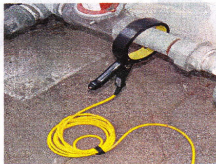
図4 例:インダクティブクランプの取り付け
