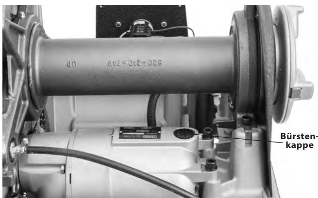
**Abbildung 34 – Ausbau der Motorenabdeckung/Austausch der Bürsten**
