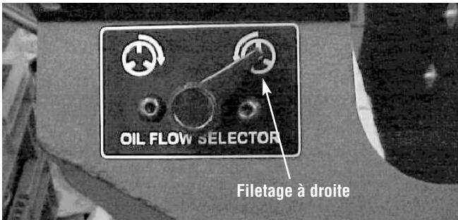
Figure 24 – Sélecteur de sens d'écoulement (à droite ou à gauche)
