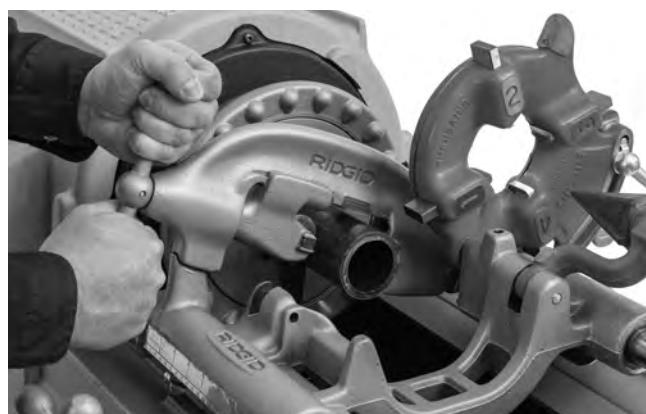
**Abbildung 21 – Schneiden von Rohren mit Rohrabschneider**
