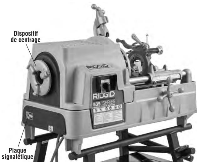
Figure 1B – Machine à fileter 535 à mandrin manuel
