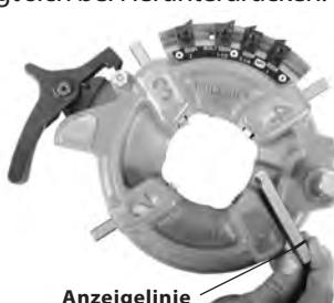
Abbildung 14 – Einsetzen der Schneidbacken
