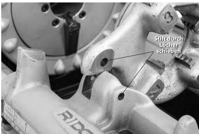
**Abbildung 26 – Linksschneidkopf sichern**
