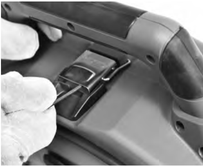
Abbildung 14 – Verschluss unter dem Tragegriff öffnen (mit Sechskantschlüssel)
