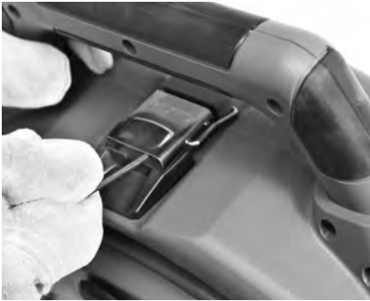
Figura 14 – Abra el sujetador debajo del mango; use la llave hexagonal
