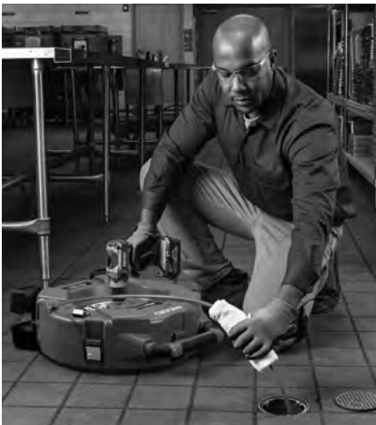
Abbildung 13 – Auftragen von Schmiermittel auf die Spiraleummantelung
