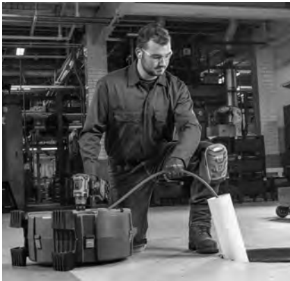
Figura 5 – Ejemplo de cómo extender el desagüe para que el acceso quede a menos de 3 pies (1 m) de la salida del cable
