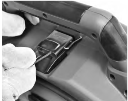
그림 14 - 운반 핸들 아래에 있는 래치를 엽니다 (육각 렌치 사용)
