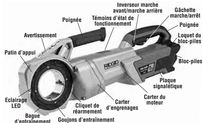
Figure 1 – Système d'entraînement 760 FXP Power Drive
