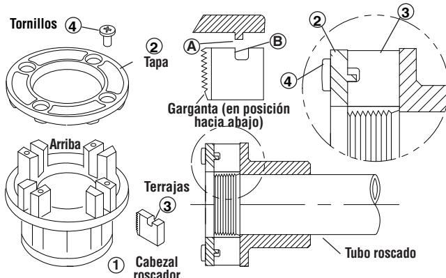
Figura 17 – Colocación de terrajas en el cabezal roscador
