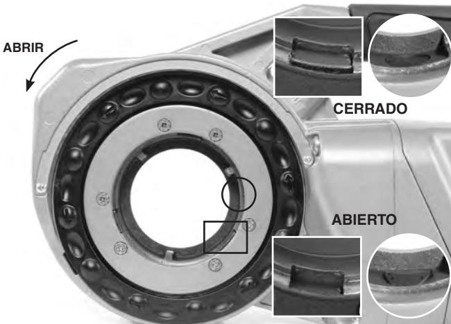
Figura 6 B – Mecanismo de retención (760 FXP 11-R)
