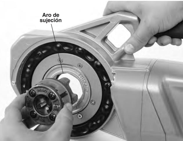
Figura 8 – Montaje de un cabezal roscador 11-R de 1 1/4" o menos (solamente 760 FXP 11-R).
