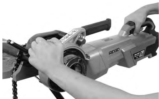
Figure 13B – Entame de filetage à l'aide du patin d'appui
