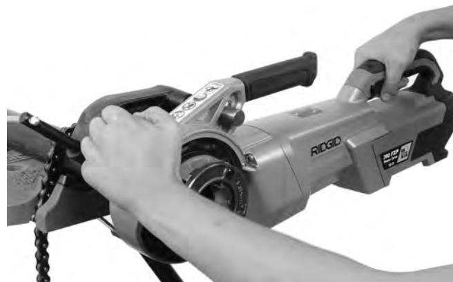
**Abbildung 13B - Gewindeschneiden mithilfe des Druckkissens starten**
