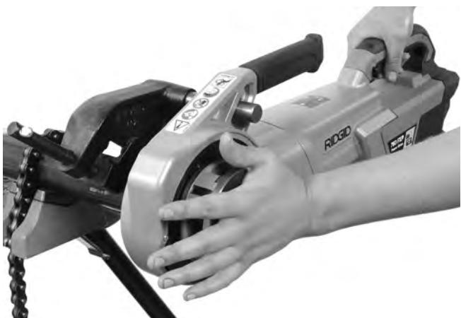
**Abbildung 13A - Gewindeschneiden mithilfe der Schneidkopfabdeckplatte starten**
