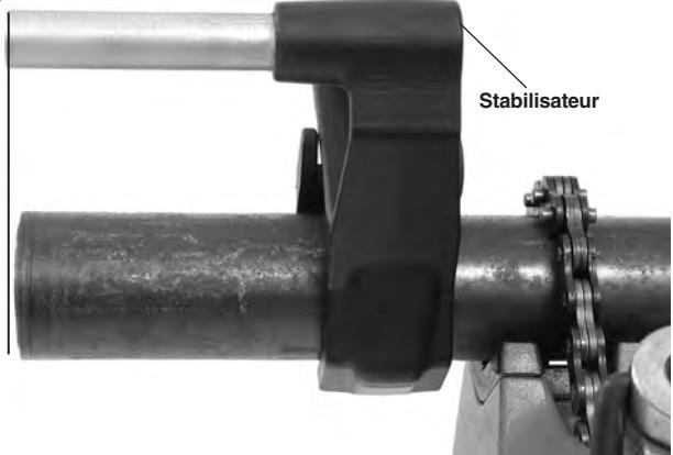
**Figure 10B – Positionnement du stabilisateur**
