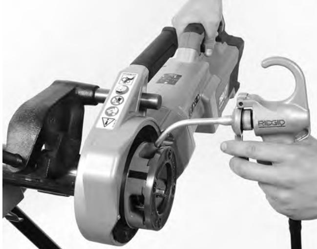
Figure 14 – Filetage du tuyau
