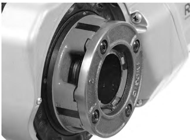
**Abbildung 15 – Rohr fluchtet mit Kante der Schneidbacken**
