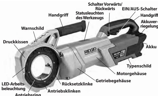
Abbildung 1 – 760 FXP Kraftantrieb
