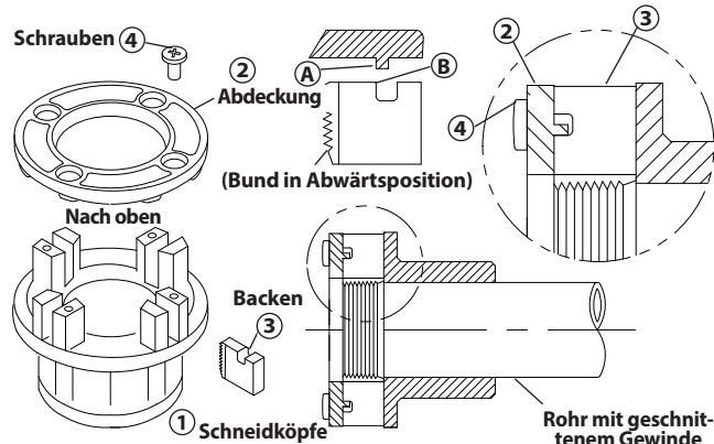
Abbildung 17 – Einsetzen der Schneidbacken in den Schneidkopf
