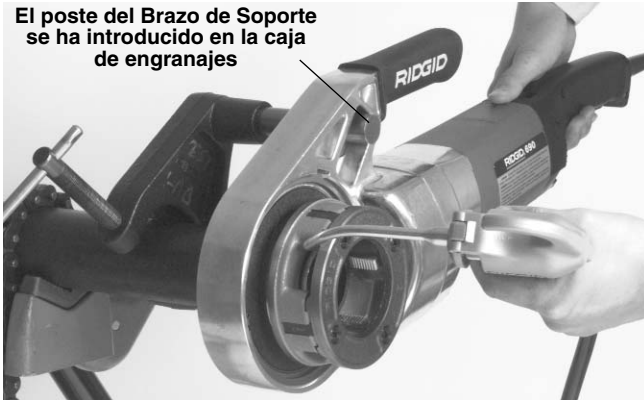
Figura 7 – Aplicación de aceite mientras se rosca
