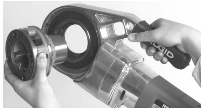
Figure 3 – Installation des têtes de filière type 11-R
