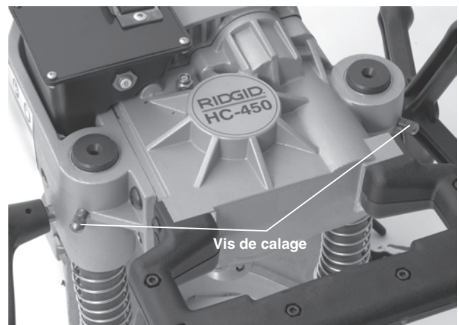
Figure 13 – Réglage des vis de calage
