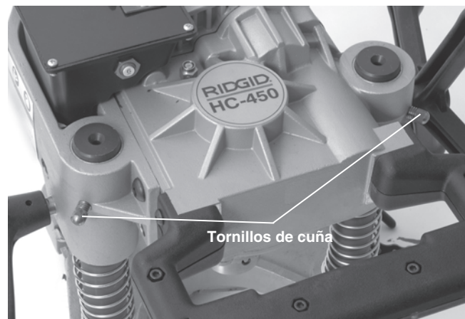
Figura 13 – Ajuste de los tornillos de cuña
