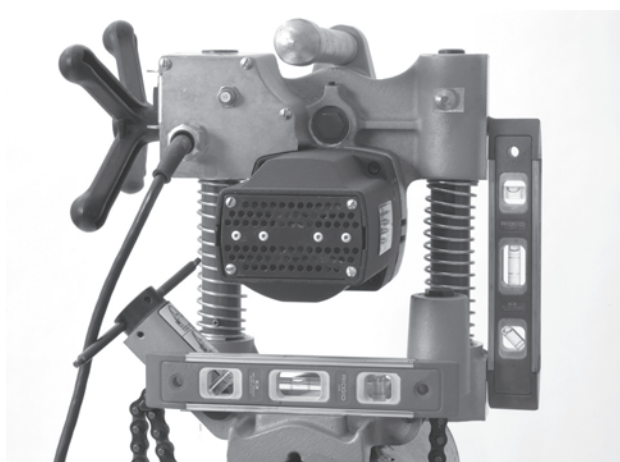
Figura 10 – Nivelación de la HC-300
