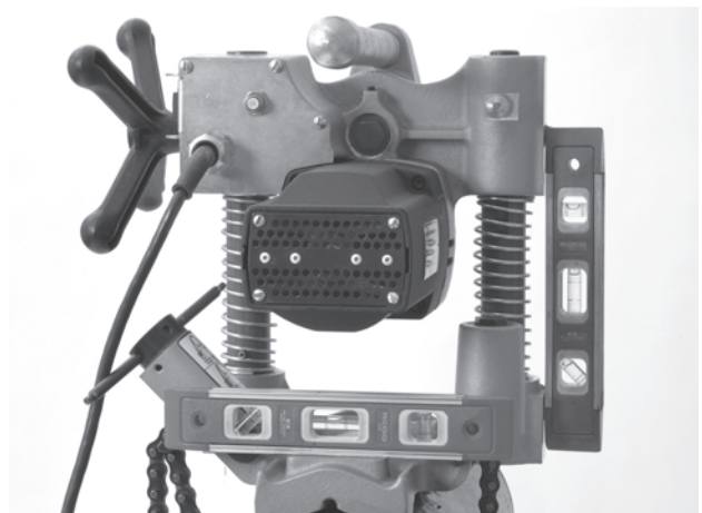
Figure 10 – Mise de niveau de la HC-300
