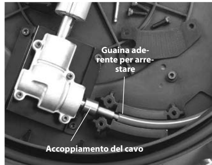
Figura 15 – Sostituzione del Gruppo del cavo
