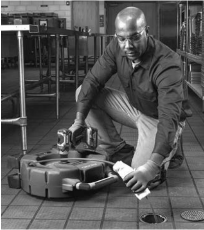
13. Ábra – Kenőanyag felvitele a kábelköpenyre
