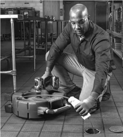
Slika 13 – Nanošenje maziva na oblogu sajle
