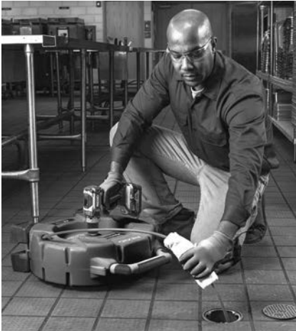
Figura 13 – Applicazioni di lubrificante nella Guaina del cavo
