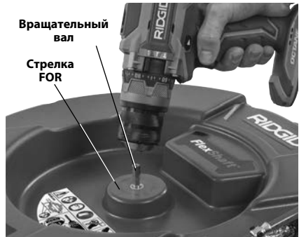
Рис. 4 - Крепление дрели к вращательному валу
