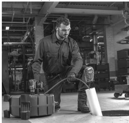
Slika 5 – Primer produženja ulaza odvoda na razmak do 3' od izlaza sajle na mašini
