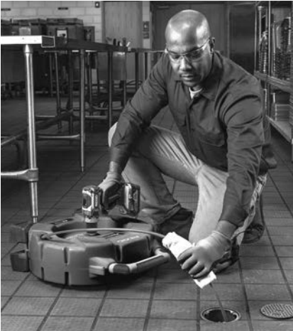
Obrázek 13 – Aplikace maziva na kabelové pouzdro
