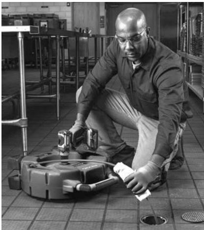
Abbildung 13 – Auftragen von Schmiermittel auf die Spiraleummantelung
