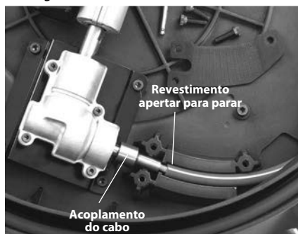
Figura 15 – Substituir o conjunto do cabo
