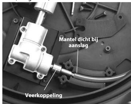
Figuur 15 – Veereenheid vervangen
