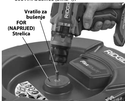
Slika 4 – Postavljanje bušilice na vratilo za bušenje
