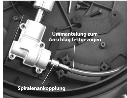
Abbildung 15 – Wechseln der Spirale
