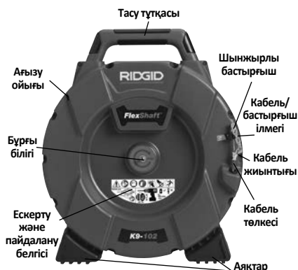
1А-сурет – RIDGID® FlexShaft ағын құбырын тазалау құрылғысы
