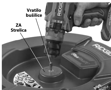
Slika 4 – Postavljanje bušilice na vrtilo
