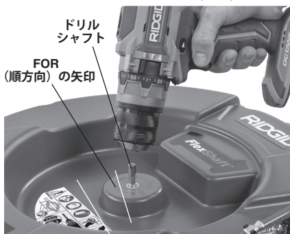
図4 - ドリルシャフトにドリルを取り付ける
