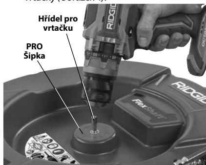
Obrázek 4 – Připojení vrtačky k hřídeli pro vrtačku
