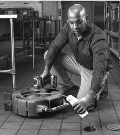
Slika 13 – Nanošenje maziva na izolaciju sajle
