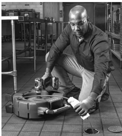
Figur 13 – Applicera smörjmedel på spiralhöljet
