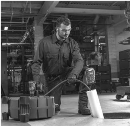
Kuva 5 – Esimerkki viemäriaukon pidentämisestä 3' päähän koneen jousiaukko
