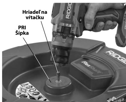
Obrázok 4 – Pripevnenie vrtačky k hriadeľu na vrtačku
