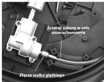
Rysunek 15 – Wymiana zespołu wałka giętkiego
