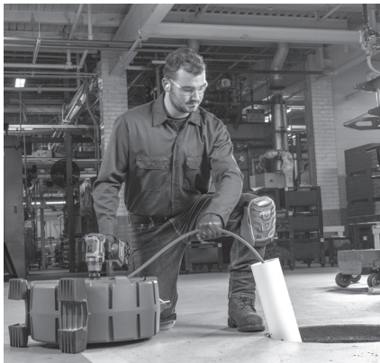
그림 5 - 머신 케이블 콘센트의 3' 이내로 드레인 접근부 연장예
