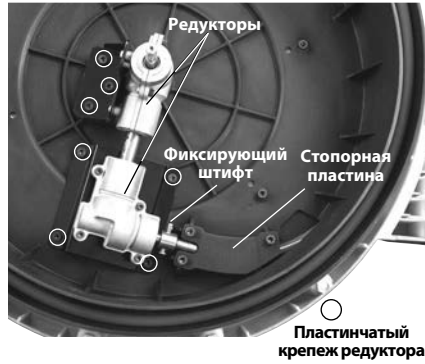
Рис. 14 - Корпус машины для прочистки канализации открыт
