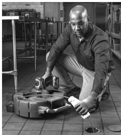
Figuur 13 – Smeermiddel aanbrengen op de veermantel
