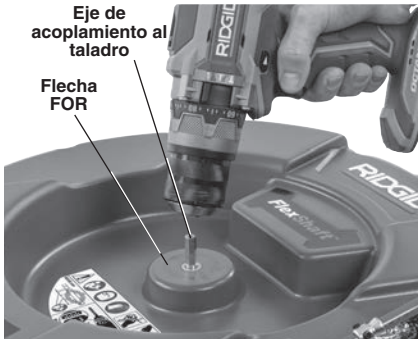
Figura 4 – Conexión del taladro al eje de acoplamiento
