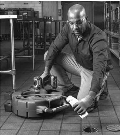
Obrázok 13 – Nanášanie maziva na plášť kábla
