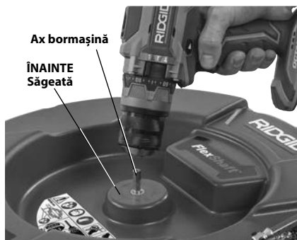
Figura 4 – fixarea bormașinii pe axul acesteia
