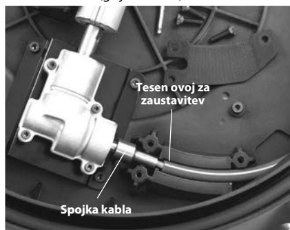
Slika 15 - Zamenjava sklopa kabla
