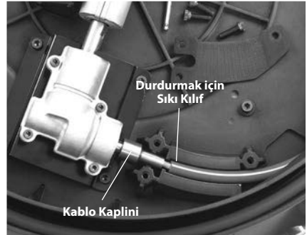
Şekil 15 – Kablo Grubunun Değiştirilmesi
