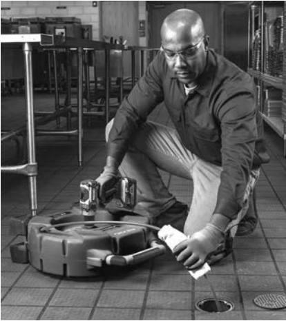
Figur 13 - Påføring av smøremiddel på kabelmantelen
