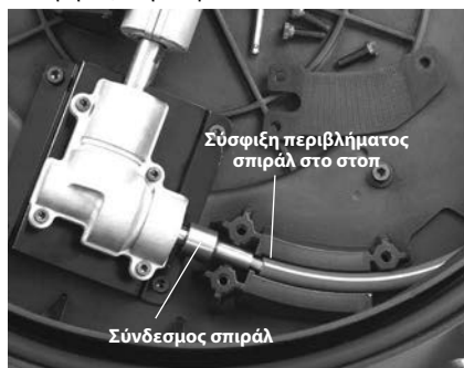
Εικόνα 15 – Αλλαγή του συγκροτήματος σπράλ
