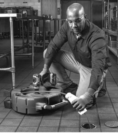
Şekil 13 – Kablo Kılıfına Yağlama Maddesi Uygulama
