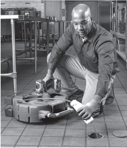
그림 13 - 윤활유를 케이블 피복에 도포
