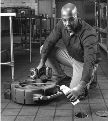
Figur 13 – Påføring af smøremiddel på spiralkappen
