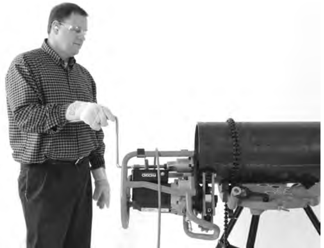
Figure 20B – Biseautage en cours (pièce fixe/machine mobile)
