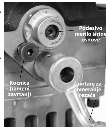
Slika 18 – Podešavanje podesivog merila širine osnove
