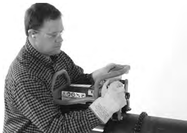
Figur 17A – Tilspænding af spændeskruen med håndkraft
