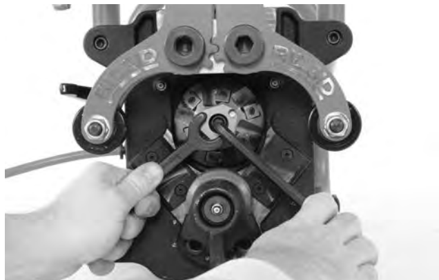
25A ábra – A vágófejek cseréje
