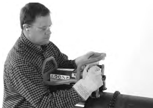
17A ábra – A befogócsavar megszorítása kézzel
