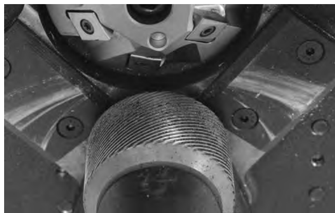
Obrázek 22 – Vyčistěte rýhování hnacího válce
