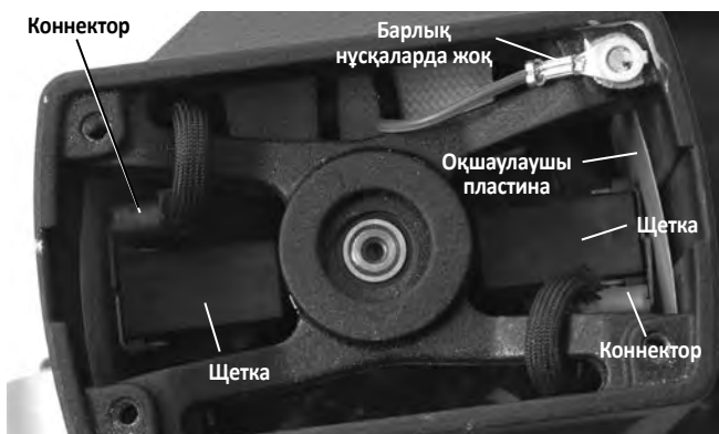
26-сурет – Щетканы орналастыру - Қозғалтқыш қақпағы алынды
