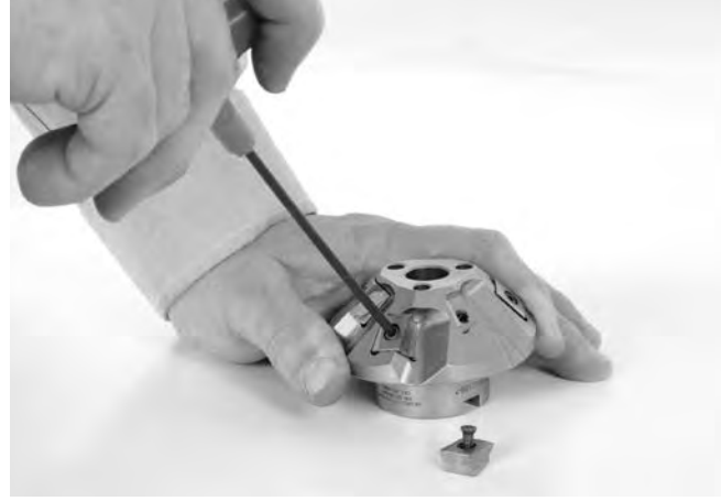
Şekil 24 – Kesici Bagaların Değiştirilmesi
