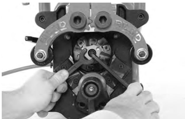
Figur 25A – Skift af skærehoveder
