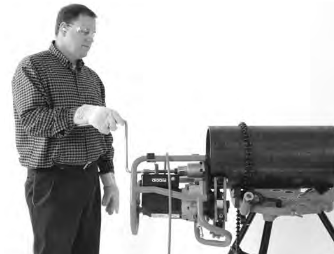
Figur 20B – Affasningsproces (fast arbejdsemne/bevægeligt affasningsværktøj)
