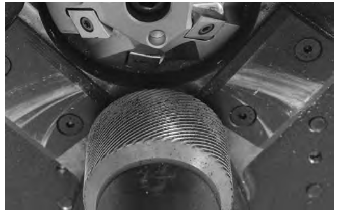
Şekil 22– Tahrik Silindiri Dişlisini Temizleme
