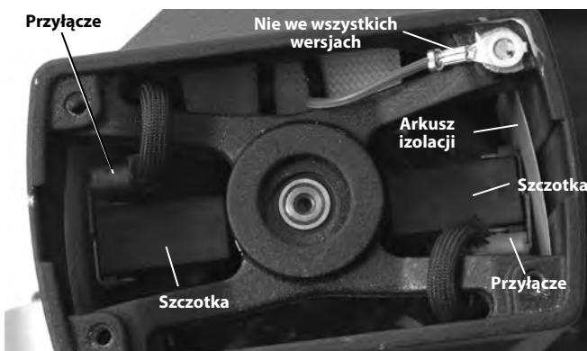
Rys. 26 – Umieszczenie szczotek - zdjęta pokrywa silnika
