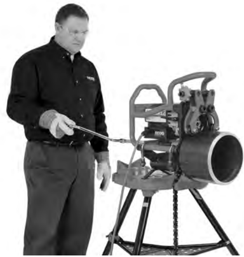
Figura 20C – Operación de biselado (biseladora fija/tubo en rotación)
