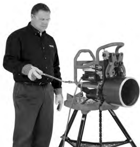
Figura 20C – Operazione di smussatura (Smussatrice fissa/Tubo ruotante)
