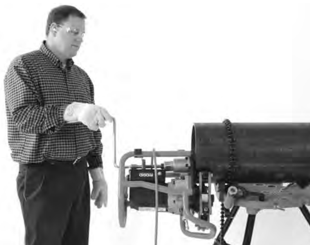
Obrázok 20B – Úkosovanie (uchytený obrobok / pohybujúca sa úkosovačka)
