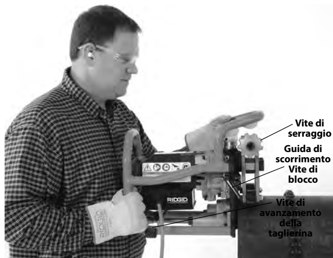
Figura 15A – Collocamento della Smussatrice sul Tubo
