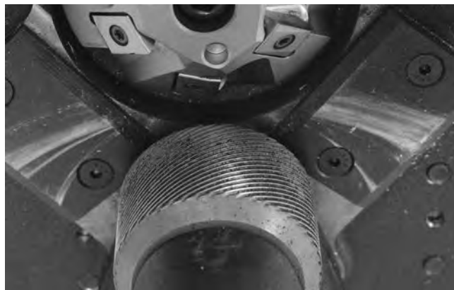
Rys. 22 – Czyszczenie radełek rolki posuwu
