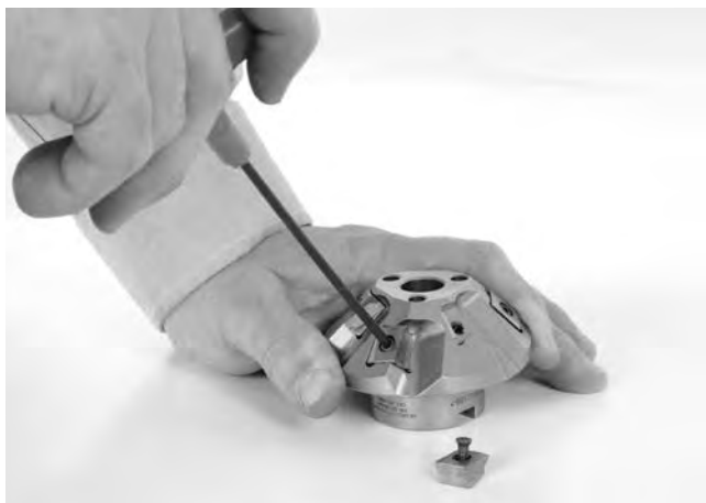
Slika 24 – Zamenjava rezalnih vstavkov
