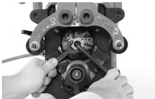
Obrázok 25A – Výmena rezných hlav
