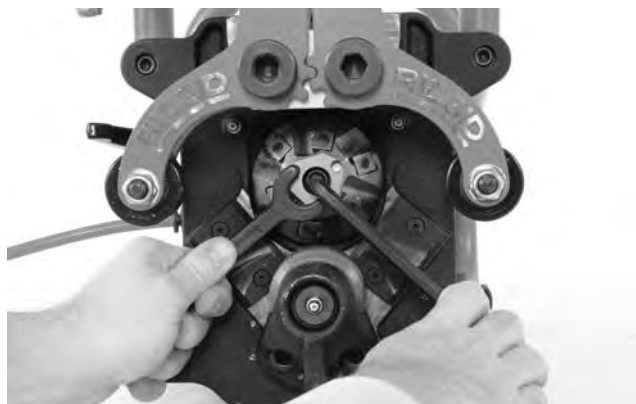
Slika 25A – Menjanje rezne glave
