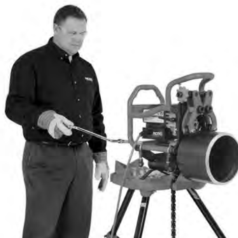
Rys. 20C – Czynność ukosowania (nieruchoma ukosowarka/obracająca się rura)
