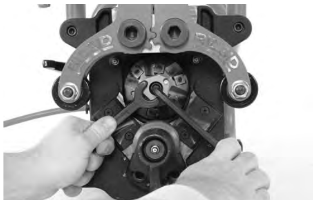
Slika 25A – Zamjena rezne glave
