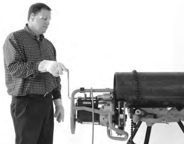
Obrázek 20B – Postup úkosování (fixní opracovávaný kus/pohyblivá úkosovačka)
