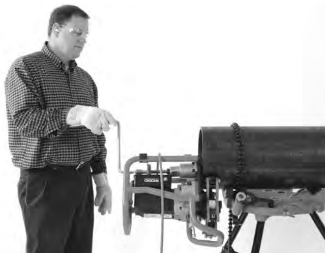
Figuur 20B – Afschuinen (Vastgezet werkstuk/Bewegend afschuinapparaat)
