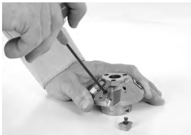
Figur 24 – Udskiftning af skæreindsatser
