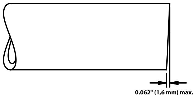
Figuur 5 – Rechtheidstolerantie van de pijp
