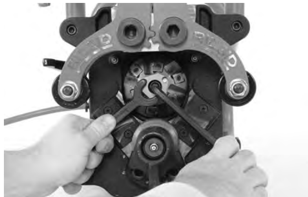
25A-сурет – Кескіштің бас тиектерін өзгерту
