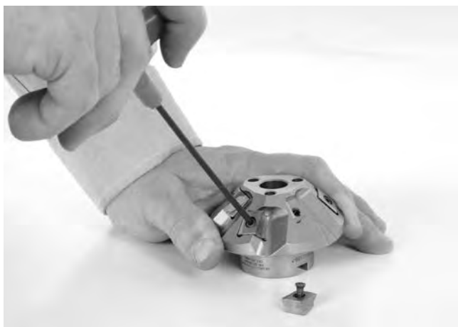
Рис. 24 – Замена вставных резцов
