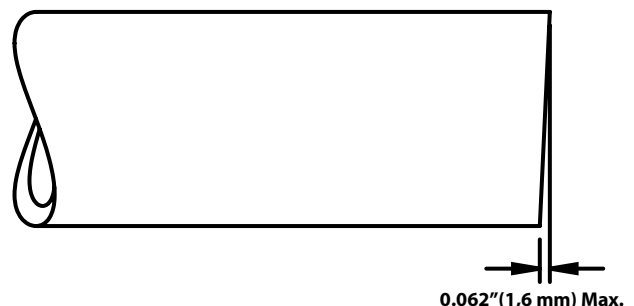
Abbildung 5 – Anforderungen hinsichtlich der Rechtwinkligkeit von Rohren
