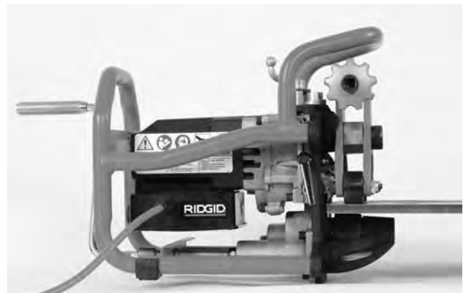
Figur 16B – Montera avfasaren på plåten
