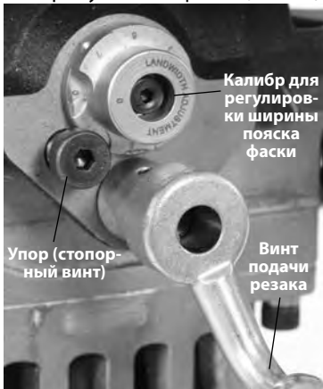
Рис. 18 – Установка калибра для регулировки ширины пояска фаски
