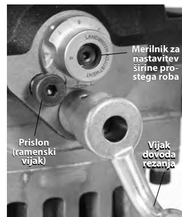
Slika 18 – Nastavitev merila širine prostega roba
