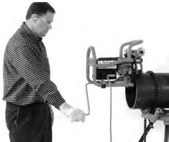
Rys. 19 – Właściwa postawa robocza
