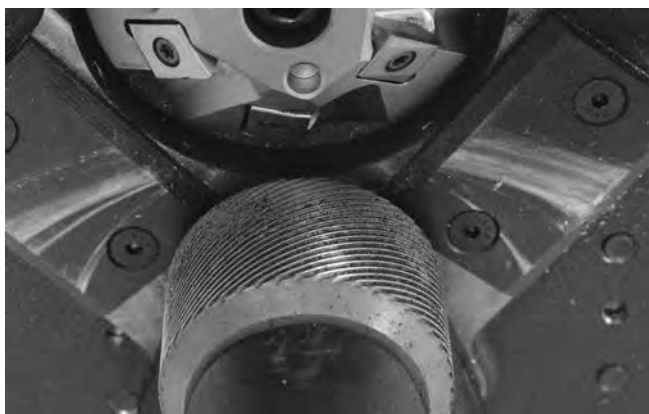
Рис. 22 – Чистые насечки ведущего ролика
