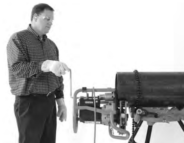
Figura 20B – Operazione di smussatura (Pezzo in lavorazione fisso/Smussatrice mobile)
