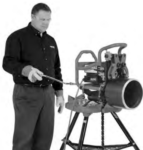
Figura 20C – Operação de Biselagem (Biselador Fixo/Tubo Rotativo)
