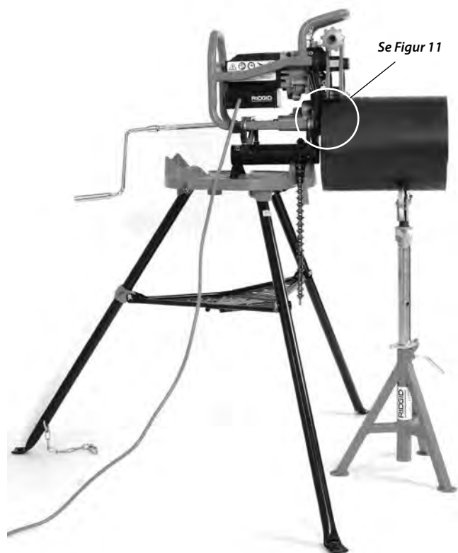
Figur 12 – Fast affasningsværktøj, kort rør, en rørstøtte
