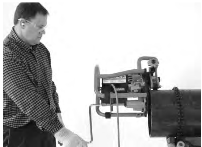
Figura 20A – Operação de Biselagem (Peça de Trabalho Fixa/Biselador em Movimento)
