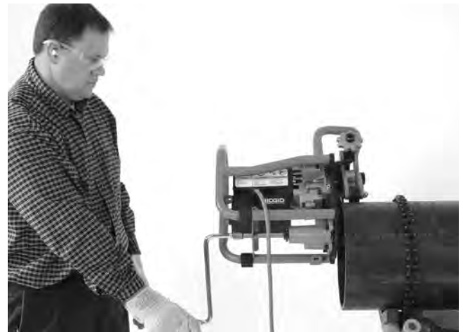
Figuur 20A – Afschuiven (Vastgezet werkstuk/Bewegend afschuinapparaat)
