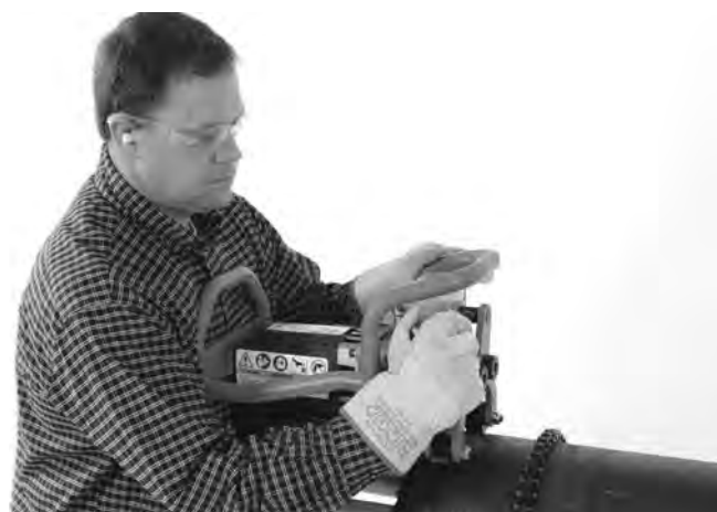
Slika 17A – Rukom zategnite stezni zavrtnj
