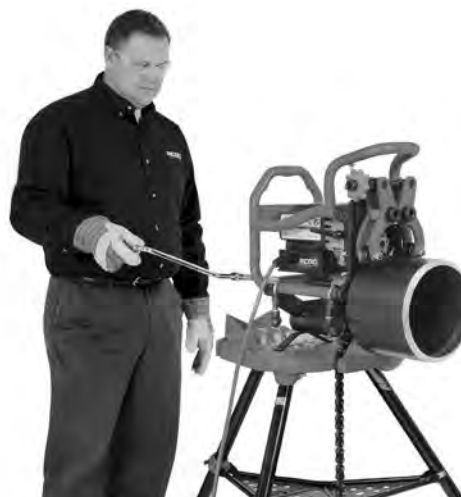
Obrázek 20C – Postup úkosování (fixní úkosovačka/otáčející se trubka)
