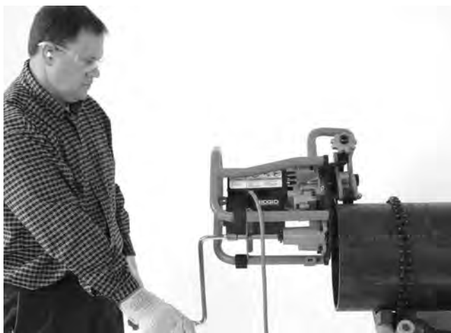
Figur 20A – Avfasningsfunktion (fast arbetsstycke/rörlig avfasare)
