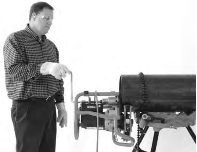
Kuva 20B – Viistäminen (kiinteä työkappale/liikkuva viisteleikkuri)
