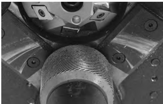
Figur 22 – Rengøring af drivrulleriflanger
