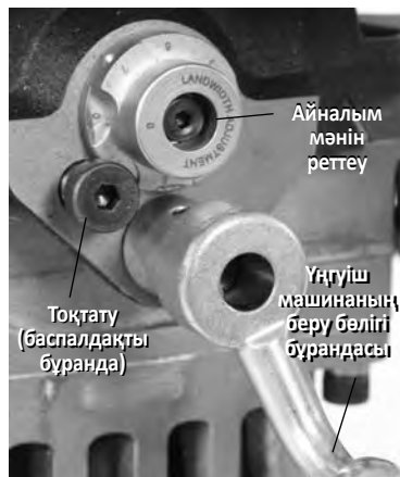
18-сурет – Айналым мәнін реттеудің өлшеуіш параметрі
