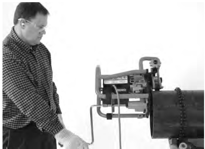
Figur 20A – Affasningsproces (fast arbejdsemne/bevægeligt affasningsværktøj)
