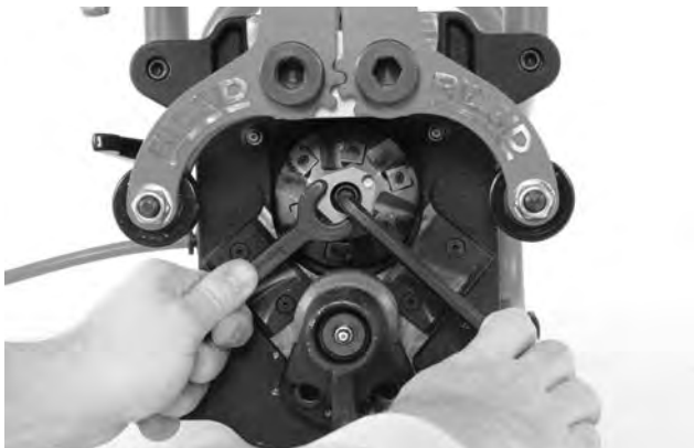
Εικόνα 25A – Αλλαγή κοπτικών κεφαλών
