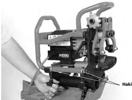
Rys. 9 – Mocowanie ukosowarki w adapterze
