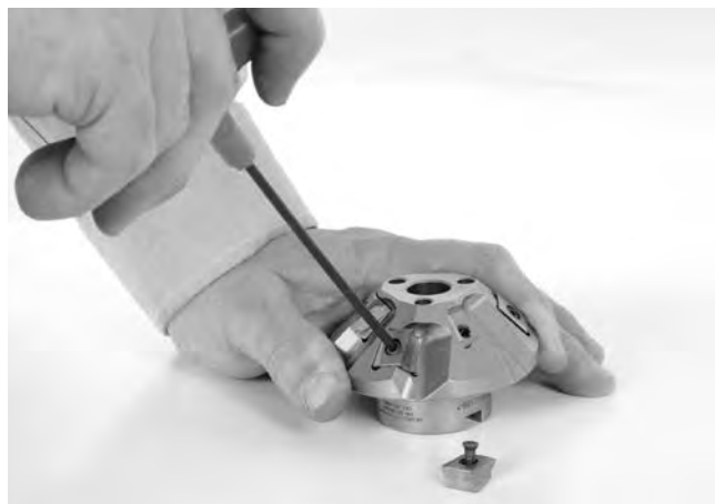
Obrázek 24 – Výměna řezacích vložek
