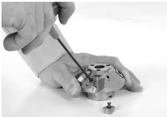
Obrázok 24 – Výmena rezných vložiek
