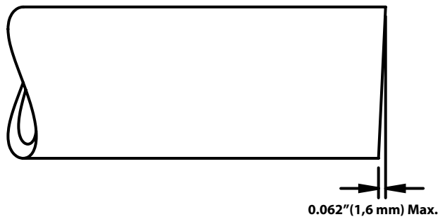
Figur 5 – Krav på rörets vinkelräthet
