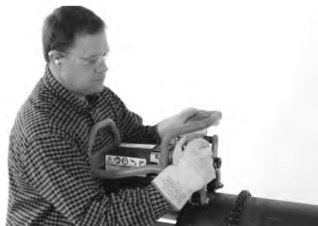
Obrázok 17A – Ručne utiahnite sťahovaciu skrutku
