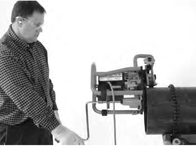
Şekil 20A – Pahlama İşlemi (Sabit İş Parçası/Hareketli Pahlama Makinesi) Pahlama İşlemi
