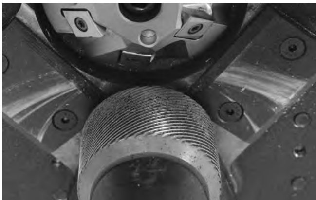
Figura 22 – Limpar Rolos de Estriagem
