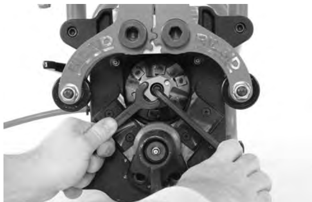
Obrázek 25A – Výměna řezacích hlav
