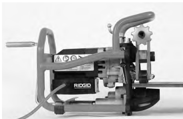
Obrázek 16B – Umístění úkosovačky na plech
