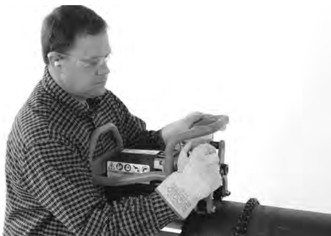
Figur 17A – Stram klemmeskruen til for hånd
