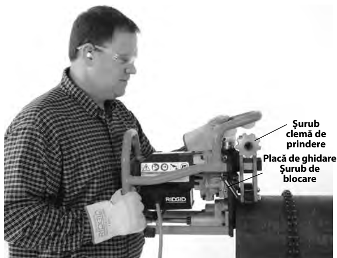
Figura 15A – Așezarea mașinii de șanfrenare pe țevă
