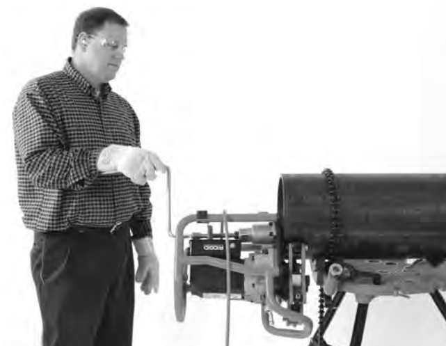
20B ábra – Leélezési művelet (Fix munkadarab/Mozgó leélezőgép)
