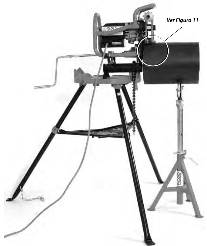
Figura 12 – Biselador Fixo, Tubo Curto, Um Suporte de Tubo
