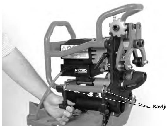
Slika 9 – Pritrjevanje posnemovalca robov na adapter
