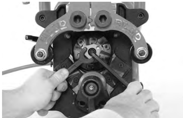
Figur 25A – Vända skärhuvuden
