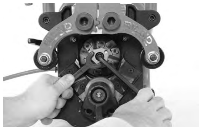
Figura 25A – Schimbarea capetelor cuțitelor
