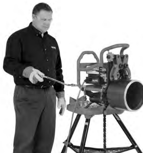
Slika 20C – Obrada ruba cijevi (Fiksirani alat/pomični radni dio)
