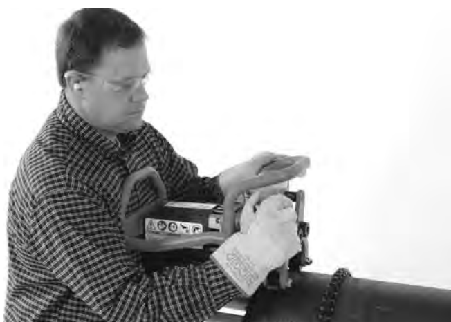
Slika 17A – Rukom zategnite stezni vijak
