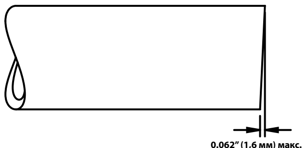
Рис. 5 – Требования к перпендикулярности торца трубы
