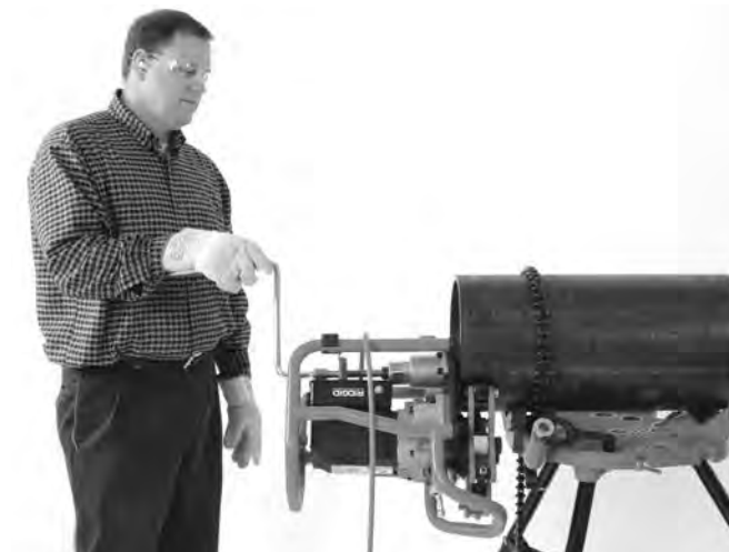
Slika 20B – Operacija obaranja ivica (fiksirani radni komad/pokretni alat za obaranje ivica)
