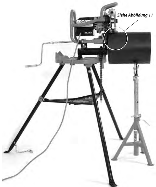
Abbildung 12 – Fixiertes Anfasergerät, kurzes Rohr, ein Rohrstände
