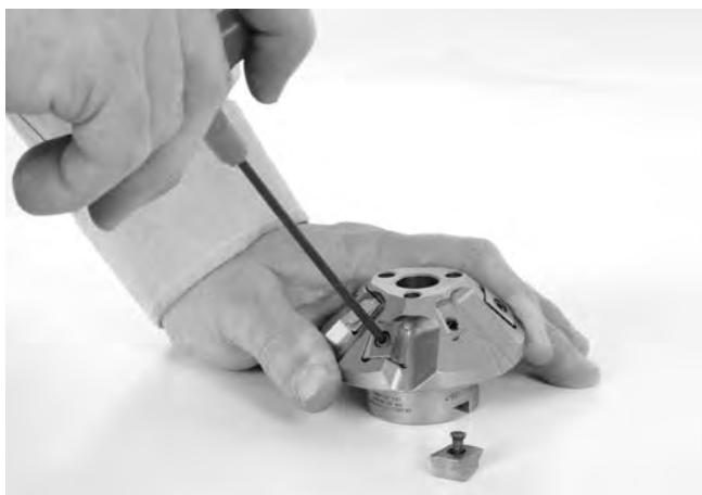
Slika 24 – Zamena reznih umetaka
