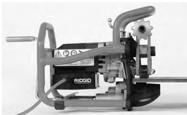
Figur 16B – Påmontering af affasningsværktøjet på en plade
