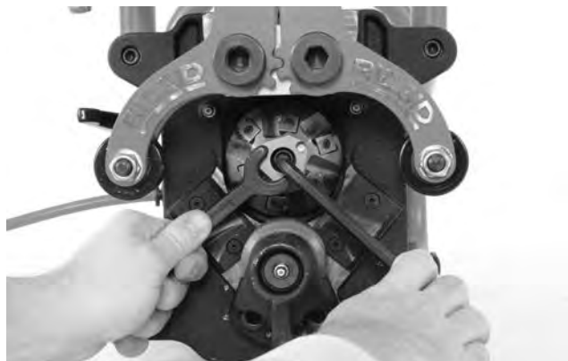
Slika 25A – Zamenjava rezalne glave
