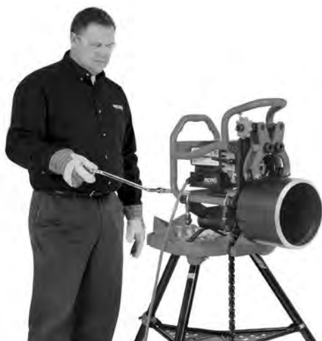
Slika 20C – Posnemanje robov (fiksni posnemovalca robov/vrteča cev)
