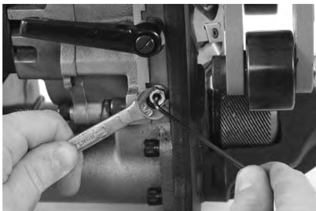
Figura 27 – Regolazione della Piastra della guida di scorrimento
