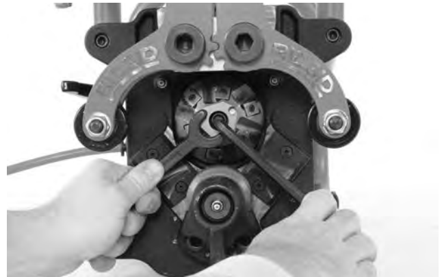
Rys. 25A – Zmiana głowic tnących
