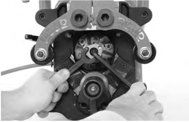
Şekil 25A – Kesici Başlıkların Değiştirilmesi
