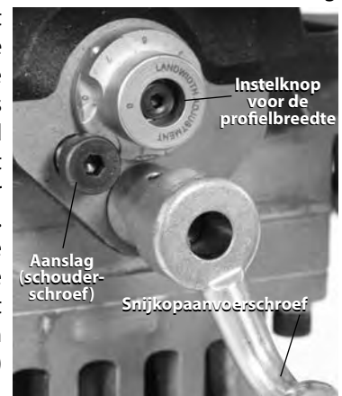
Figuur 18 – Instellen van de instelknop voor de profielbreedte
