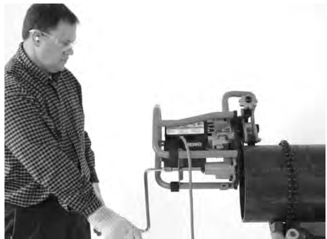
Figura 20A – Operația de șanfrenare (Piesă de prelucrat fixă / Mașină de șanfrenare mobilă)
