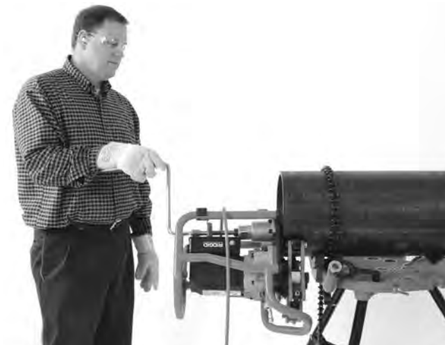
Slika 20B – Posnemanje robov (fiksni obdelovanec/ premični posnemovalec robov)
