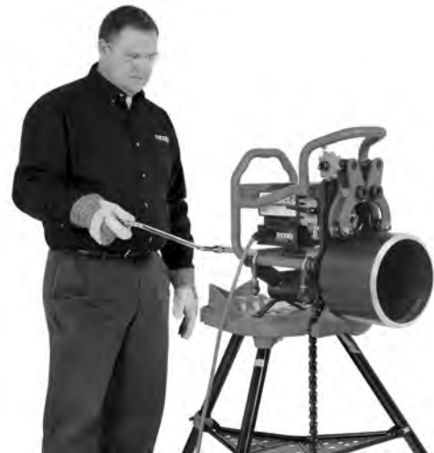
Figure 20C – Biseautage en cours (machine fixe/tuyau mobile)
