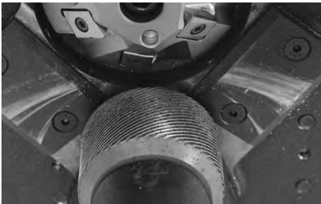
22. ábra – A hajtógörgő recézésének megtisztítása
