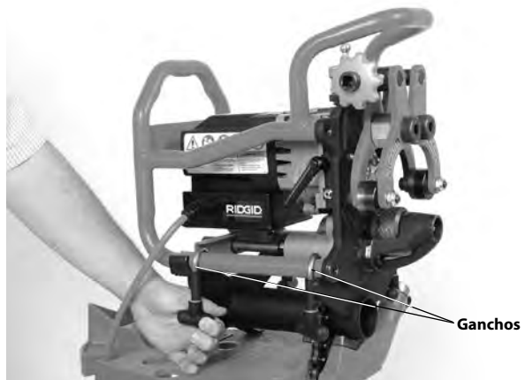
Figura 9 – Fixar o Biselador ao Adaptador
