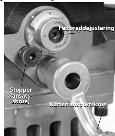
Figur 18 – Innstilling av feltbreddejusteringsmåler
