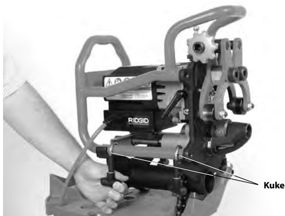
Slika 9 – Učvršćivanje alata na prilagodnik
