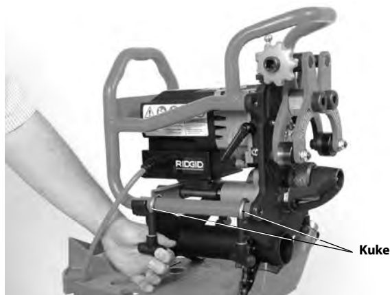
Slika 9 – Pričvršćivanje alata za obaranje ivica za adapter
