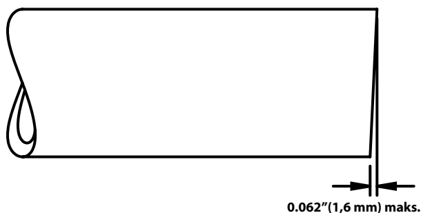
Figur 5 – Krav til rørets rettinklethet
