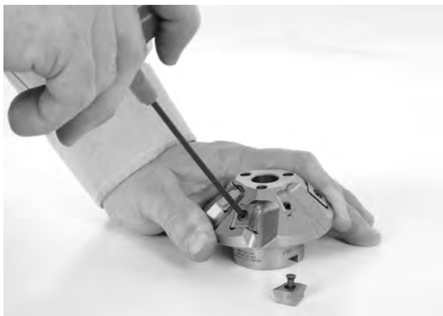
Slika 24 – Zamjena reznih umetaka
