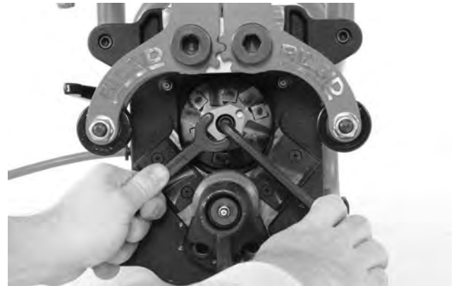
Figura 25A – Substituir as Cabeças do Cortador
