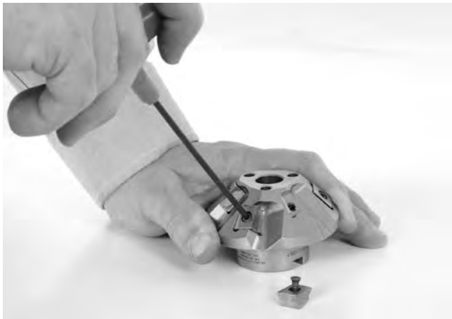
Figura 24 – Substituir Entalhes de Corte
