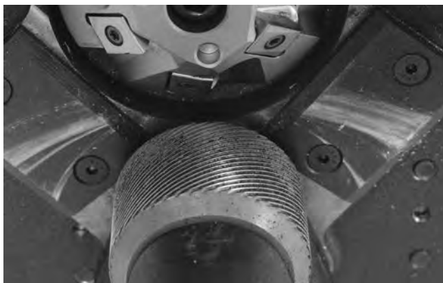
Abbildung 22 – Reinigen der Rändelung der Antriebsrolle
