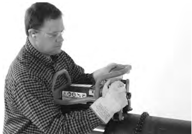
Figuur 17A – Klemmschroef met de hand vastdraaien
