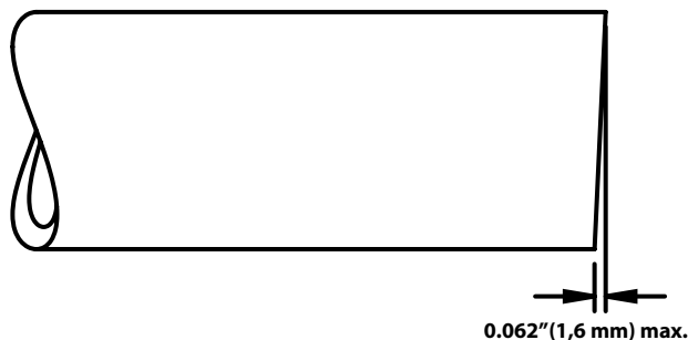
Obrázok 5 – Požiadavky na pravouhlosť rúrky
