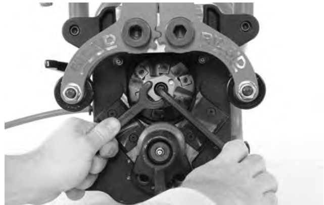
Abbildung 25A – Wechseln von Schneidköpfen
