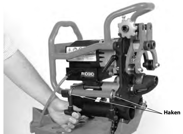
Figuur 9 – Het afschuinapparaat vastzetten op de adapter
