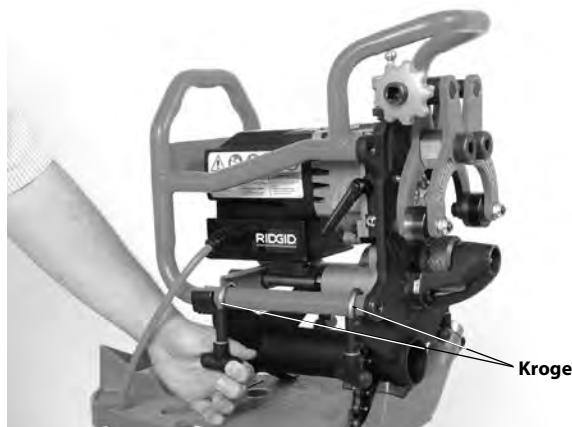
Figur 9 – Fastgørelse af affasningsværktøjet på adapteren
