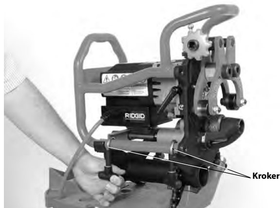
Figur 9 – Feste fasemaskinen til adapteren
