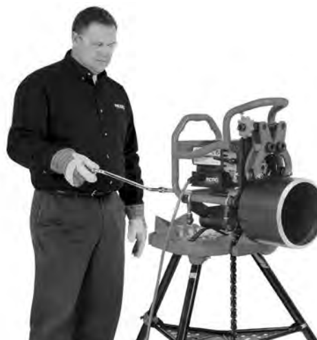
Figur 20C – Avfasningsfunktion (fast avfasare/roterande rör)
