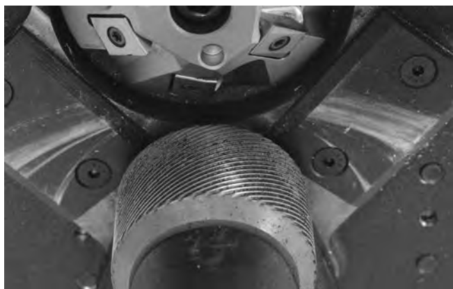
Εικόνα 22 – Καθαρίστε τις ραβδώσεις του κυλίνδρου μετάδοσης κίνησης
