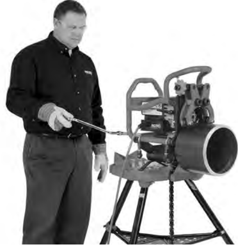
Şekil 20C – Pahlama İşlemi (Sabit Pahlama Makinesi/ Dönen Boru)
