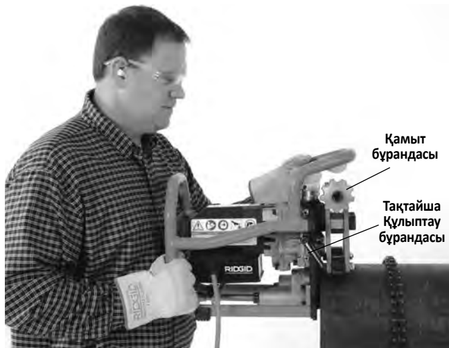
15A-суреті – Қиғаш кесу құралын құбырға орналастыру
