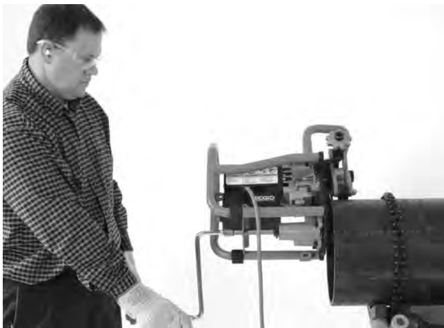
Figur 20A – Utfasing (Fast arbeidsemne / Bevegelig fasemaskin)
