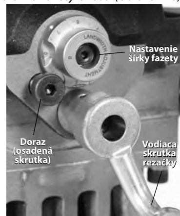
Obrázok 18 – Nastavenie nastavovacej šablóny pre šírku fazety
