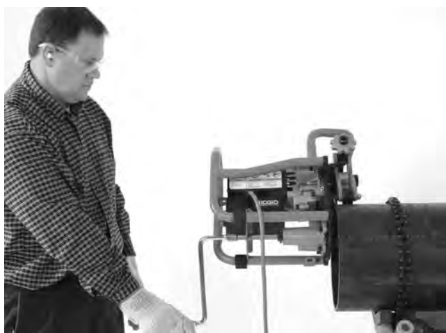
20A ábra – Leélezési művelet (Fix munkadarab/Mozgó leélezőgép)
