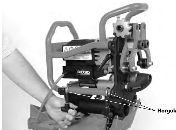
9. ábra – A leélező gép rögzítése az adapterre
