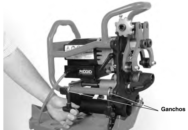
Figura 9 – Conexión de la biseladora con el adaptador
