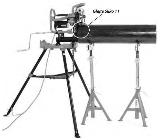
Slika 13 – Fiksni posnemovalec robov, dolga cev, stojala za več cevi
