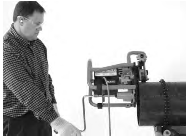
Slika 20A – Operacija obaranja ivica (fiksirani radni komad/pokretni alat za obaranje ivica)
