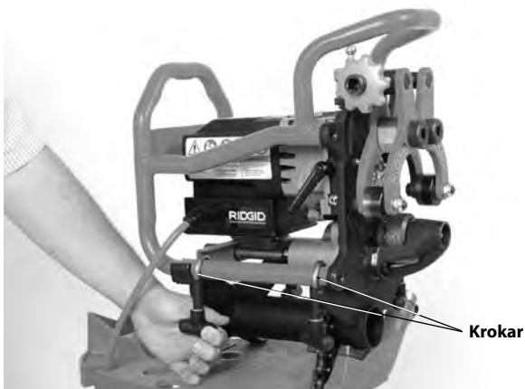
Figur 9 – Hålla fast avfasaren vid adaptern
