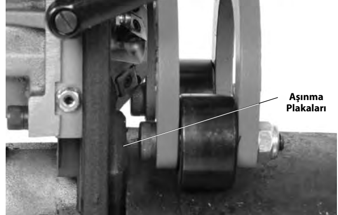
Şekil 15B – Aşınma Plakası Borunun Ucuna Yanaşır
