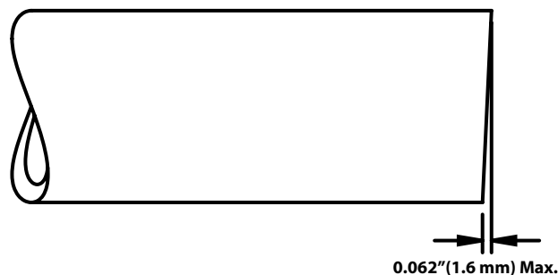
Figura 5 – Cerințe de perpendicularitate a țevii
