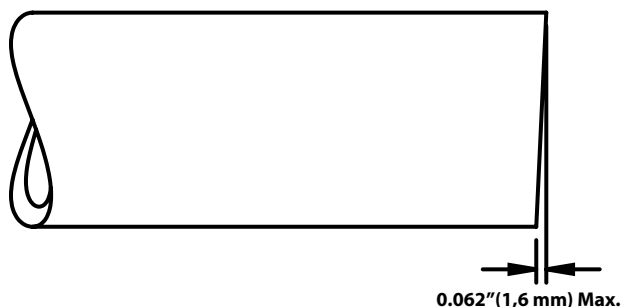
Obrázek 5 – Požadavky rovnosti trubky
