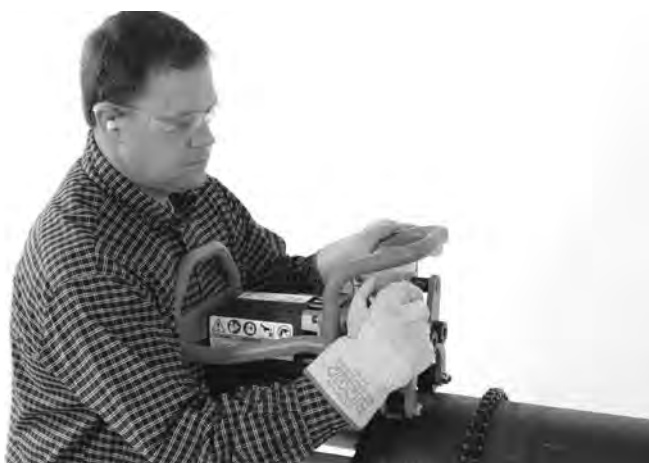
Kuva 17A – Kiristä kiristysruuvi käsin
