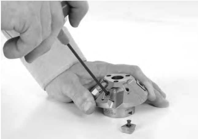
Abbildung 24 – Wechseln der Schneideinsätze
