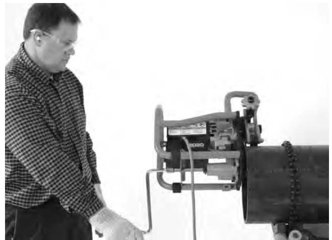
Abbildung 20A – Anfasen (fixiertes Werkstück/bewegtes Anfasgerät)
