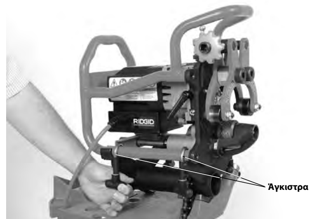
Εικόνα 9 – Τοποθέτηση του εργαλείου φρεζαρίσματος στον προσαρμογέα
