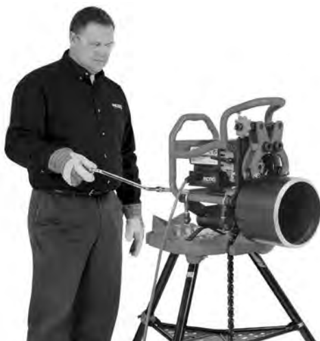
20C ábra – Leélezési művelet (Fix leélezőgép/Forgó cső)
