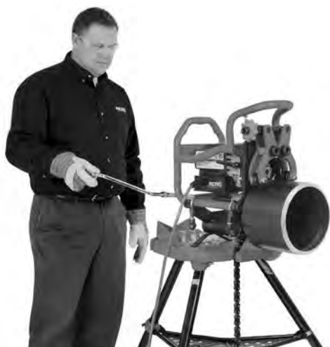
Figura 20C – Operația de șanfrenare (Mașină de șanfrenare fixă / Țeavă în rotație)
