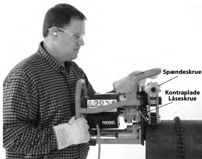
Figur 15A – Placering af affasningsværktøjet på et rør
