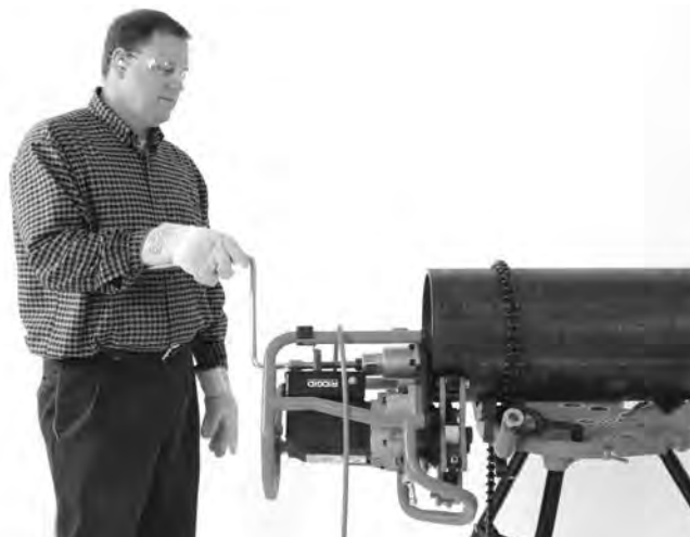
Rys. 20B – Czynność ukosowania (nieruchomy detal/ poruszająca się ukosowarka)
