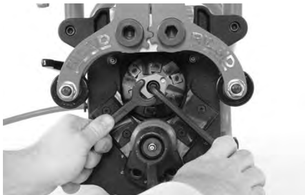
Kuva 25A – Leikkuupäiden vaihto
