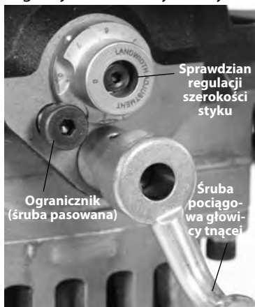
Rys. 18 – Ustawianie sprawdzianu regulacji szerokości styku
