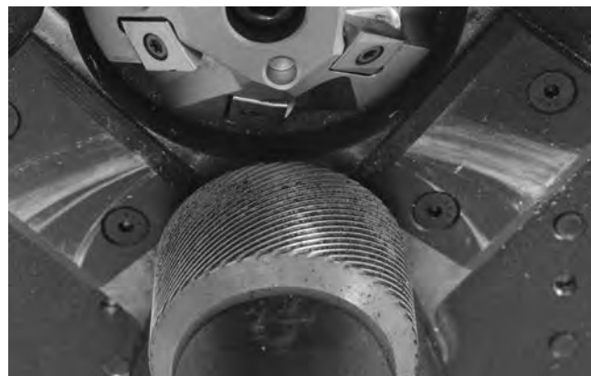
Slika 22 – Čisti utori pogonskog valjka
