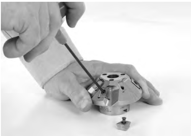
Figuur 18 – Snijkopinzetstukken vervangen
