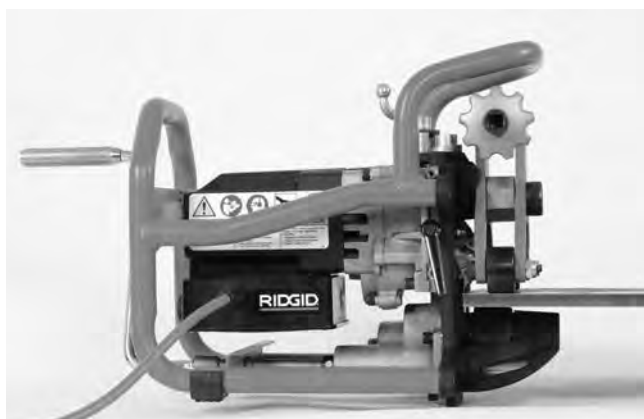
Figura 16B – Instalar o Biselador numa Placa
