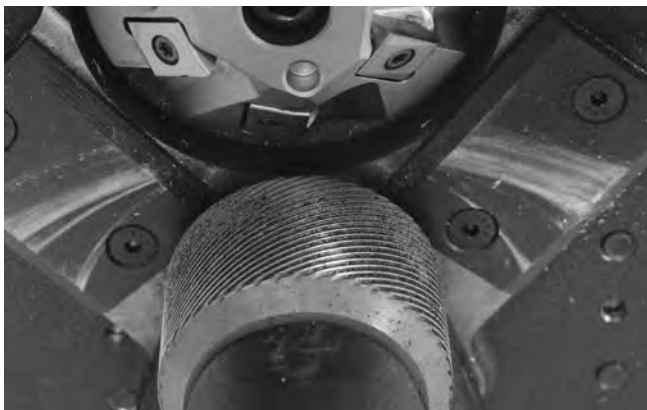
Slika 22 – Čiščenje robnic gonilnega valja
