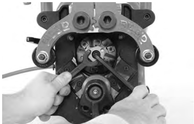
Figuur 25A – Snij kop verwisselen
