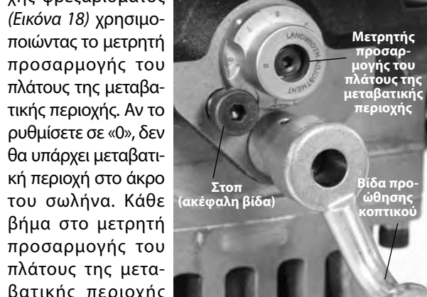
Εικόνα 18 – Ρύθμιση του μετρητή προσαρμογής του πλάτους μεταβατικής περιοχής
