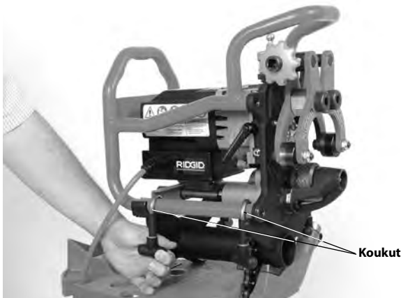
Kuva 9 – Viisteleikkurin kiinnitys adapteriin
