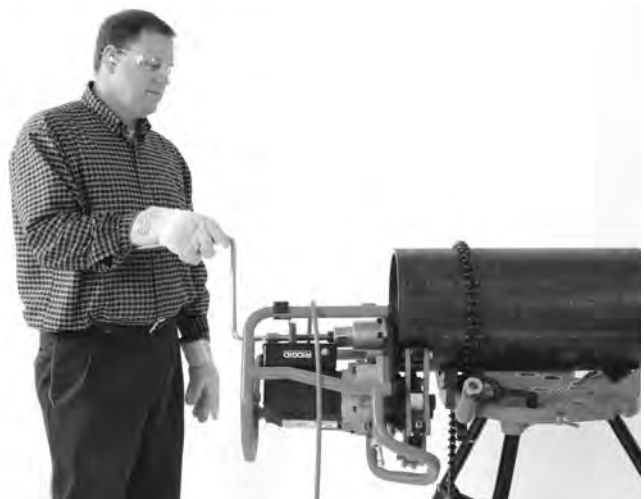
Figur 20B – fasing (Fast arbeidsemne / Bevegelig fasemaskin)
