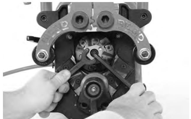
Figura 25A – Ricambio delle Teste da taglio
