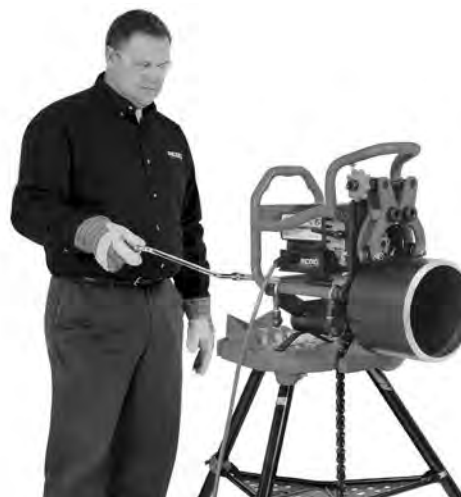
Εικόνα 20C – Λειτουργία φρεζαρίσματος (Σταθερό εργαλείο φρεζαρίσματος σωλήνων/περιστρεφόμενος σωλήνας)
