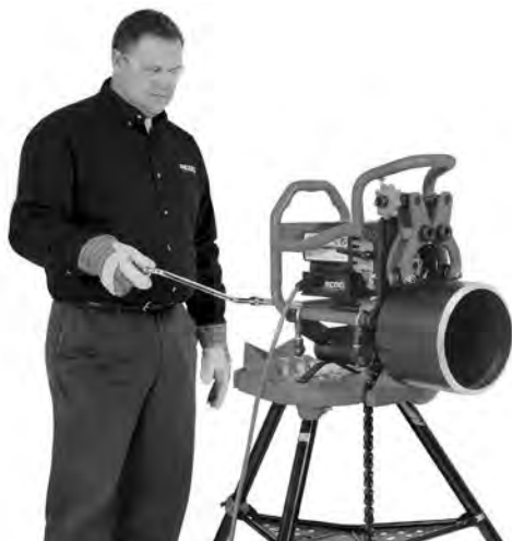
Abbildung 20C – Anfasen (fixiertes Anfasgerät/rotieren-des Rohr)
