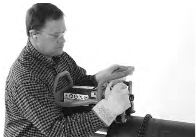
Abbildung 17A – Klemmschraube handfest anziehen
