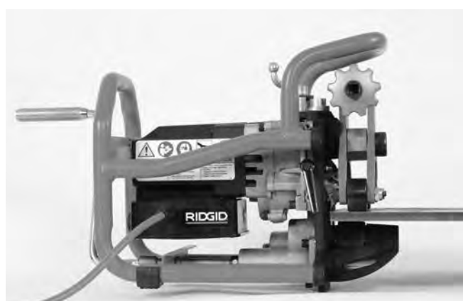
Slika 16B – Montaža alata za obaranje ivica na ploču
