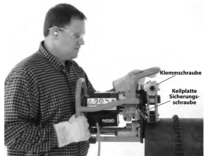
Abbildung 15A – Platzieren des Anfasgeräts am Rohr
