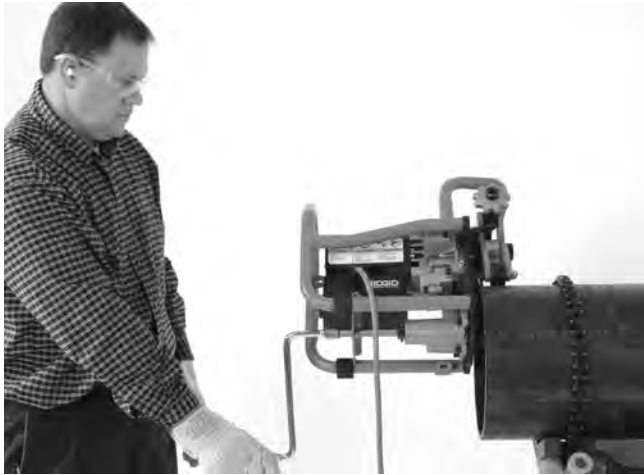
Kuva 20A – Viistäminen (kiinteä työkappale/liikkuva viisteleikkuri)
