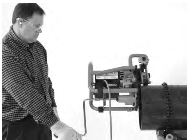
Obrázok 20A – Úkosovanie (uchytený obrobok / pohybujúca sa úkosovačka)
