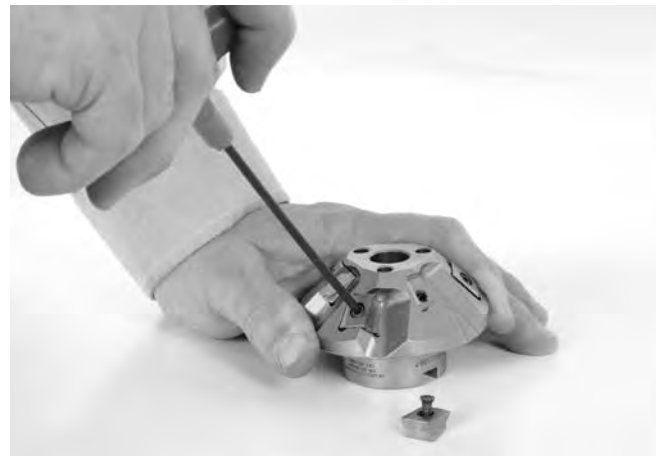
Figura 24 – Sostituzione degli Inserti della taglierina
