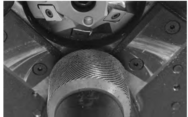
Figur 22 – Rengör drivrullens räfflor
