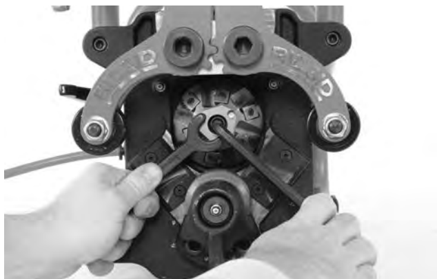
Рис. 25А – Замена режущих головок
