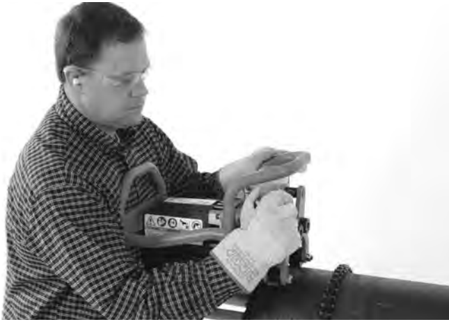
Şekil 17A – Sıkıştırma Vidasını Elle Sıkın
