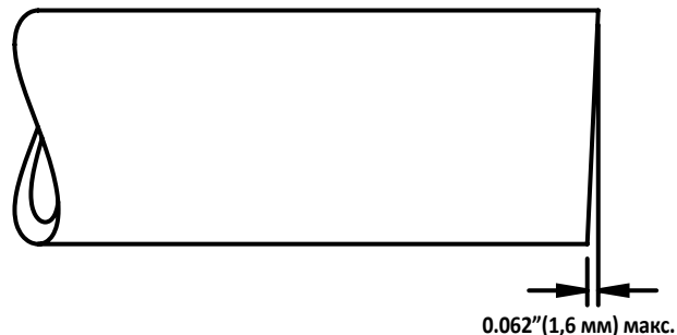
5-сурет – Құбырдың тікбұрыштық талаптары
