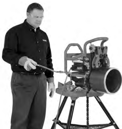
Obrázok 20C – Úkosovanie (uchytená úkosovačka / rotujúca rúrka)
