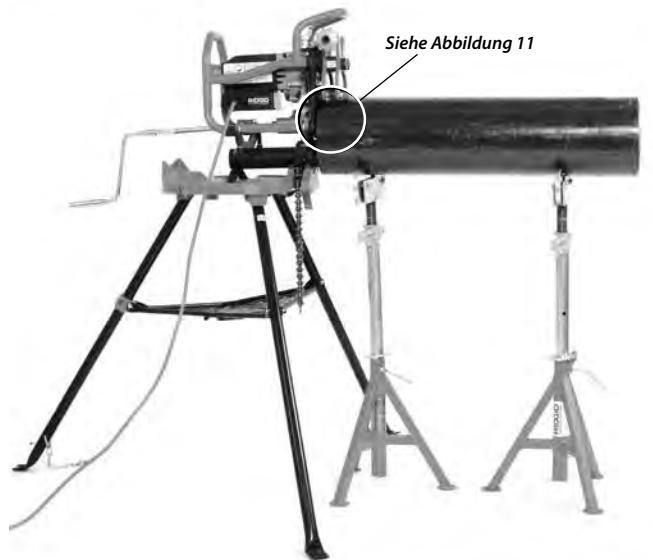
Abbildung 13 – Fixiertes Anfasergerät, langes Rohr, mehrere Rohrstände
