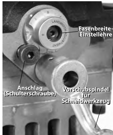
Abbildung 18 – Einstellung der Fasenbreite-Einstellehre
