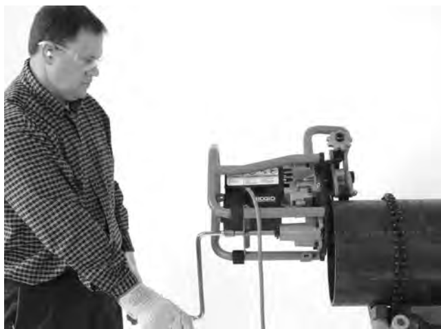
Slika 20A – Posnemanje robov (fiksni obdelovanec/ premični posnemovalec robov)
