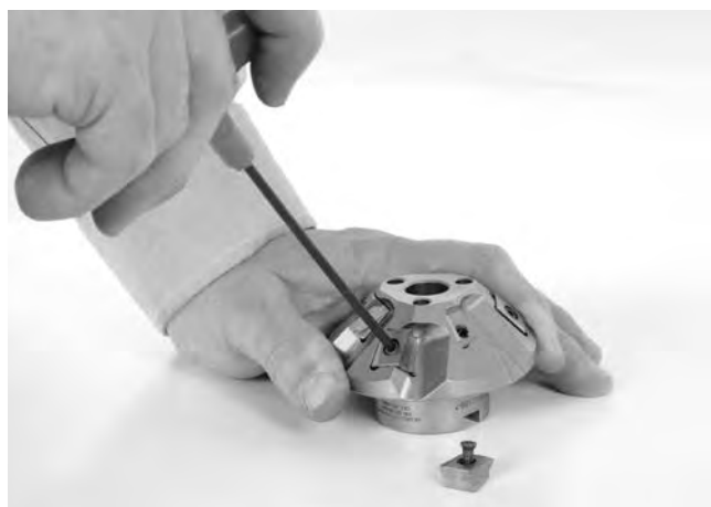
Εικόνα 24 – Αντικατάσταση κοπτικών ενθέτων
