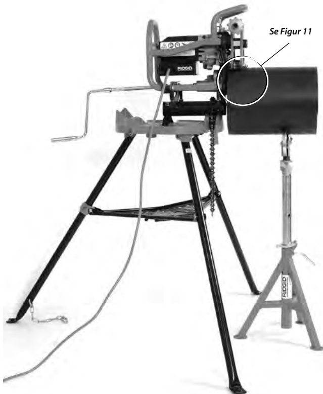
Figur 12 – Fast fasemaskin, kort rør, ett rørstativ
