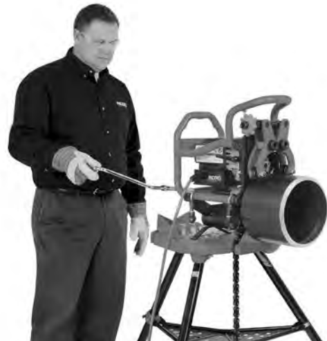
Figur 20C – Utfasing (Fast fasemaskin / Roterende rør)
