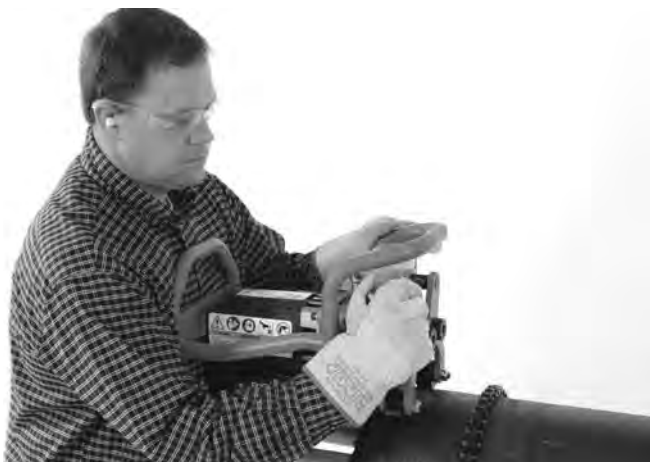
Rys. 17A – Ręczne dokręcanie śruby zaciskowej
