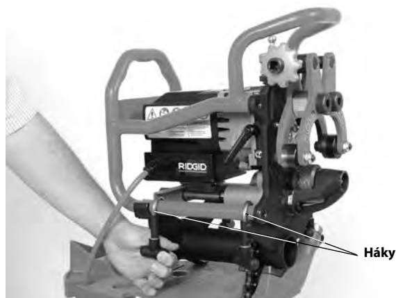
Obrázok 9 – Pripevnenie úkosovačky k adaptéru
