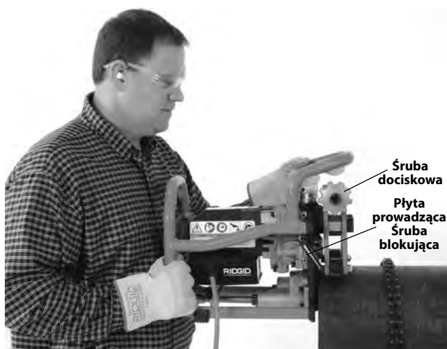
Rys. 15A – Ustawienie ukosowarki na rurze
