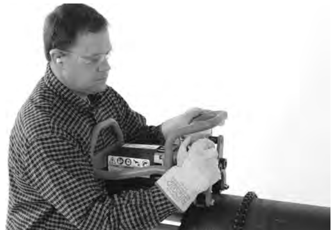
Figura 17A – Aperto Manual do Parafuso de Aperto
