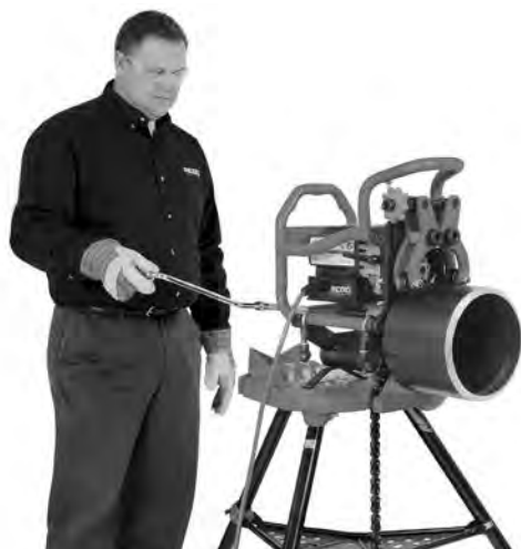
Figuur 20C – Afschuinen (Vastgezet afschuinapparaat/Roterende pijp)
