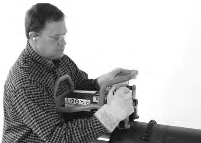
Рис. 17А – Затягивание зажимного винта от руки
