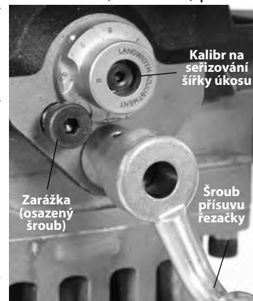
Obrázek 18 – Nastavení kalibru na seřizování šířky úkosu
