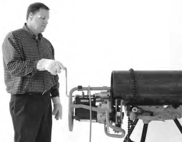
Abbildung 20B – Anfasen (fixiertes Werkstück/bewegtes Anfasgerät)
