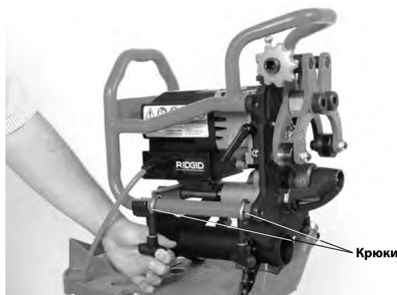
Рис. 9 – Крепление станка для снятия фаски к держателю
