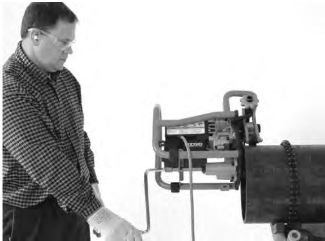
Figure 20A – Biseautage en cours (pièce fixe/machine mobile)
