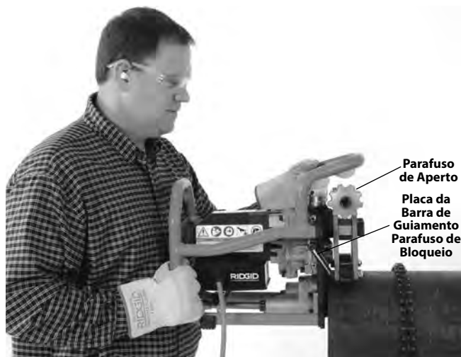
Figura 15A – Colocar o Biselador no Tubo
