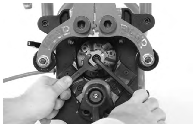
Figura 25A – Cambio del cabezal cortador
