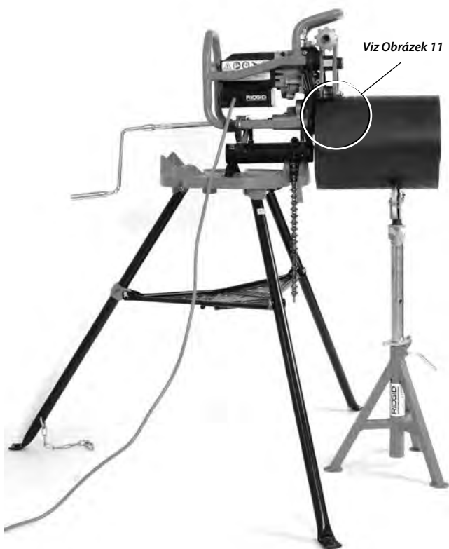
Obrázek 12 – Fixní úkosovačka, krátká trubka, jeden stojan na trubky
