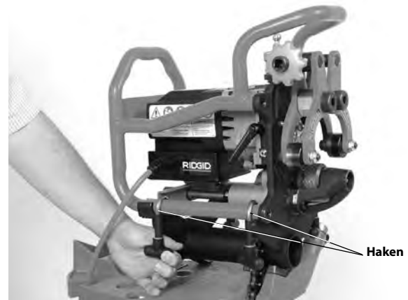
Abbildung 9 – Sichern des Anfasgerätes am Adapter
