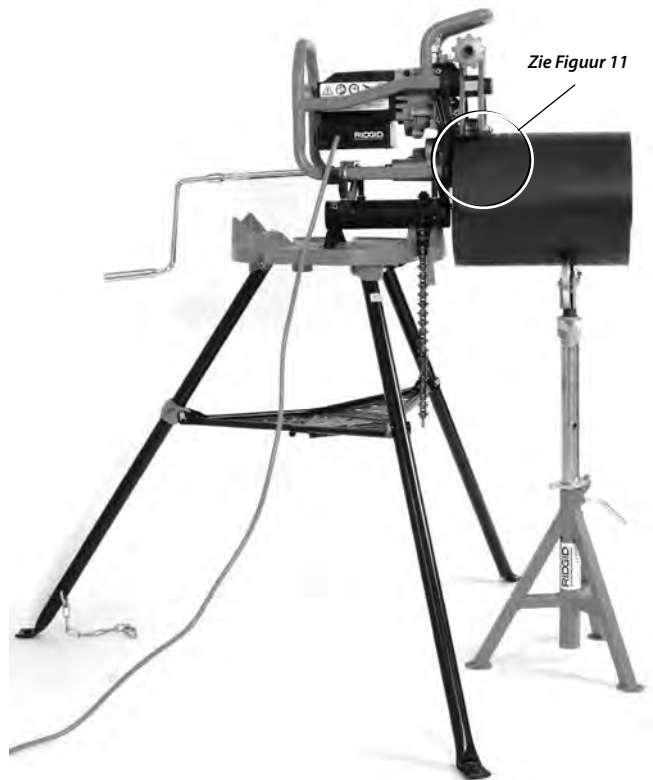
Figuur 12 – Vastgezet afschuinapparaat, korte pijp, één pijpsteun
