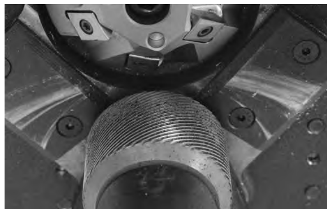
Kuva 22 – Puhdista syöttörullan pykälät
