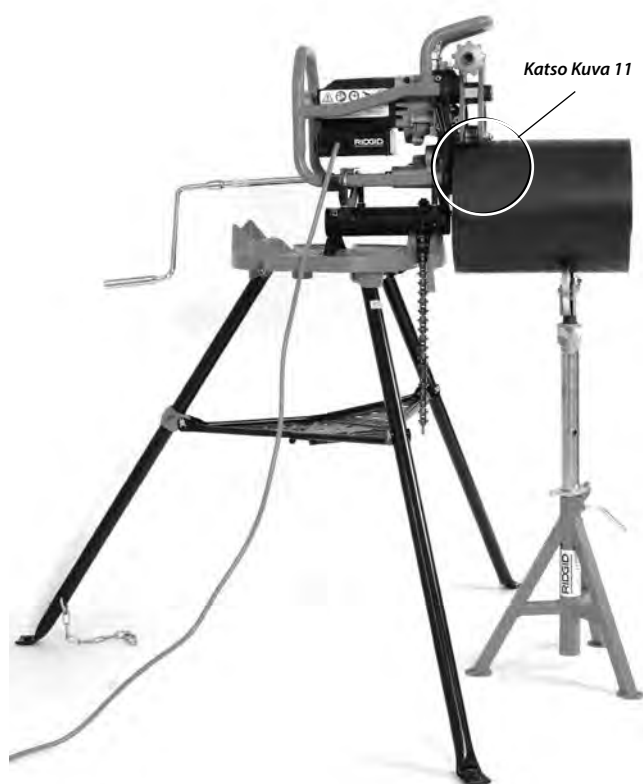
Kuva 12 – Kiinteä viisteleikkuri, lyhyt putki, yksi putkituki
