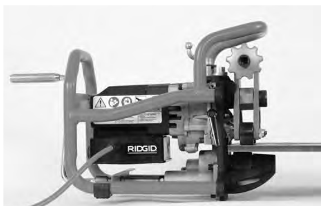
16B ábra – A leélező gép felszerelése a lemezre
