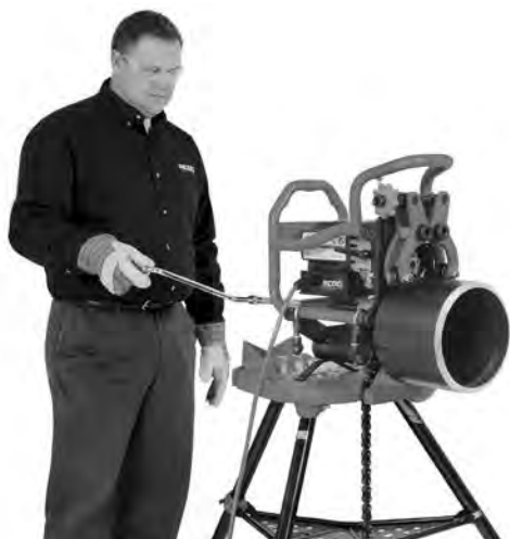
Figur 20C – Affasningsproces (fast affasningsværktøj/ roterende rør)
