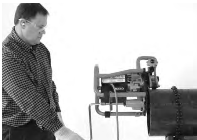
Rys. 20A – Czynność ukosowania (nieruchomy detal/ poruszająca się ukosowarka)
