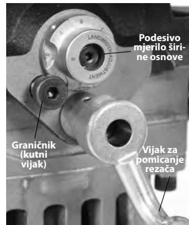
Slika 18 – Podešavanje podesivog mjerila širine osnove
