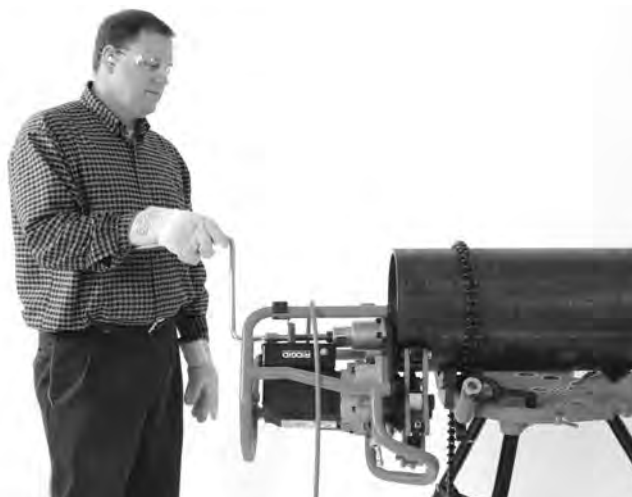
Figur 20B – Avfasningsfunktion (fast arbetsstycke/rörlig avfasare)
