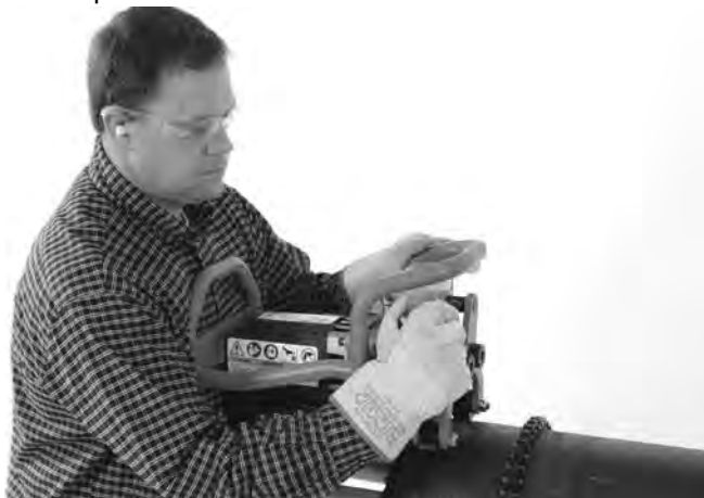
Obrázek 17A – Ručně dotáhněte upínací šroub
