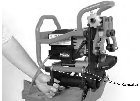
Şekil 9 – Pahlama Makinesinin Adaptöre Tespit Edilmesi
