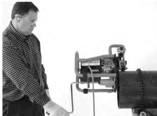
Figura 20A – Operazione di smussatura (Pezzo in lavorazione fisso/Smussatrice mobile)
