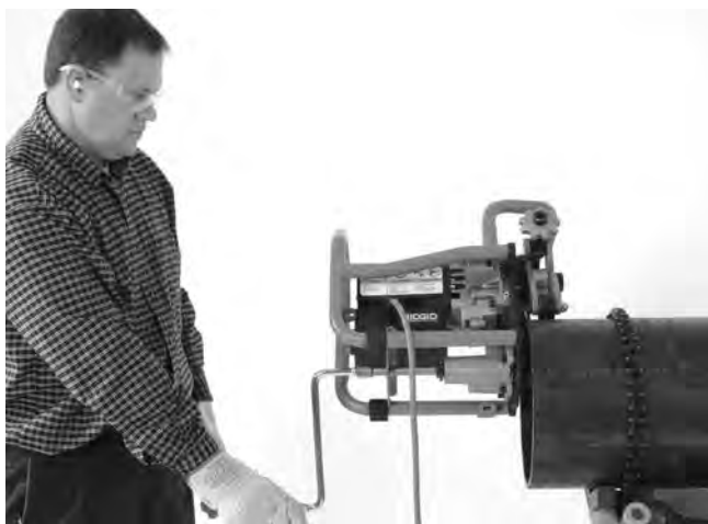
Εικόνα 20A – Λειτουργία φρεζαρίσματος (Σταθερό τεμάχιο εργασίας/κινούμενο εργαλείο φρεζαρίσματος σωλήνων)
