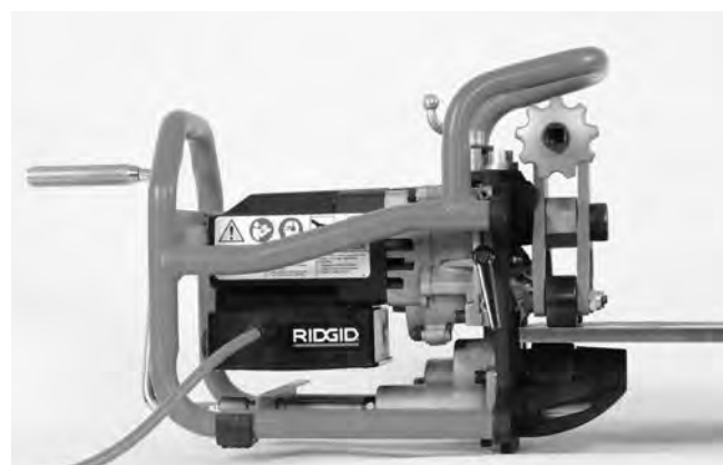
Rys. 16B – Zakładanie ukosowarki na płycie
