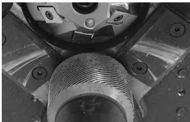
Figura 22 – Pulire le zigrinature del Rullo di trasmissione
