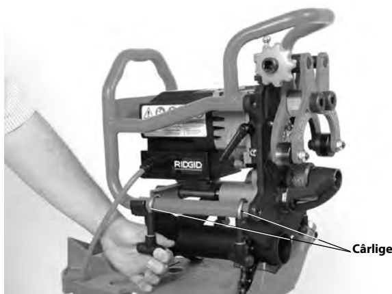
Figura 9 – Fixarea mașinii de șanfrenare la adaptor
