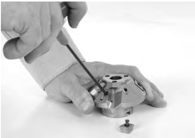
Rys. 24 – Wymiana płytek wielostrzowych
