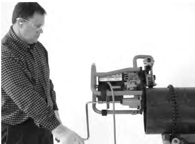
Obrázek 20A – Postup úkosování (fixní opracovávaný kus/pohyblivá úkosovačka)
