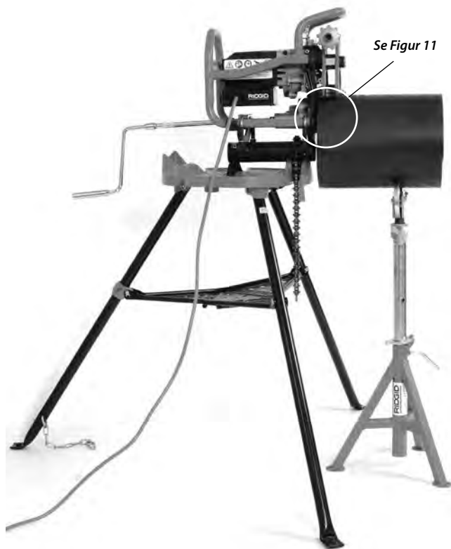
Figur 12 – Fast avfasare, kort rör, ett rörstativ
