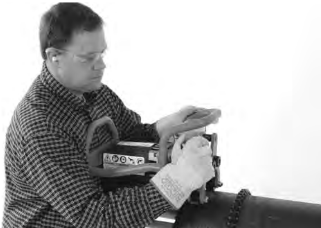
Figur 17A – Dra åt låsskruven med handkraft
