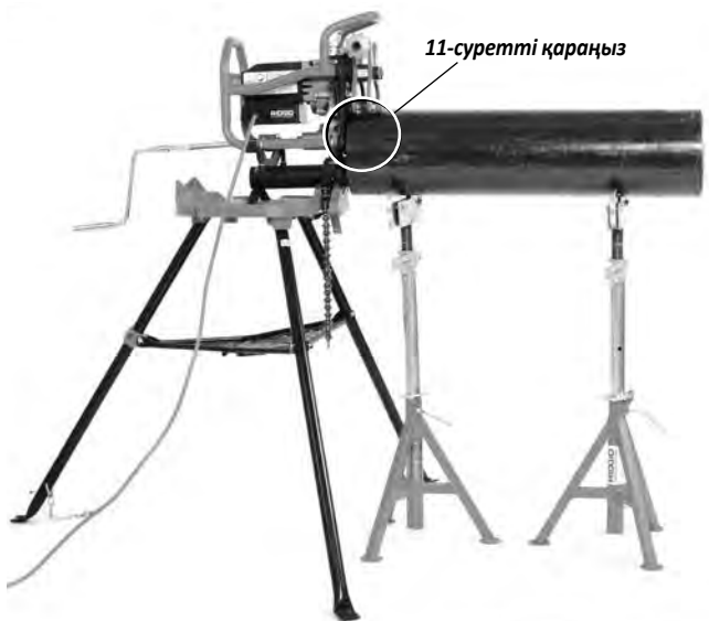
13-сурет – Тұрақты қиғаш кесу құралы, ұзын құбыр, бірнеше құбыр білтесі
