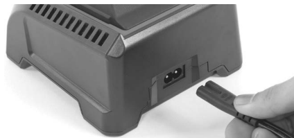
Εικόνα 6 – Τοποθέτηση καλωδίου τροφοδοσίας
