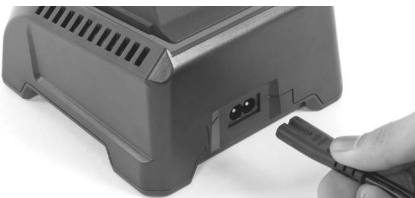
Slika 6 – Postavljanje kabla napajanja
