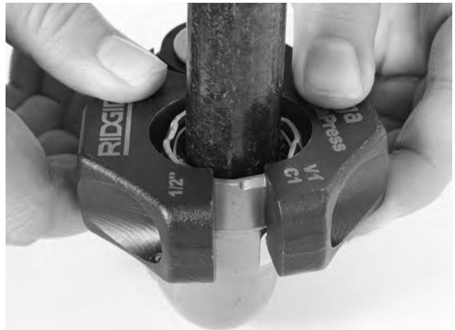
Figura 11 – Montaje del aro sellador en el acoplamiento
