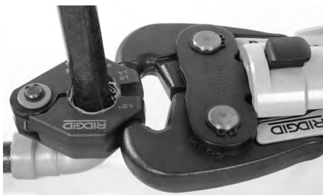
Figura 12 – Montaje del accionador en el aro sellador
