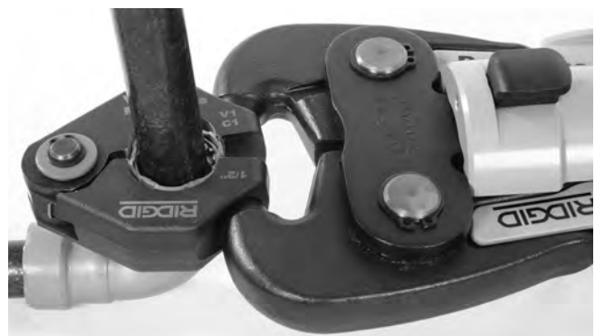
Figure 12 – Engagement de l'actionneur sur la bague de sertissage
