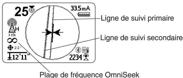
Si le SR-24 détecte des signaux dans les autres plages de fréquences, il affiche des Lignes de suivi en pointillé indiquant la position approximative de ces signaux secondaires. Si le récepteur est déplacé, le point focal permute automatiquement sur le signal le plus proche.
