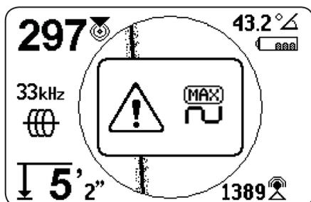
Le SR-24 répond à cet écrêtage en atténuant la mesure. L'atténuation réduit l'intensité de la Puissance du signal de manière à ce que le SR-24 puisse la mesurer. Si le SR-24 rencontre toujours un écrêtage, accroître la distance entre le SR-24 et la ligne cible.
