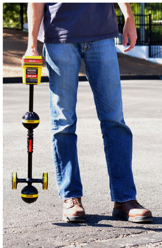
Le système d'antenne omnidirectionnelle du SR-24 mesure des signaux électromagnétiques et calcule la force et la profondeur de l'orientation, ainsi que le degré de distorsion ou d'interférence. Les informations affichées et audio multidimensionnelles vous fournissent une expérience de localisation qui est immédiatement intuitive.
