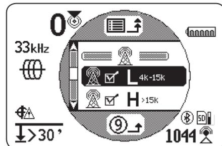
En plus du type de signal de bande large, le SR-24 affiche des informations quant à la position de la source la plus forte dans la plage de fréquences donnée.
