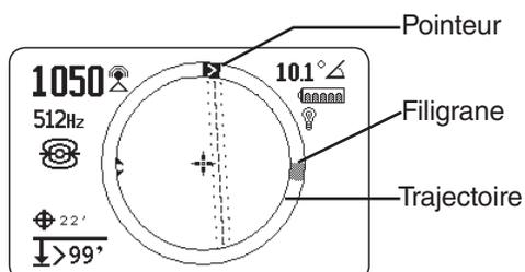
La trajectoire est le circuit circulaire autour de la zone de vue active. Au fur et à mesure que vous déplacez le récepteur, le pointeur se déplace dans les sens des aiguilles d'une montre autour de la trajectoire tandis que la Puissance de signal augmente et dans le sens inverse des aiguilles d'une montre lorsque celle-ci diminue. Lorsque la Puissance de signal commence à diminuer, un filigrane est appliqué pour représenter le niveau de puissance de signal détecté maximal.
