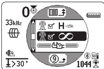
Le signal le plus proche du récepteur est le signal primaire et sa plage de fréquence est affichée sur l'écran au-dessus de l'icône OmniSeek. La Ligne de suivi épaisse et les autres lectures affichées refléchissent ses caractéristiques.
