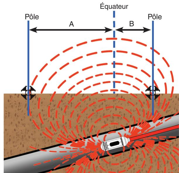
Figure 9 – Sonde à Pile NaviTrack RIDGID
