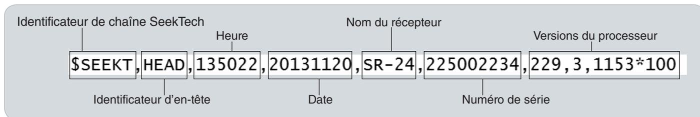
Les données enregistrées contiennent un identificateur de chaîne SeekTech ou préfixe d'identification NMEA, un identificateur de groupage, une abréviation de données et la valeur des données mesurées par le SR-24. Les chaînes de données SIG ou LCD commencent avec l'identificateur de chaîne Seektech, suivi de l'identificateur de groupage SeekTech, de l'abréviation de données et de la valeur.
