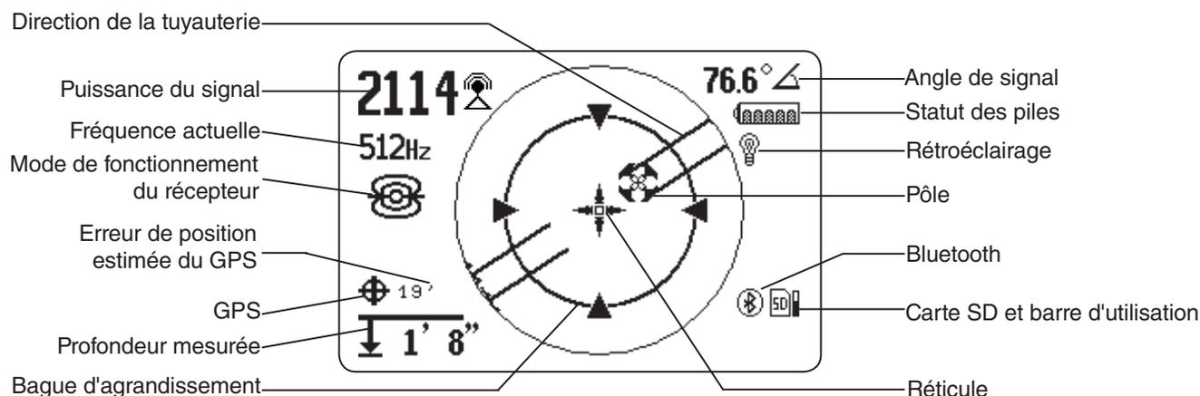
Figure 2 – Exemple d'affichage en mode Sonde
