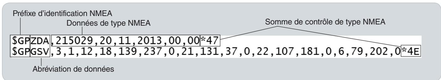
L'abréviation de données indique le type de données et la valeur indique la mesure enregistrée. Si la mesure enregistrée est zéro, le SR-24 mesure un zéro pour cet élément de données spécifique.
