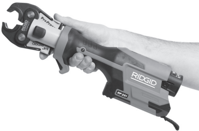
Figura 6 – Apertura de las mordazas con una sola mano
