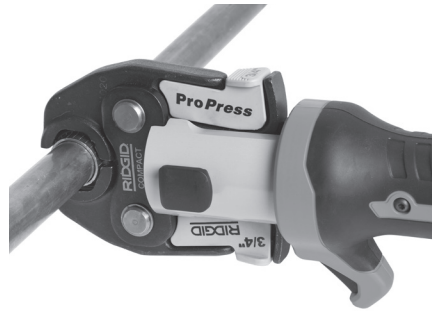
Figura 7 – Colocación de las mordazas para que encierren el acoplamiento
