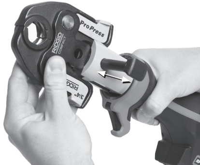
Figure 5 – Broche de fixation des outils de sertissage
