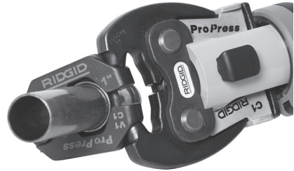
Figure 10 – Engagement de l'actionneur sur la bague de sertissage
