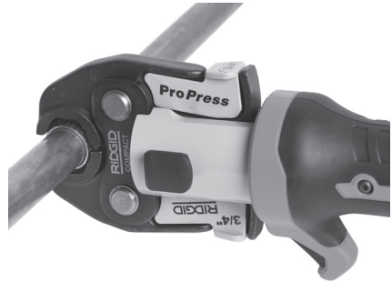
Figure 7 – Engagement de mâchoires à ciseaux autour du raccord
