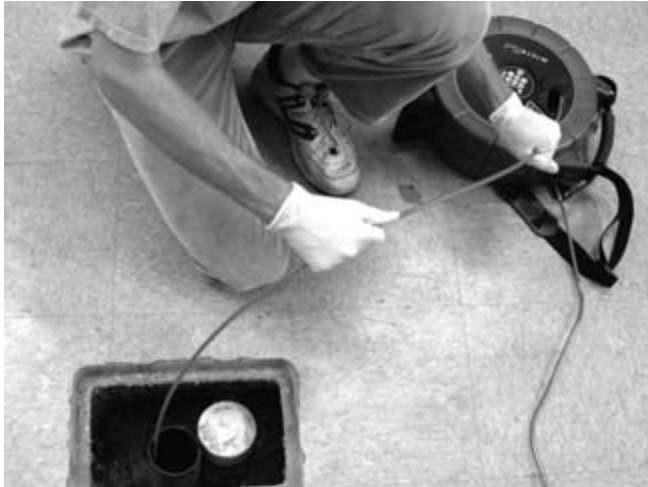
Figura 28 – Tecnica adeguata per riavvolgere il cavo nel tamburo
