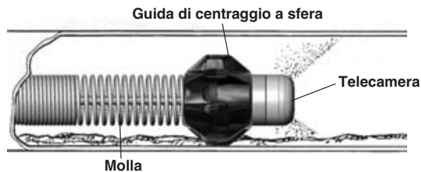
Figura 24 – Guide di centraggio a sfera in uso
