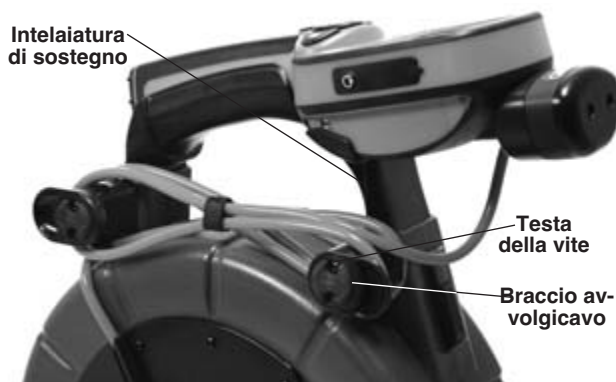
Figura 13 – Intelaiatura di sostegno e bracci avvolgicavo
