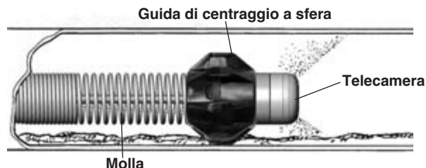
Figura 16 – Guide di centraggio a sfera in uso
