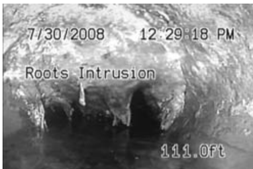
Figura 25 – Schermata di visualizzazione con Testo scorrevole, Orario e Distanza (distanza misurata dal punto zero del sistema)
