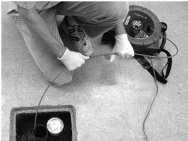
Figura 29 – Permettere che il cavo si curvi può far sì che il cavo si impigli mentre viene spinto nel tamburo
