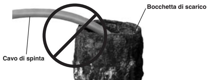
Figura 23 – Evitare di tirare in corrispondenza di angoli vivi
