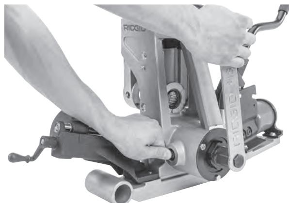
Abbildung 29 – Einrasten der Spindelsperre und Lösen des Zugbolzens
