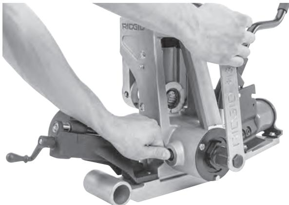
Figure 29 – Engagement de la broche de verrouillage et desserrage du boulon de retenu
