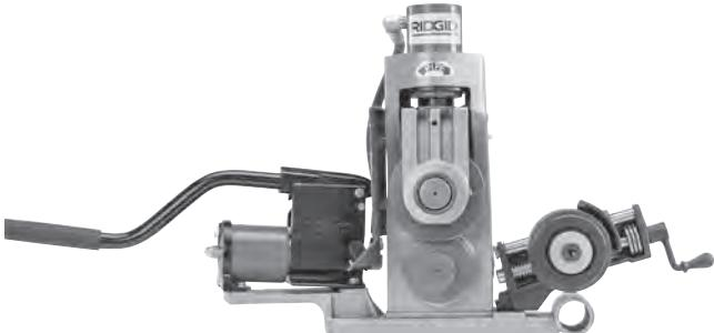
Abbildung 2B – Montage der 918 am Sockel 300 PD
