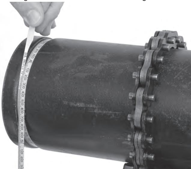
Abbildung 22 – Kontrolle des Nutdurchmessers mit einem Maßband
