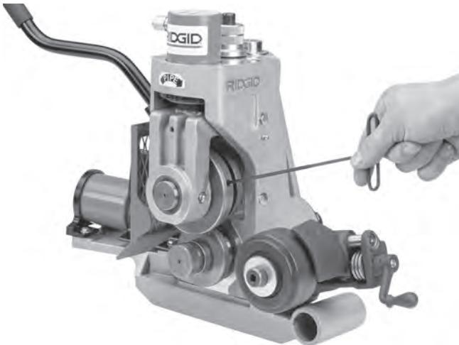
**Figure 25 – Desserrage de la vis de blocage du galet de rainurage**
