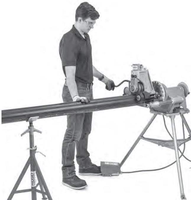
Figura 21 – Aplicación de presión sobre el tubo, con el accionamiento motorizado en dirección FOR
