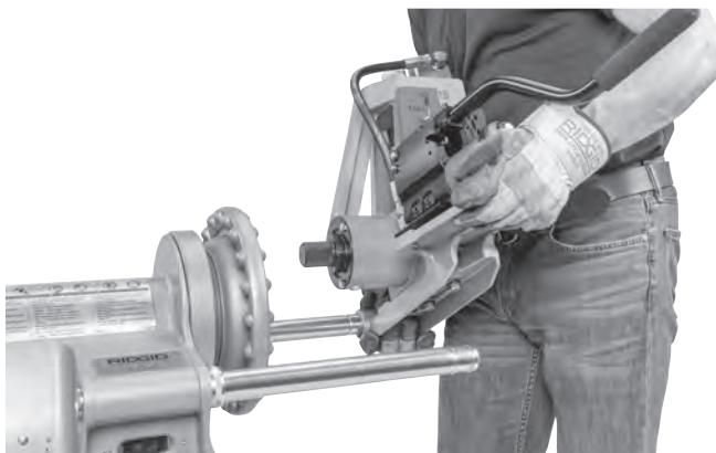
Figure 7A – Montage de la 918 sur système d' entraînement 300 Power Drive
