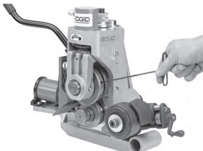
Abbildung 25 – Lösen der Stellschraube der Nutrolle
