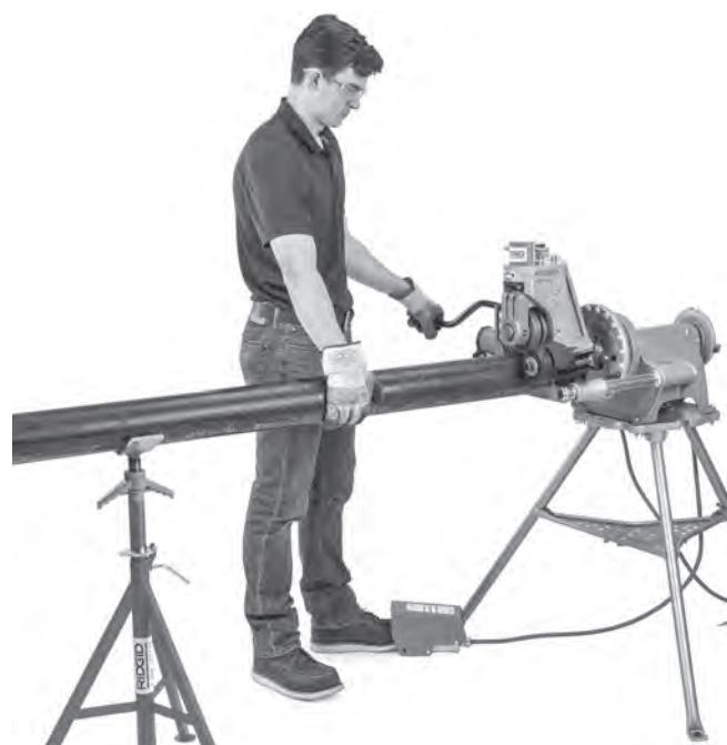
**Figura 20 – Aplicación de presión sobre el tubo, con el accionamiento motorizado en dirección REV**
