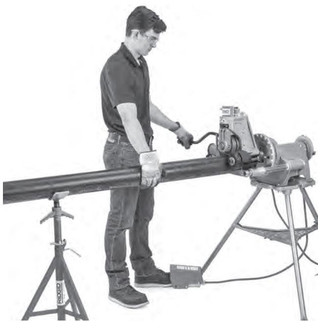
**Figure 20 – Utilisation du système d'entraînement Power Drive en position REV pour appuyer sur le tuyau**
