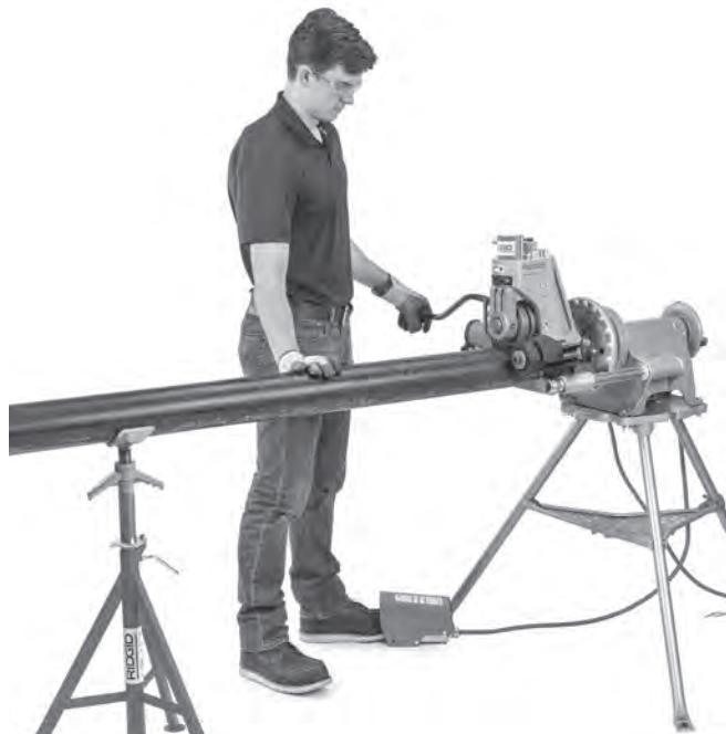
**Abbildung 21 – Anwenden von Druck auf das Rohr mit elektrischem Antrieb in FOR-Richtung**
