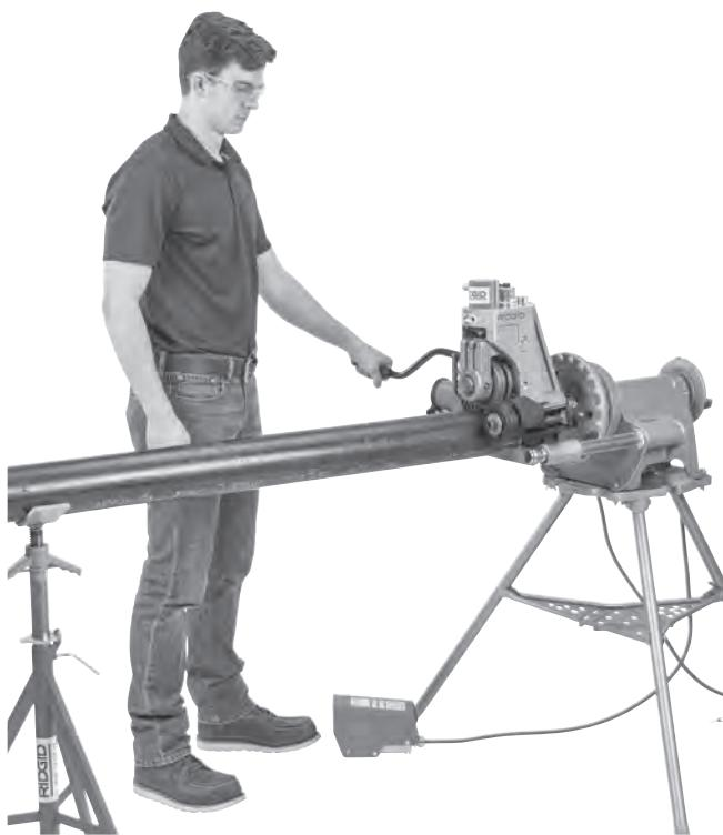
Abbildung 19 – Korrekte Arbeitsposition
