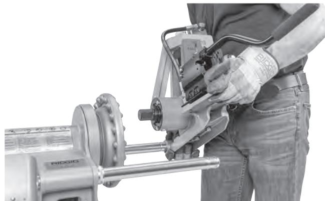
Abbildung 7A – Installation der 918 am elektrischen Antrieb 300
