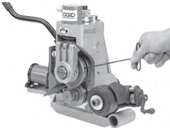
Figura 25 – Aflojar el tornillo de montaje del juego de rodillos ranuradores
