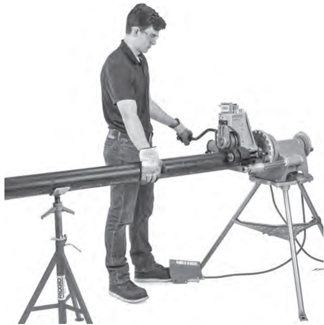
**Abbildung 20 – Anwenden von Druck auf das Rohr mit elektrischem Antrieb in REV-Richtung**
