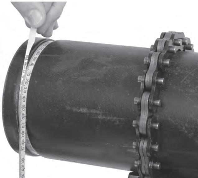
Figura 22 – Medición del diámetro en la ranura con la cinta de diámetros
