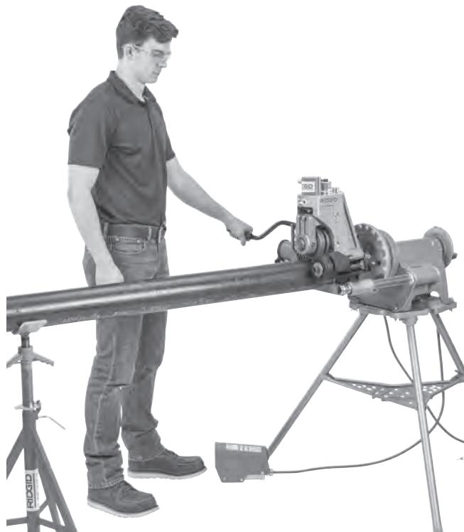
Figura 19 – Posición correcta para ranurar
