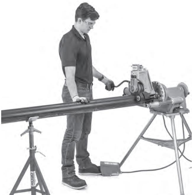
**Figure 21 – Tuyau poussé légèrement en avant avec le système d'entraînement en position FOR**
