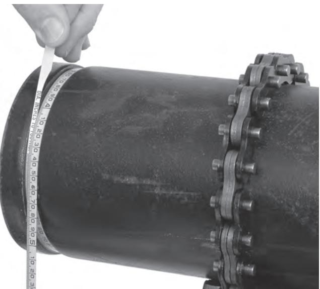
**Figure 22 – Vérification du diamètre de la rainure à l'aide d'un ruban**
