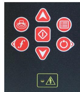
図4 – 高電圧LEDインジケーター
