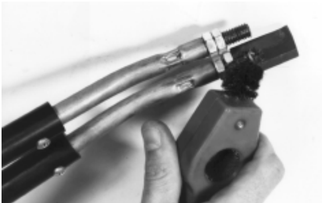
Figure 9 – Nettoyage des goujons filetés
