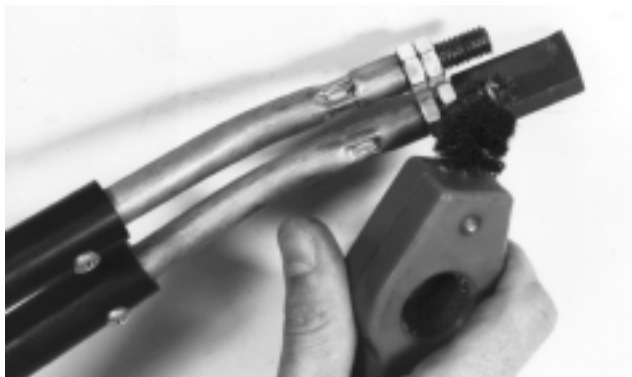
Figura 9 – Limpieza de las espigas roscadas
