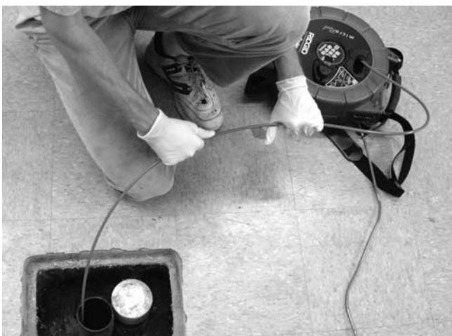
図 29 — ねじれる危険があるので、ドラム収納時にケーブルをたるませない
