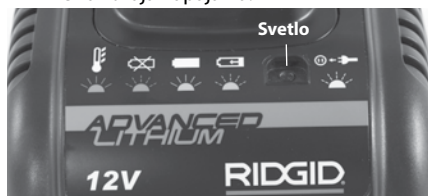
Obrázok 5 – Diódy LED a označenia na nabíjačke
