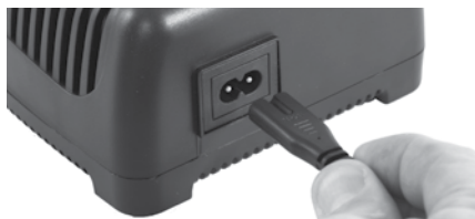
Figure 4 – Insertion du cordon d'alimentation
