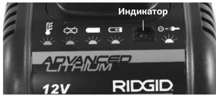
Рис. 5 – Светодиоды и маркировки зарядного устройства
