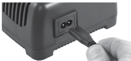
Figura 4 – Introducerea cablului de alimentare
