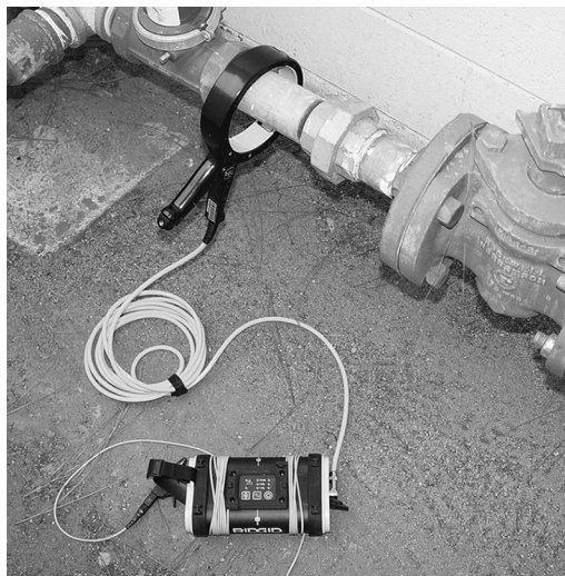
Figura 9: Morsetto induttivo collegato a un conduttore
