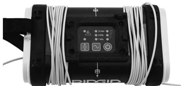
Figura 11: ST-305 in modalità induttiva a 33 kHz
