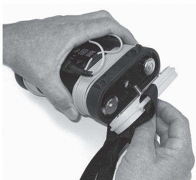
Figura 3: Rimozione del coperchio delle batterie
