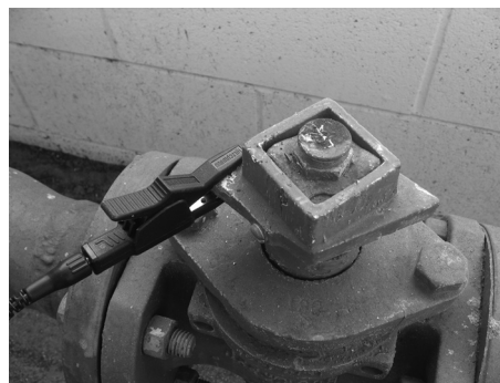
Figura 7: Collegamento dell'ST-305 a una linea
