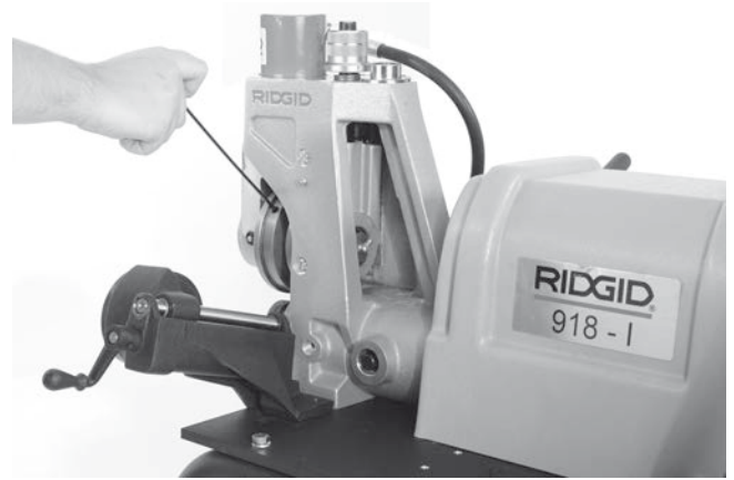
Şekil 21 - Yiv Merdanesi Seti Vidasının Gevşetilmesi
