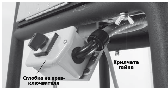
Фигура 5 - Монтиране на устройството за жлебове към стойката
