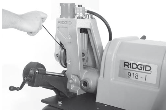
Afbeelding 21 - De schroef van de groefrolset losdraaien
