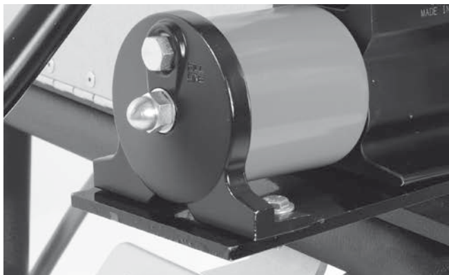
Figura 20 - Tappo del serbatoio
