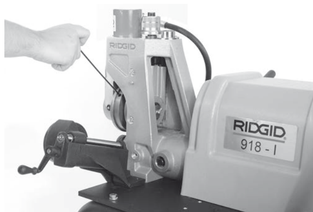
Figura 21 – Desapertar o parafuso de ajuste do rolete de ranhura
