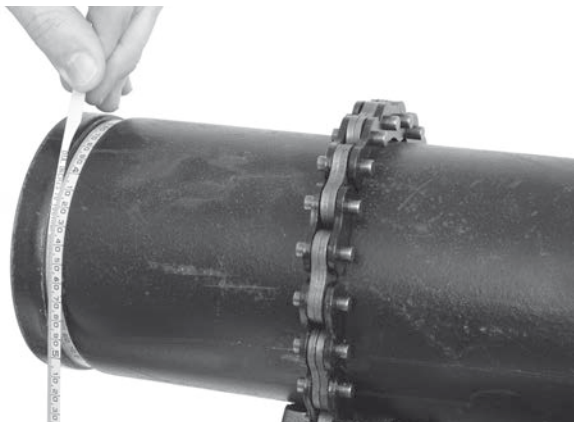
Figur 18 – Kontrol af notdiameteren med et diatermålebånd
