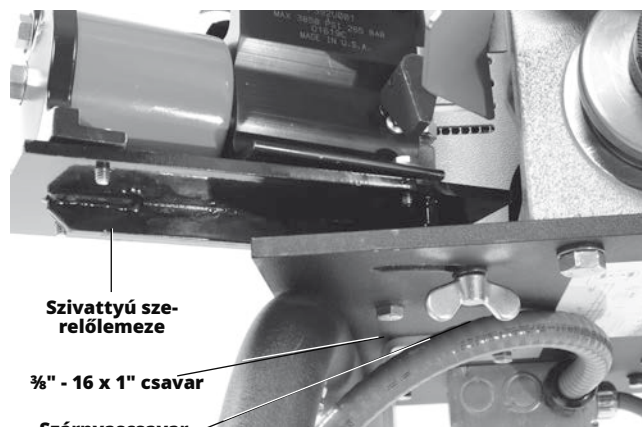
6. ábra - Hidraulikus szivattyú felszerelése
