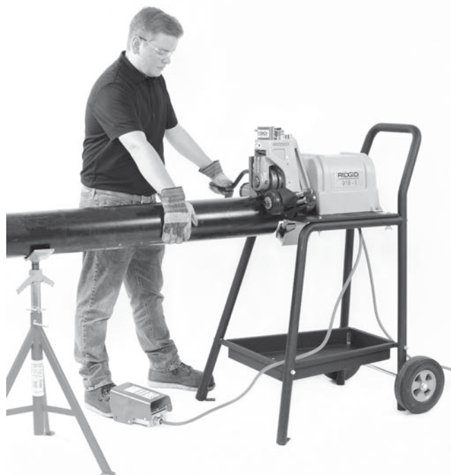
17. ábra - Nyomás kifejtése a csőre
