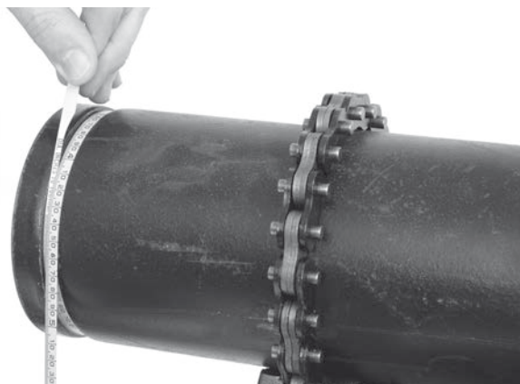
Kuva 18 – Utan halkaisijan tarkastus mittanauhalla
