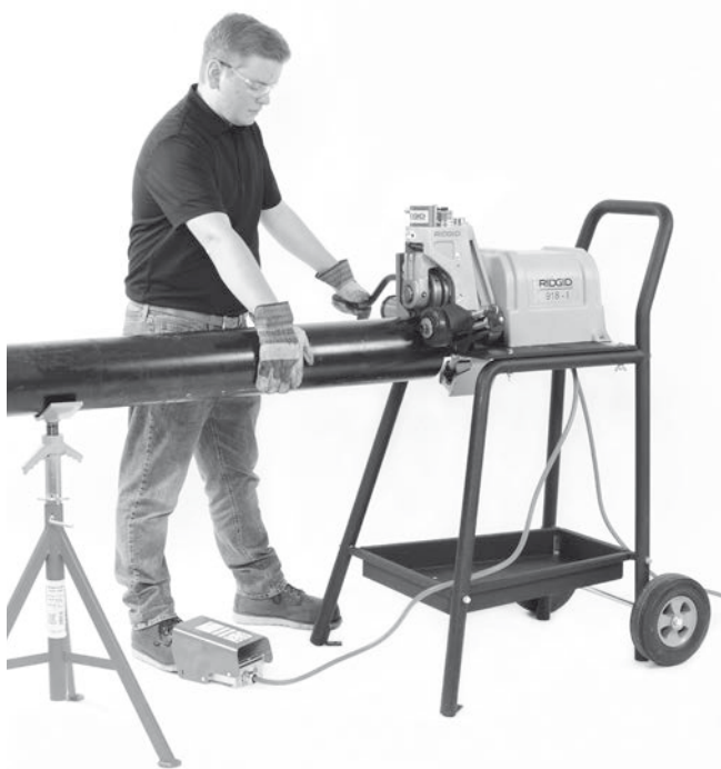
Obrázok 17 - Tlak na potrubie
