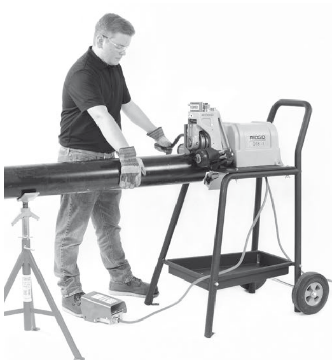
Figura 17 – Aplicarea presiunii pe țeavă
