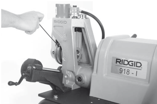
Obrázok 21 – Povolenie stavacej skrutky drážkovacieho valca
