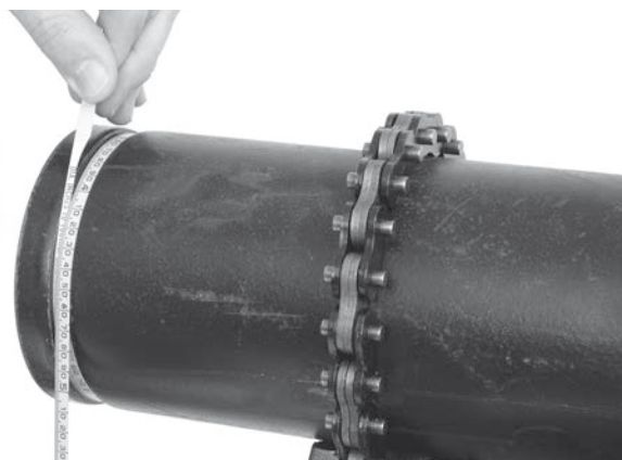
Rysunek 18 – Sprawdzanie średnicy rowka za pomocą taśmy mierniczej
