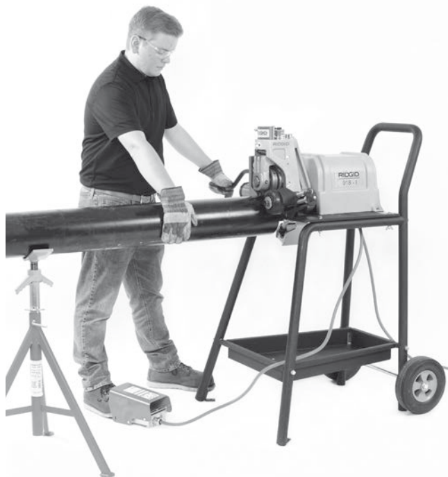
Afbeelding 17 - Druk uitoefenen op de pijp
