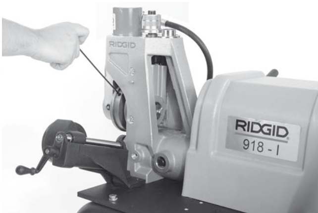
Figur 21 - Løsne settskrue i freserille
