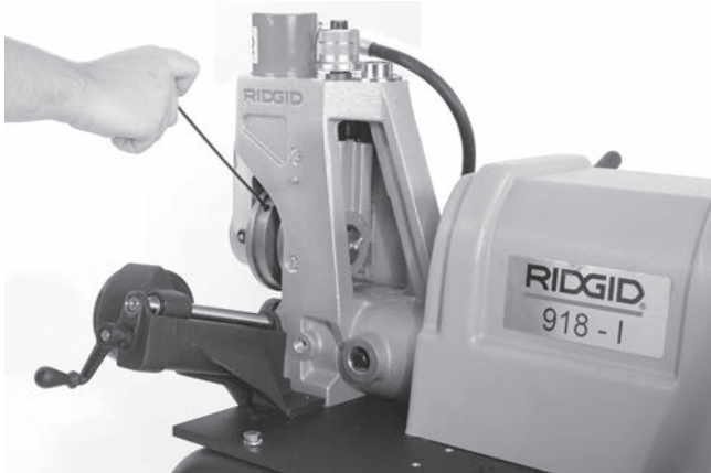
Figura 21 – Afloje el tornillo de montaje del juego de rodillos ranuradores
