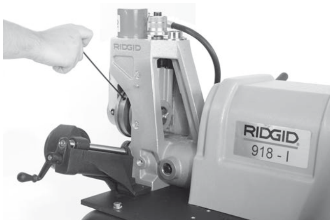
21-сурет – Ойық аунақшасының орнату бұrandасын босату
