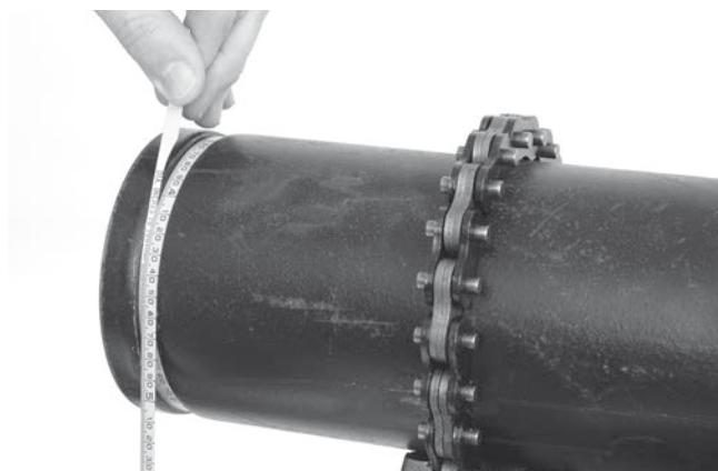
Obrázok 18 - Kontrola priemeru drážky pomocou meradla priemeru
