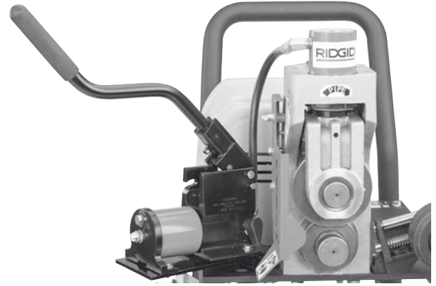
Şekil 7B - Pompa Taşıma Konumunda [Yukarı]
