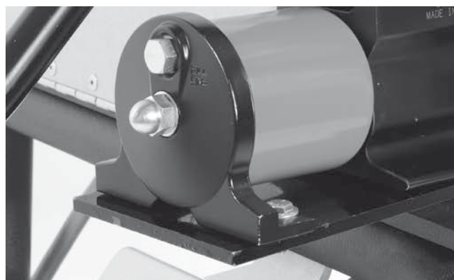
Obrázok 20 – Uzáver plniaceho otvoru nádrže
