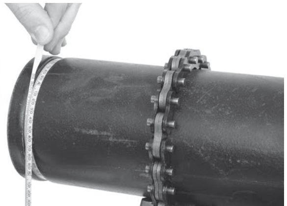
Figur 18 – Kontrollera spårdiametern med diametertejp
