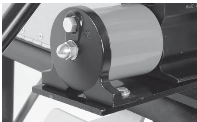
Εικόνα 20 - Καπάκι πλήρωσης ρεζερβουάρ
