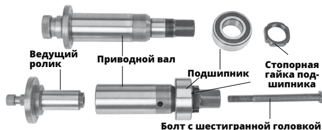
Рис. 23 - Целый приводной вал (верхний), двухкомпонентный приводной вал (нижний)
