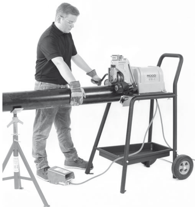
Figur 17 – Trycksättning på rör
