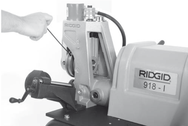
Figur 21 - Lossa spårrullens ställskruv
