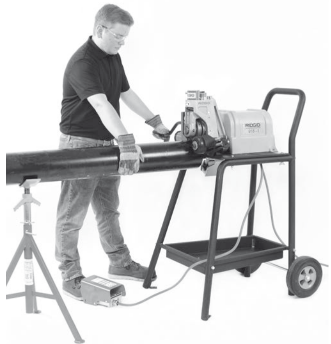
Figur 17 - Påføring af tryk på rør
