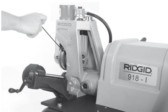
Slika 21 – Otpuštanje vijka kompleta valjka za valjanje utora
