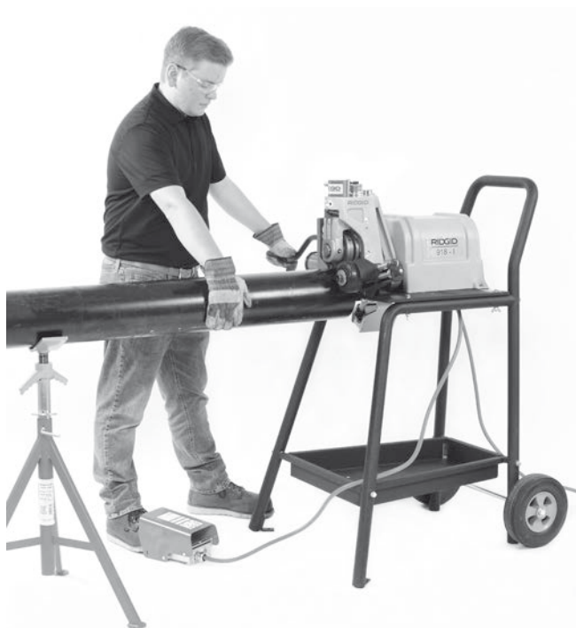
Slika 17 - Primenjivanje pritiska na cev
