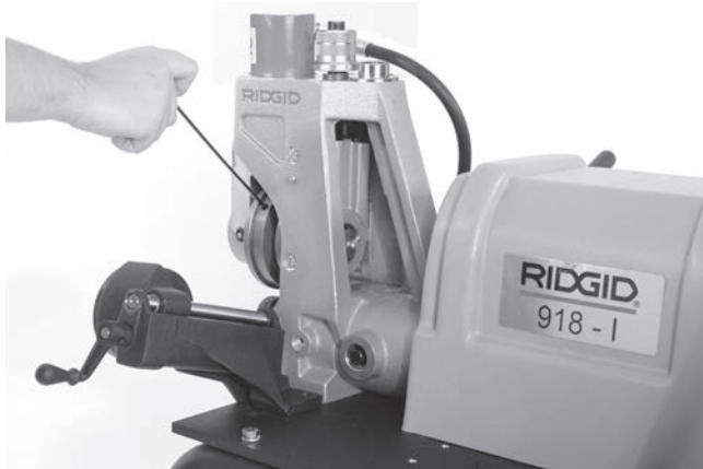
Abbildung 21 - Lösen der Stellschraube der Nutrolle
