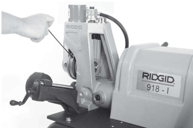
Рис. 21 - Ослабление установочного винта накатывающего ролика
