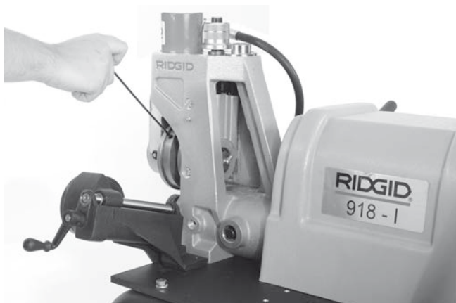
Фигура 21 – Разхлабване на винт на комплект ролки за жлебове
