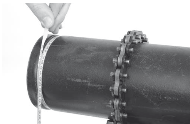
Фигура 18 – Проверка на диаметър на жлеб с мерителна лента
