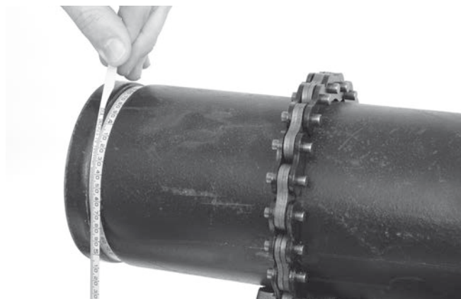
18-сурет – Ойық диаметрін диаметр таспасымен тексеру
