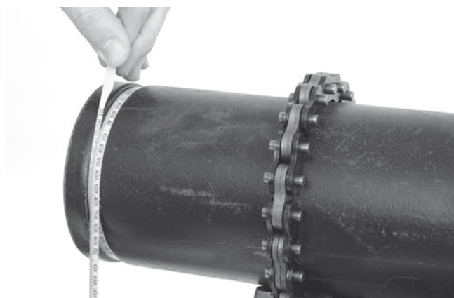
Рис. 18 - Проверка диаметра желобка с помощью мерной ленты для измерения диаметра
