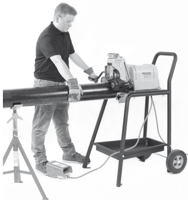
Figura 17 - Applicazione della pressione sul tubo
