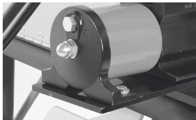
Slika 20 – Čep otvora za punjenje spremnika
