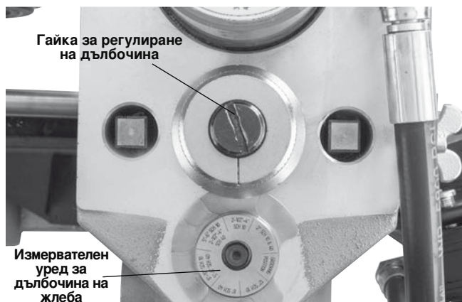
Фигура 14А – Поставете правилната стъпка на измервателния уред под регулиращата глава
