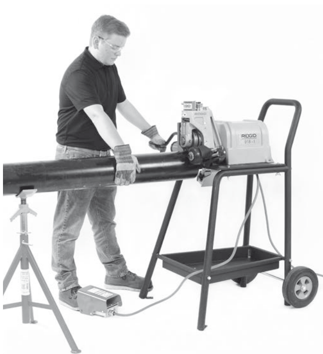
Slika 17 - Pritiskanje na cev
