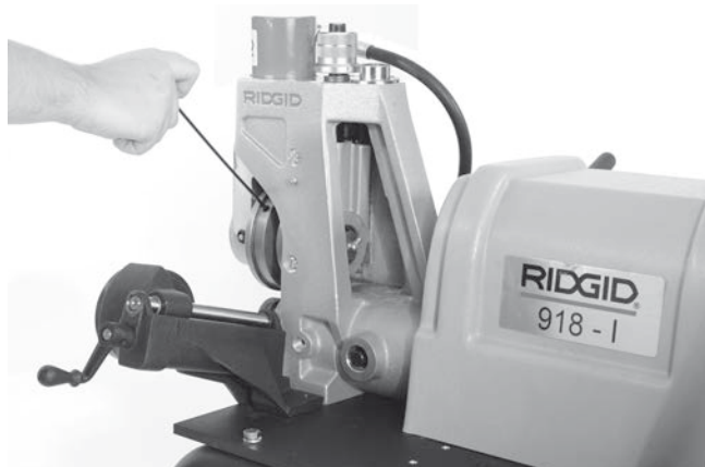
Rysunek 21 – Luzowanie śruby nastawczej rolki rowkującej
