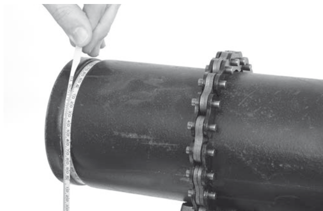
Slika 18 - Preverjanje premera utora s trakom za merjenje premera
