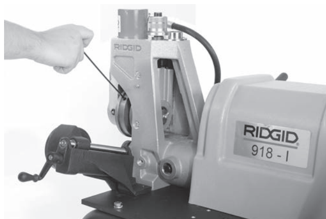
Figure 21 – Desserrage de la vis de blocage du galet de rainurage
