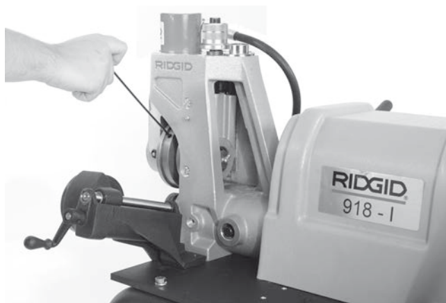
Figura 21 - Allentamento della vite di regolazione del rullo di scanalatura
