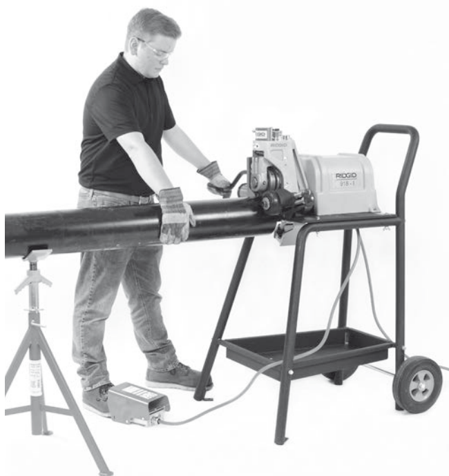
Obrázek 17 - Působení tlaku na potrubí
