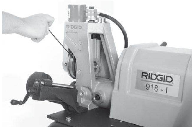
Obrázek 21 - Povolení nastavovacího šroubu drážkovací kladky
