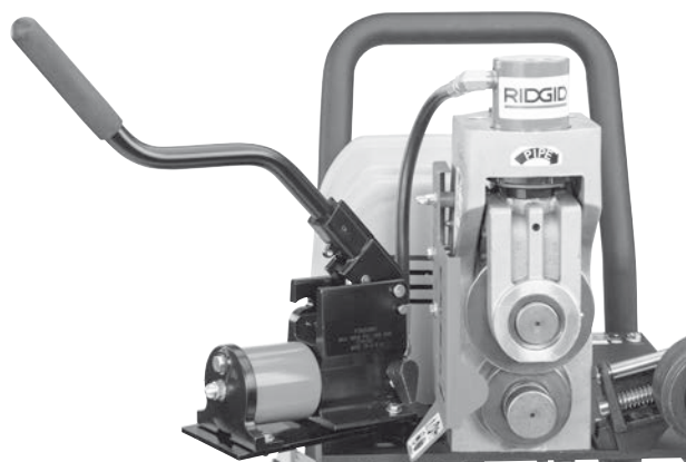
7В суреті – Тасымалдау күйіндегі [жоғары] сорғы
