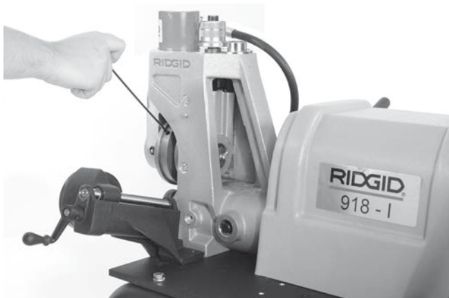
Slika 21 - Otpuštanje pričvrsnog vijka valjka za žlebove
