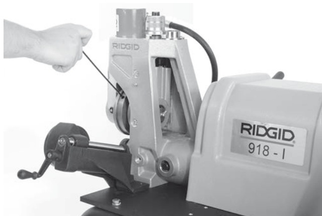
Figura 21 - Slăbirea șurubului de reglare a rolei de canelare
