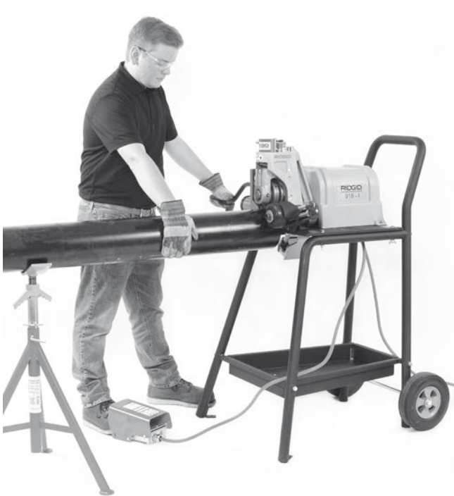
Εικόνα 17 – Εφαρμογή πίεσης στον σωλήνα Επιθεώρηση/μέτρηση της αυλάκωσης
