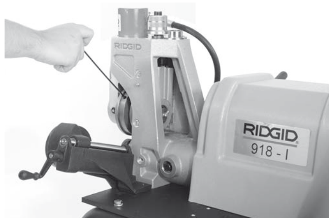
Slika 21 - Sproščanje vijaka kompleta valja za valjanje cevnih utorov
