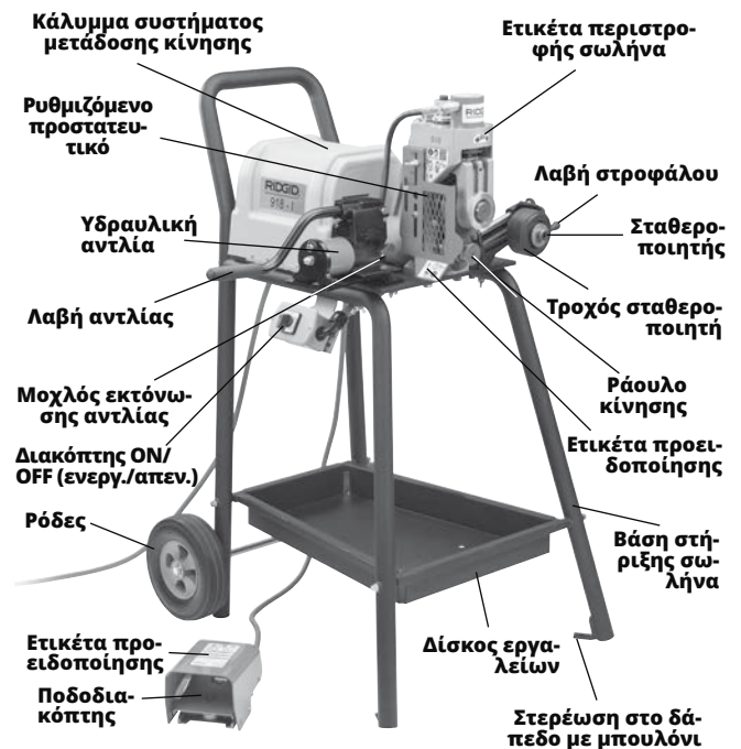
Εικόνα 1Α - Εργαλείο αυλάκωσης σωλήνων 918-I
