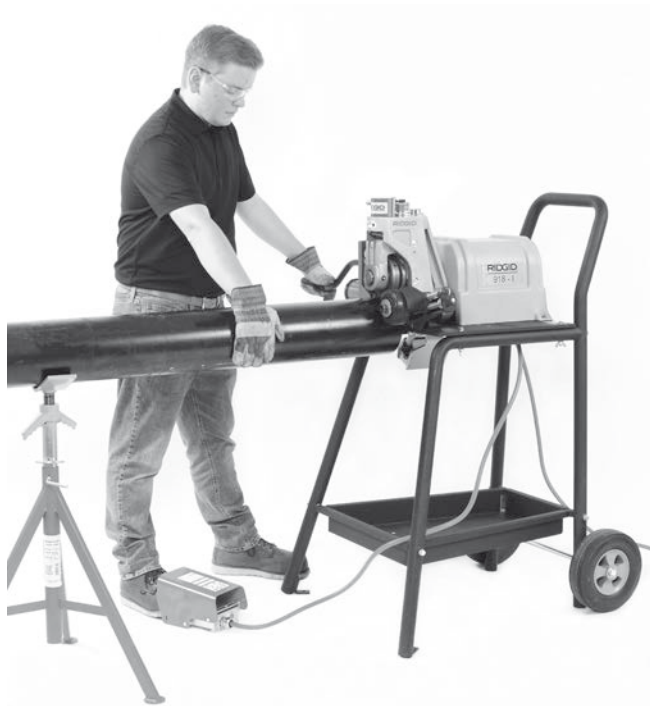
Rysunek 17 – Dociskanie rury
