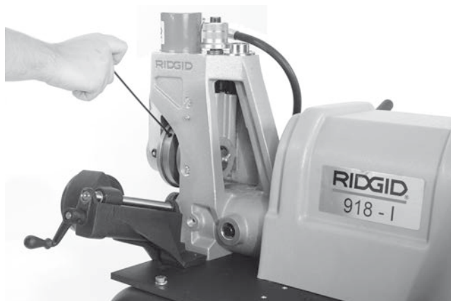
21. ábra - Hornyológörgő állítócsavarjának meglazítása
