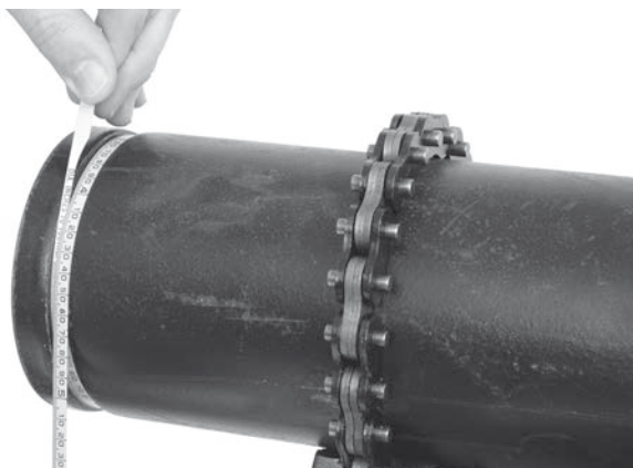
Afbeelding 18 - De groefdiameter met een rolmaat controleren
