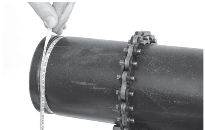
Εικόνα 18 – Έλεγχος της διαμέτρου της αυλάκωσης με ταινία διαμέτρου
