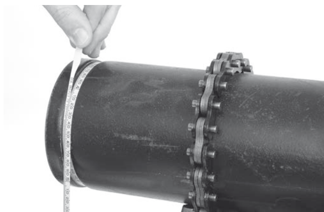
Obrázek 18 - Kontrola průměru drážky páskou na měření průměru
