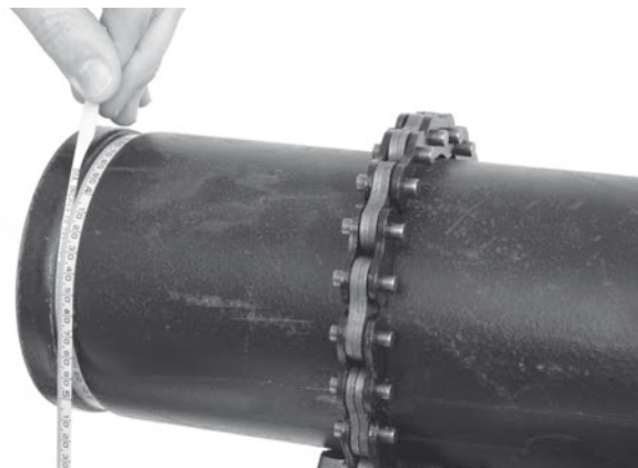
Figur 18 - Kontroll av rillediameter med en diameterbånd
