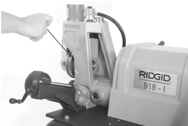
Εικόνα 21 - Λασκάρισμα της βίδας σύσφιξης του σετ ράουλων αυλάκωσης
