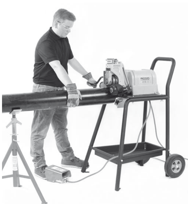
Slika 17 – Primjena pritiska na cijev
