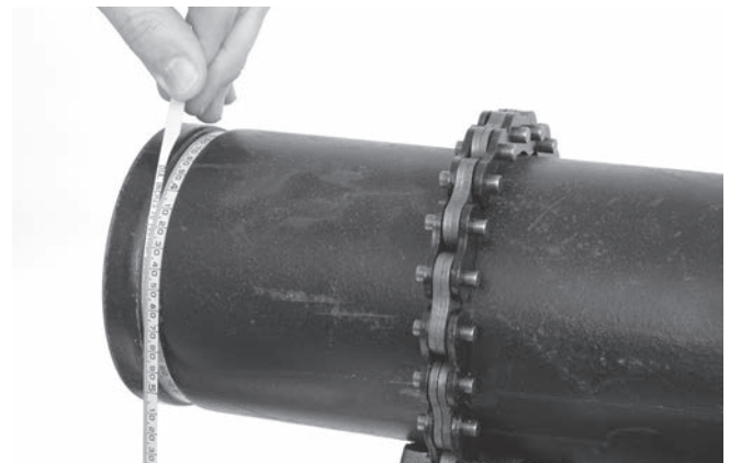
Abbildung 18 - Prüfen des Nutdurchmessers mit einem Durchmesserband
