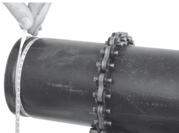
18. ábra - Horonyátmérő ellenőrzése átmérőmérő szalaggal
