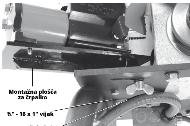
Slika 6 - Montaža hidravlične črpalke
