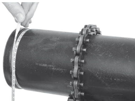
Slika 18 - Provera prečnika žleba pomoću trake za merenje žleba
