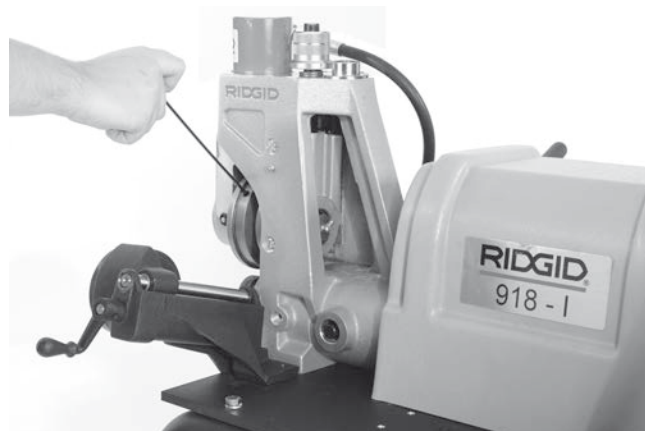
Figur 21 - Løsning af notrullens sætskrue
