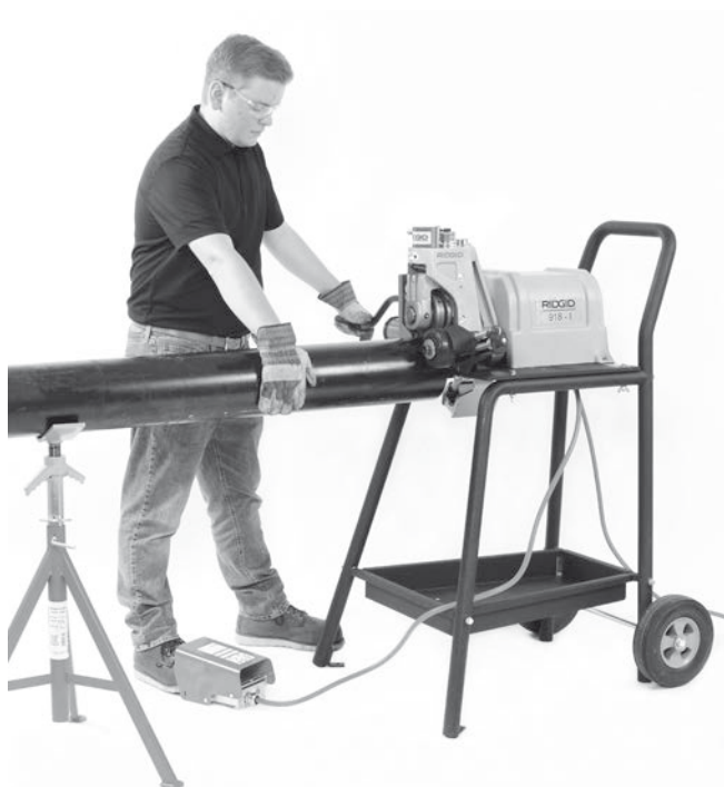
Фигура 17 – Прилагане на натиск върху тръбата
