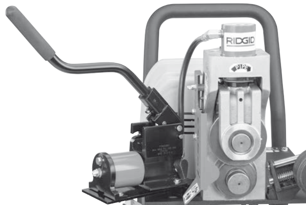
Slika 7B - Pumpa u transportnom položaju [gore]
