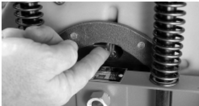
Figura 4 – Levante el pasador de desenclavamiento hacia ARRIBA para soltar el mecanismo de enganche para el tambor.
