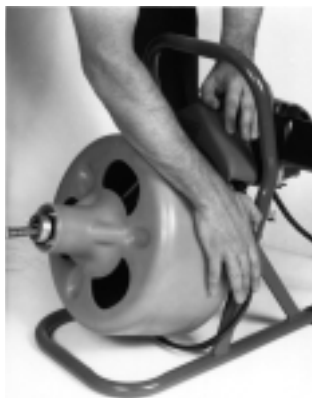
Figure 2 – Une fois la tension de la courroie libérée, retirez la courroie du tambour
