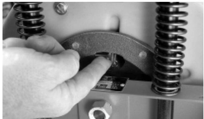
Figure 4 – Poussez la goupille de verrouillage vers le HAUT pour libérer le mécanisme de verrouillage du tambour
