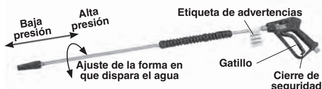
Figura 19 – Ajustes de la boquilla de la varilla de lavado
