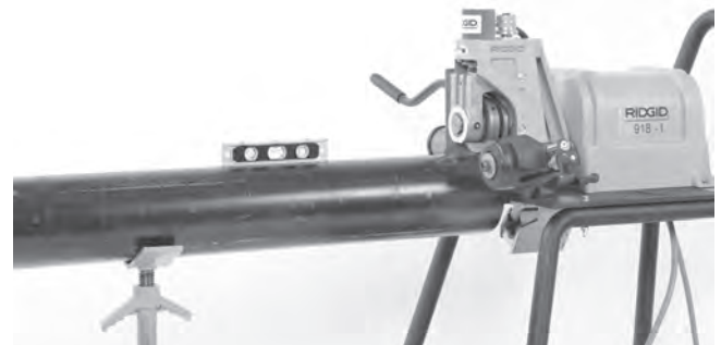
Figure 11 – Nivellement du tuyau
