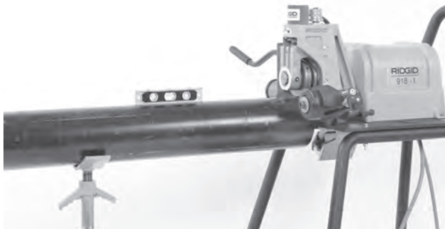
Figura 11 – Nivelación del tubo
