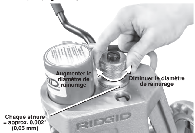
Figure 13 – Réglage de l'écrou de profondeur de rainurage
