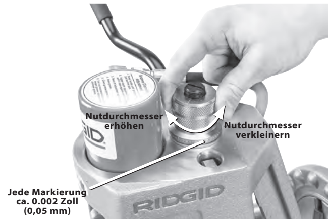
Abbildung 13 - Einstellung der Tiefeneinstellmutter
