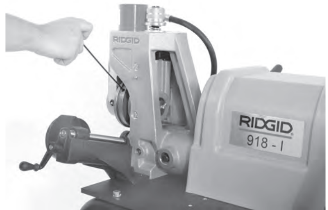
Abbildung 20 - Lösen der Stellschraube der Nutrolle
