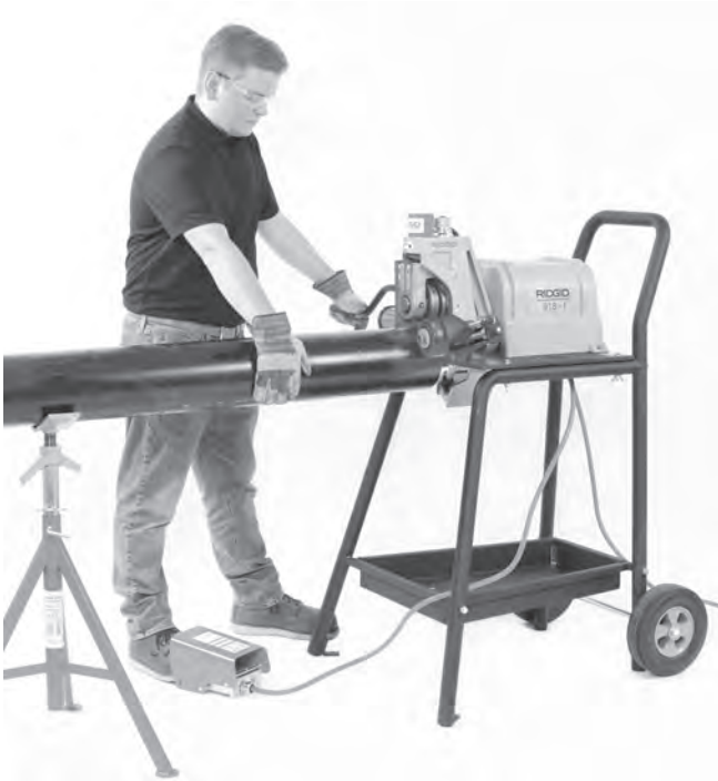
Figura 16 – Aplicación de presión sobre el tubo
