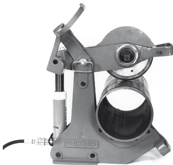
Рис. 8 – Установка трубы в труборез
