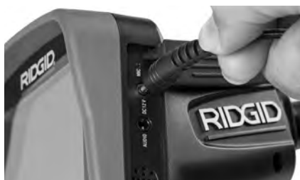
Abbildung 6 - Betreiben des Gerätes mit Netzteil
