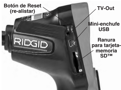
Figura 4 – Puertos del lado izquierdo
