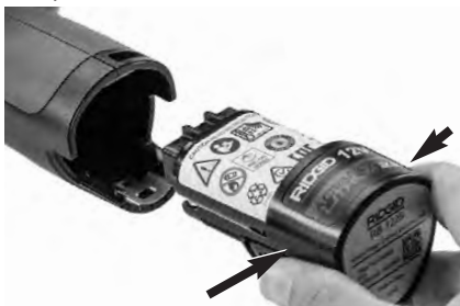
Figura 5 – Extracción e instalación de la batería
