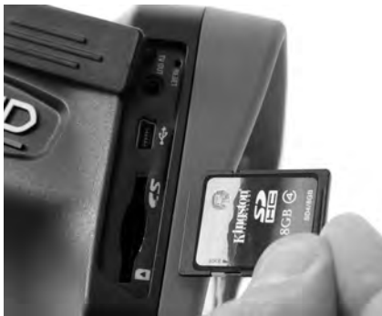
Figura 9 – Introducción de la tarjeta SD
