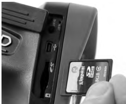
Abbildung 9 - Einsetzen der SD-Karte
