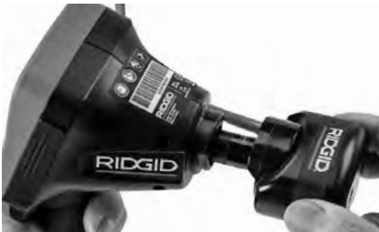
Figure 18 – Connexion du câble de tête de caméra
