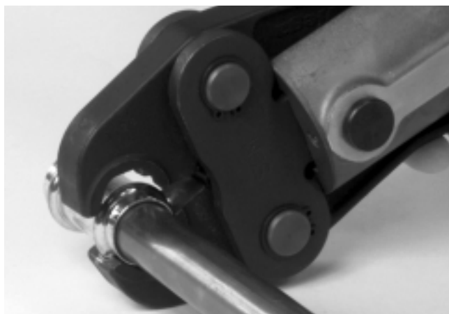
Figura 8 – Montaje de las mordazas alrededor del acoplamiento
