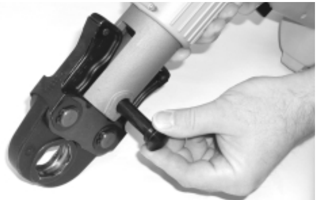
Figura 2 – Retire hasta atrás el pasador para el montaje de las mordazas
