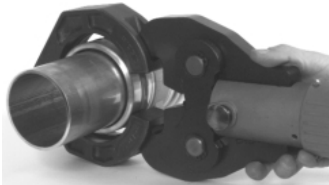
Figure 11 – Montage de l'actionneur à bagues sur la bague de sertissage
