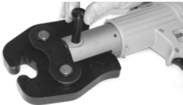
Figure 5 – Retrait de l'axe de montage des mâchoires
