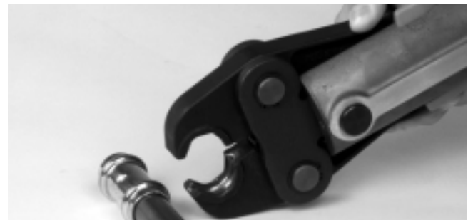
Figure 7 – Ouverture des mâchoires par compression des bras
