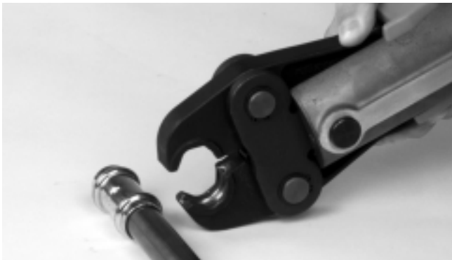
Figura 7 – Apertura de las mordazas tipo tijeras
