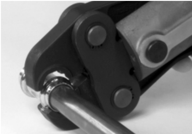
Figure 8 – Positionnement des mâchoires à ciseaux autour des raccords
