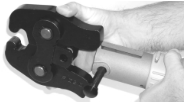
Figure 6 – Introduction de l'actionneur de bague RIDGID R2 dans la 320-E
