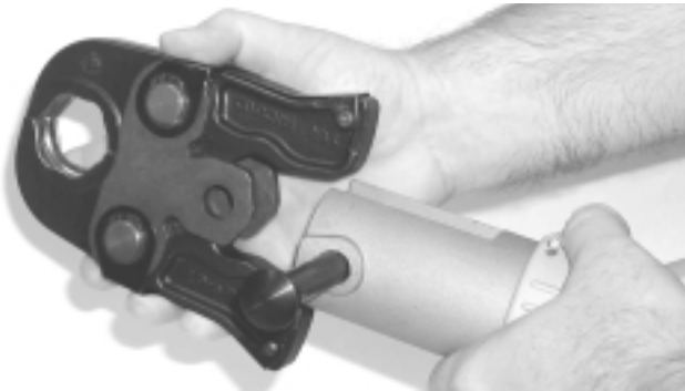
Figure 3 – Insertion du jeu de mâchoires dans la 320-E
