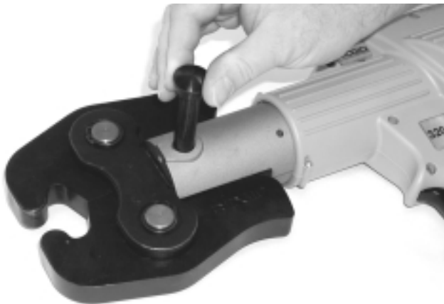
Figura 5 – El pasador para el montaje de las mordazas se jala
