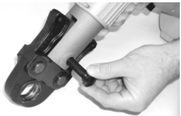
Figure 2 – Retrait de l'axe de montage du jeu de mâchoires
