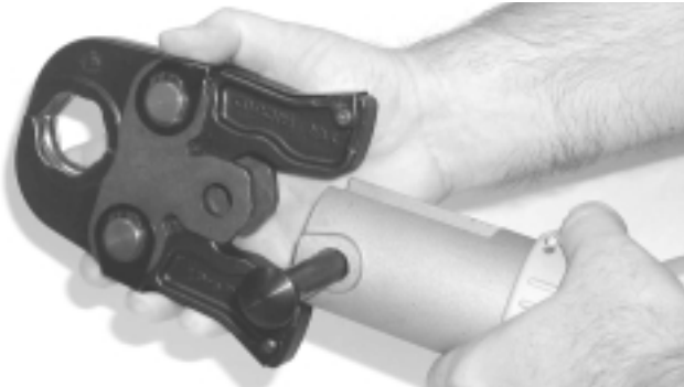
Figura 3 – Introducción del juego de mordazas en la 320-E
