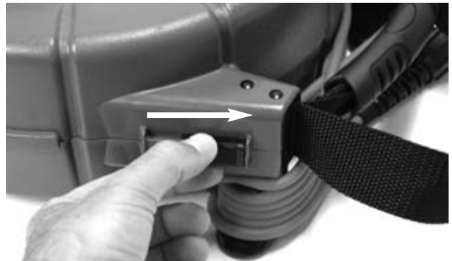
Kuva 4 – microReel-kelan laatikön avaaminen
