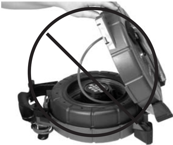
Kuva 10 – Älä päästä kaapelia purkautumaan vapaasti
