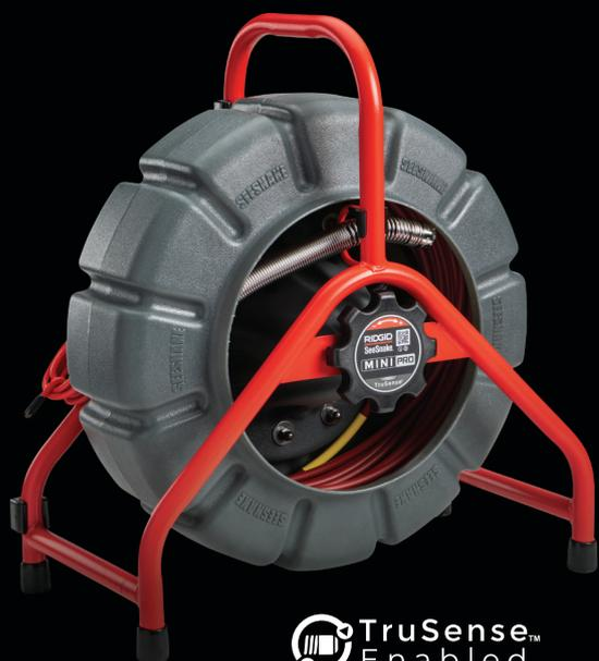
La RIDGID® SeeSnake® Mini Pro™ mostra immagini più stabili all'interno del tubo grazie all'autolivellamento digitale e alla tecnologia TruSense™. La nostra testa della telecamera autolivellante più corta Ø 25 mm è in grado di superare curve a 90° e di ispezionare fino a 61 m (200 piedi) con un cavo di spinta di media rigidità. L'assenza di parti mobili nella testa della telecamera ne aumenta notevolmente la durata.
