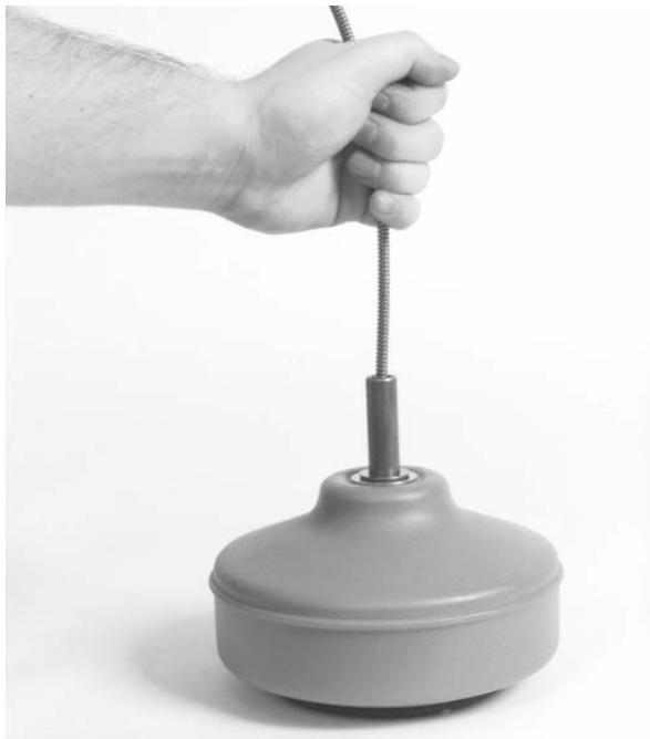
Figura 17 – Introducción del cable en el tambor
