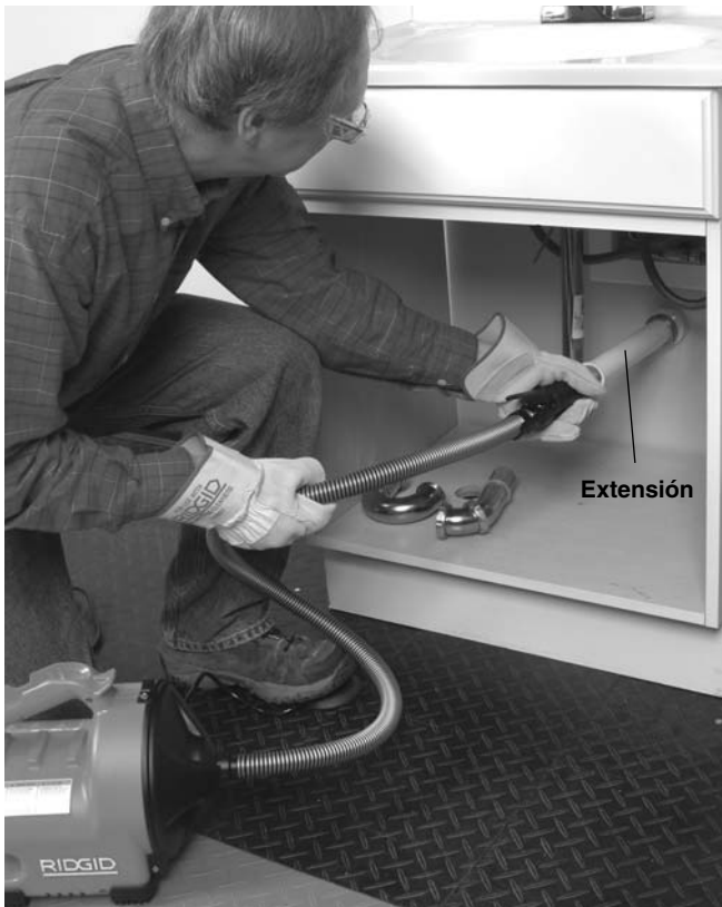
Figura 11 – Manera en que se alarga el acceso al desagüe hasta quedar a menos de 15 cms. de la AUTO-FEED.
