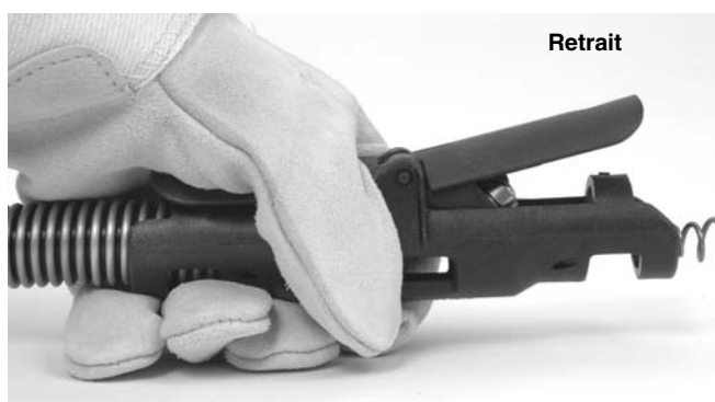
Figure 14B – AUTOFEED en position « retrait »
