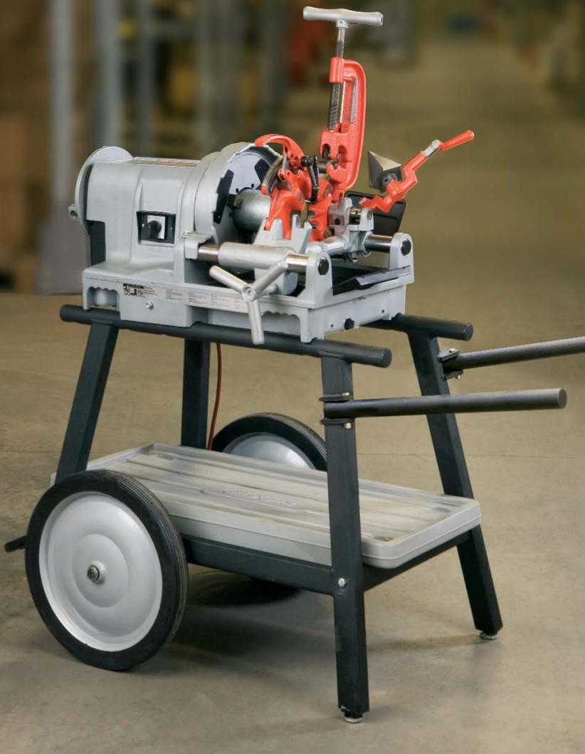
Máquina roscadora integrada de 1/8" --> 3" del equipo de ranuradoras de rodillo RIDGID.
