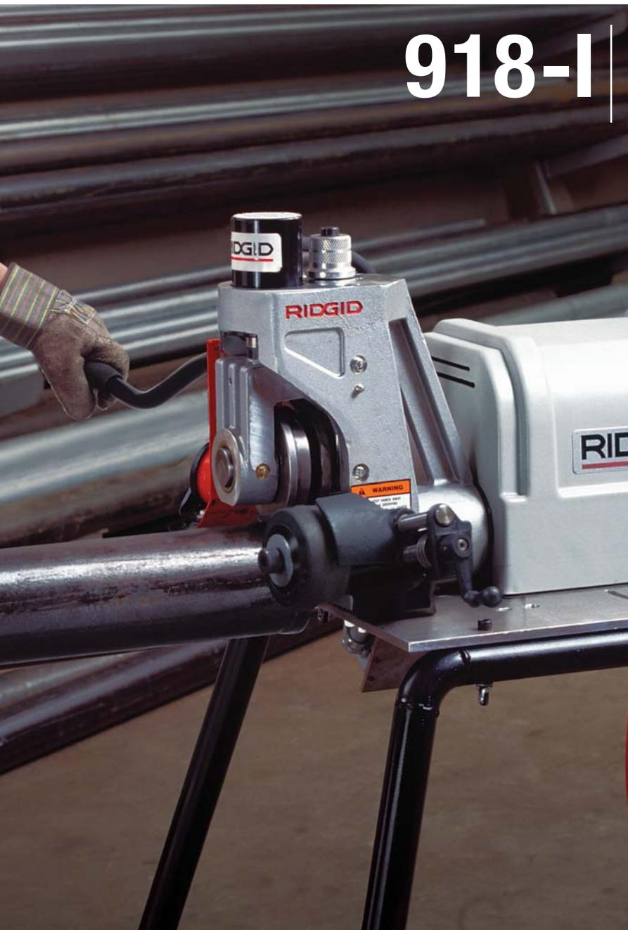
Ranuradora de rodillo hidráulica integrada, con motor universal, para crear ranuras estándar en tubos de hierro o de cobre.
