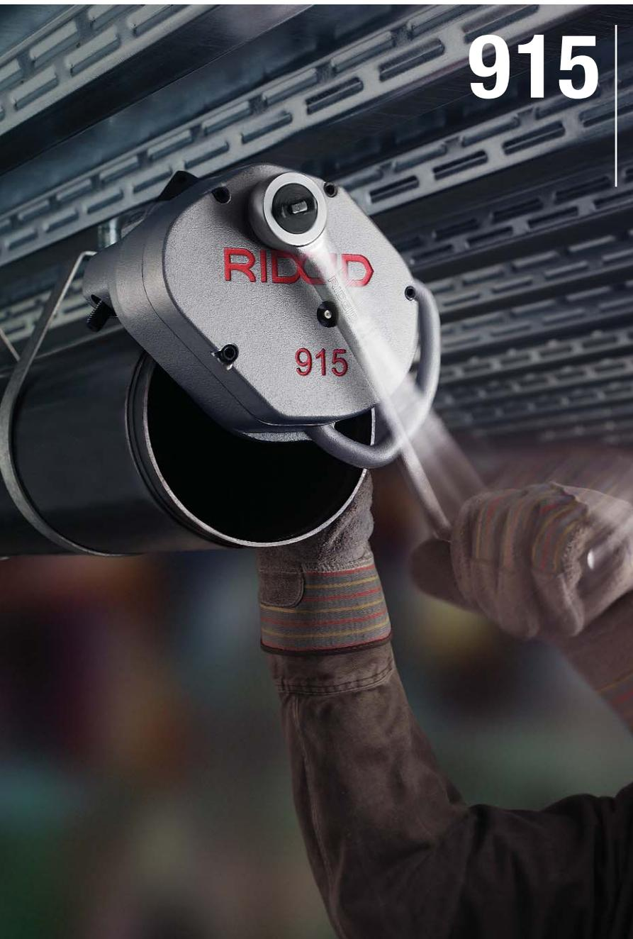
Unidad accionada por trinquete manual, para formar ranuras estándar en tubos de acero o de cobre.
