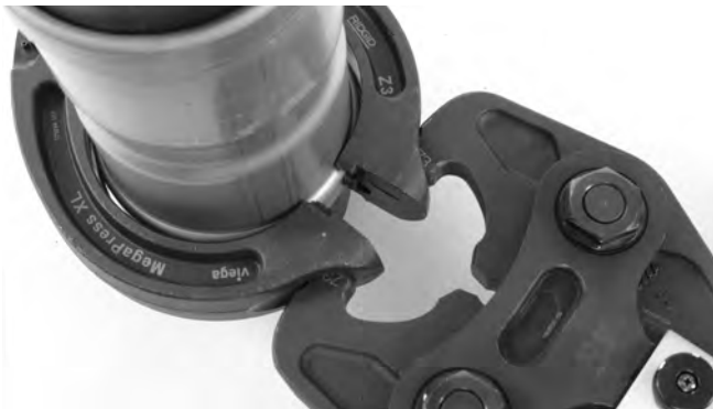
Figure 11 – Engagement de l'actionneur sur la bague de sertissage
