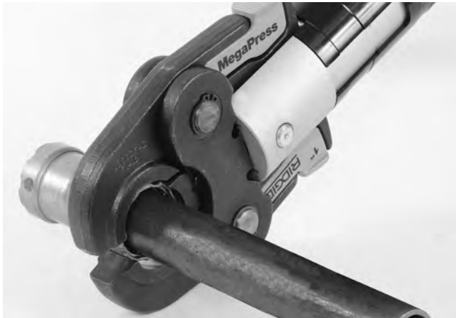
Figura 8 – Colocación de las mordazas para que encierren el acoplamiento
