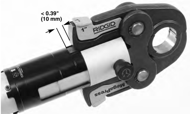
Figure 6B – Broche de montage complètement fermée
