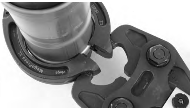
Figura 11 – Conexión del accionador al aro sellador
