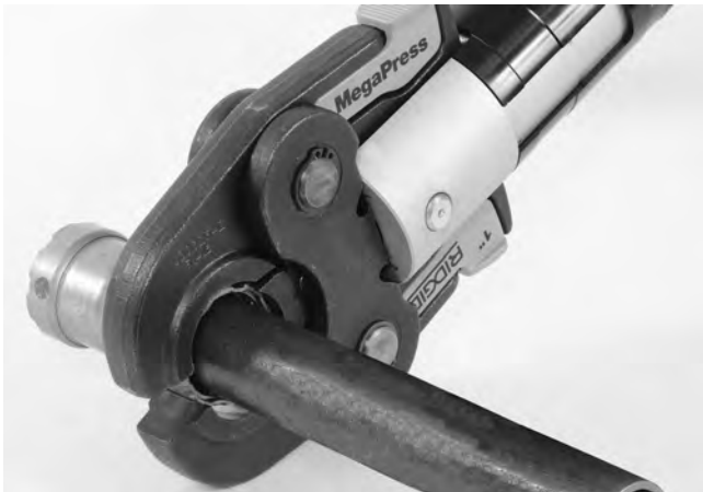
Figure 8 – Engagement des mâchoires autour du raccord
