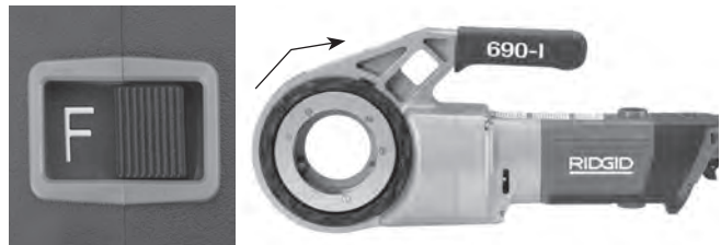
Abbildung 6A - Schalterstellung F (VORWÄRTS) (im Uhrzeigersinn)
