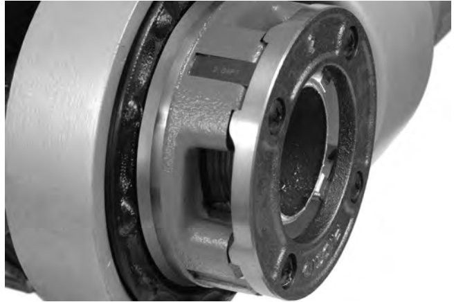
Figure 15 – Tuyau arrivé à fleur des filières
