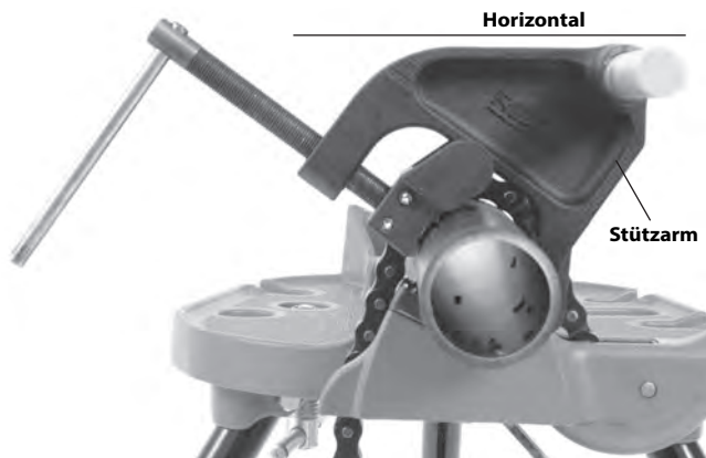
Abbildung 11A - Positionierung des Stützarms
