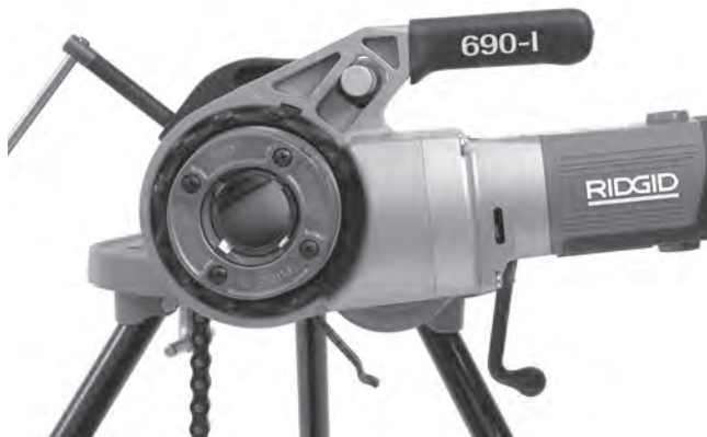
Abbildung 12 - Richtige Ausrichtung der Gewindeschneidmaschine
