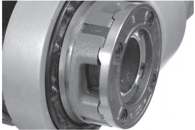
Abbildung 15 - Rohr mit Schneidbackenkante bündig
