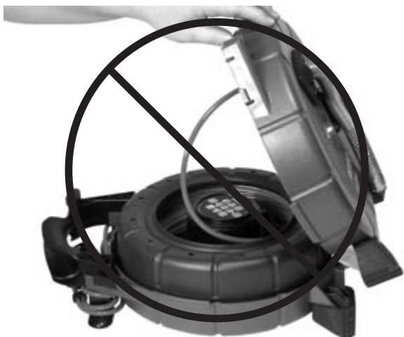
Slika 10 – Ne dozvolite da se kabl slobodno odmota
