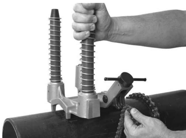
Abbildung 8 – Einhaken der Kette
