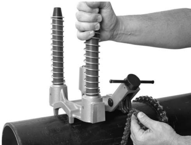
Figure 8 – Accrochage de la chaîne
