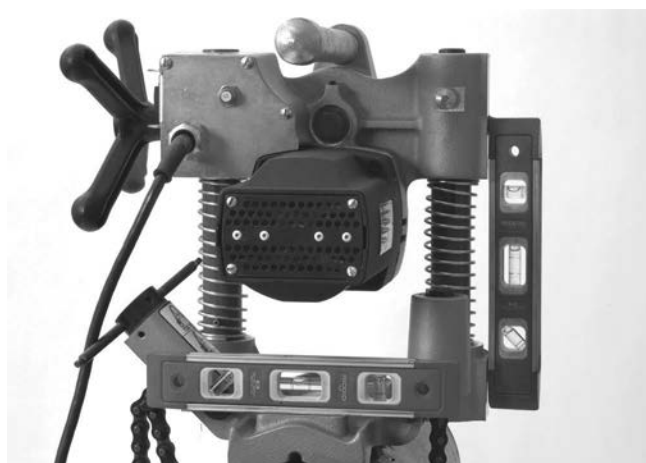
Obrázek 10 – vyrovnaní modelu HC-300
