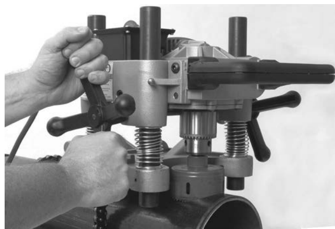
Slika 11 – Uporaba električne kronske žage
