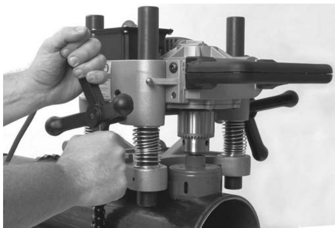
Obrázek 11 – Práce s nástrojem na vrtání otvorů
