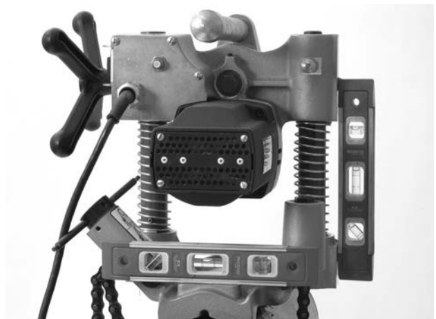
Figure 10 – Mise de niveau de la HC-300
