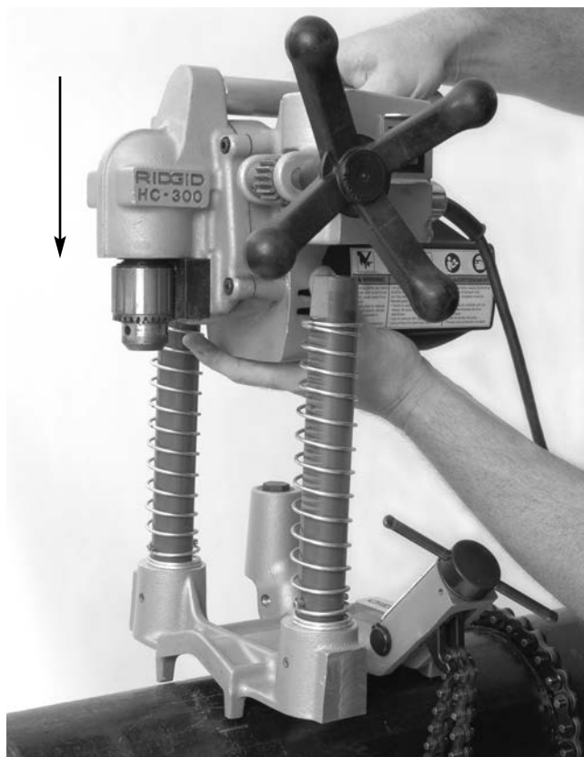
Figura 9 – Montaje del motor de la HC-300 a la base de la máquina
