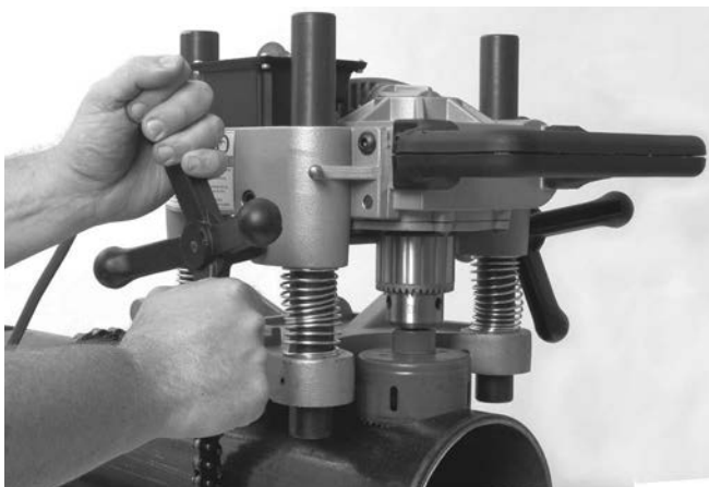
Figure 11 – Azionamento del Foratubi
