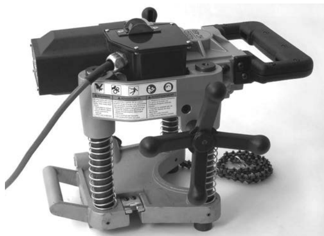
Slika 4A – HC-450 Upozoravajuće nalepnice
