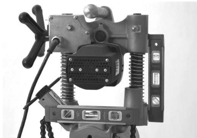
Rysunek 10 – Poziomowanie narzędzia HC-300
