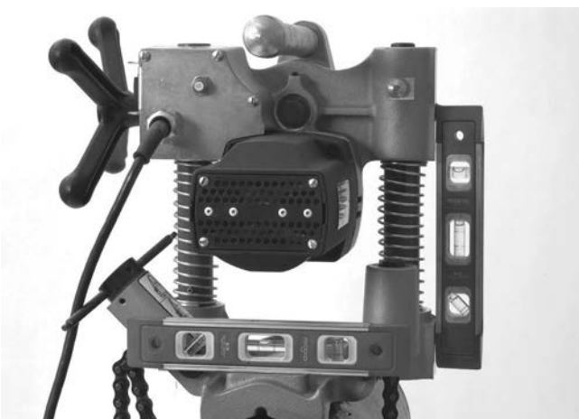
Figura 10 – Nivelamento da HC-300
