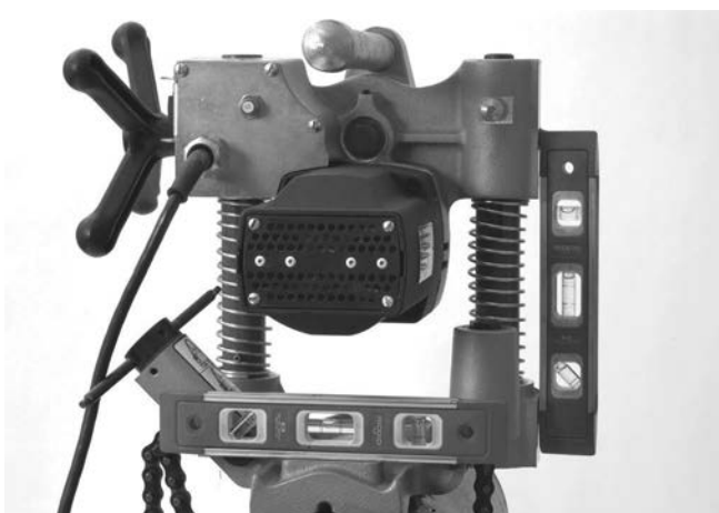
Figuur 10 – Waterpas zetten van de HC-300
