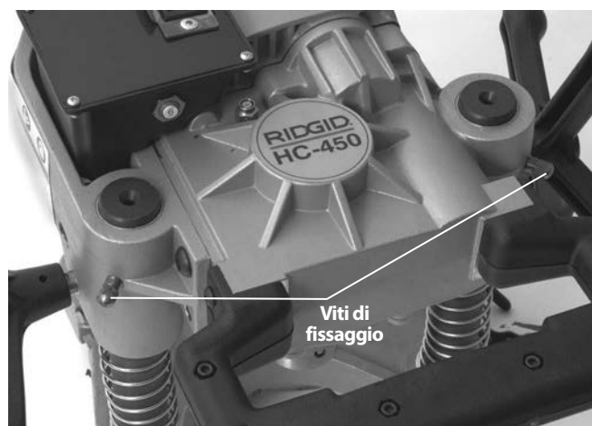
Figura 13 – Regolazione delle viti di fissaggio
