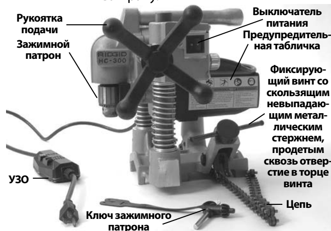
Рис. 2 – Модель HC-300 со стандартными принадлежностями
