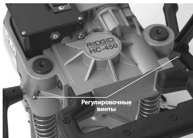
Рис. 13 – Регулировка регулировочных винтов
