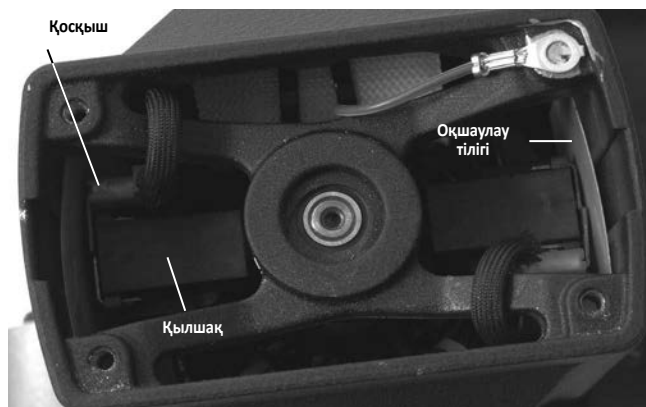
12-сурет – Қақпағы шешілген қозғалтқышқа қылшақты орнату
