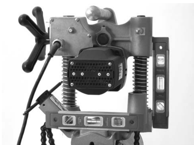
Figura 10 – Nivelación de la HC-300
