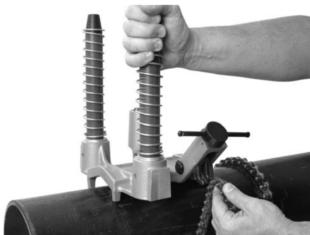
Figura 8 – Enganche de la cadena de la HC-300
