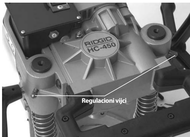
Slika 13 – Podešavanje regulacionog vijka
