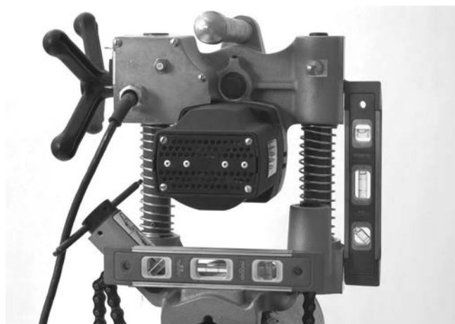
10. ábra – A HC-300 kiszintezése
