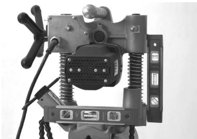
Εικόνα 10 – Ευθυγράμμιση του HC-300
