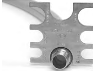
Figura 11 – Ajuste GO (correcto) con el calibre
