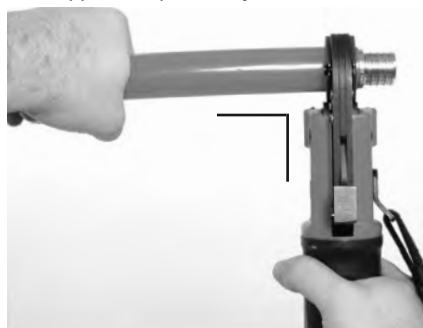
Figure 10 – Appareil d'équerre au tuyau
