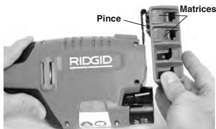
Figure 10 – Utilisation du porte-matrices
