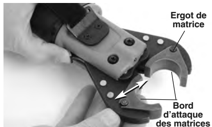
Figure 7 – Retrait et installation des matrices
