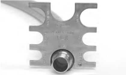
Figure 11 – Passage du gabarit « GO »
