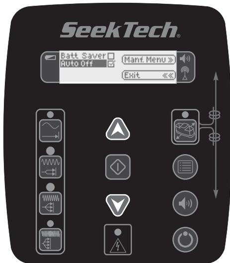
Figure 21 – Réglage du courant (flèches verticales)
