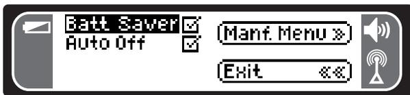
Figure 27 – Options « Économiseur de piles » et « Arrêt automatique »
