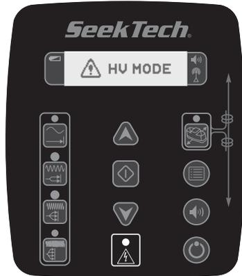
Figure 9 – Indicateur haute tension
