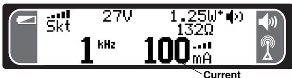
Figure 22 – Courant sélectionné
