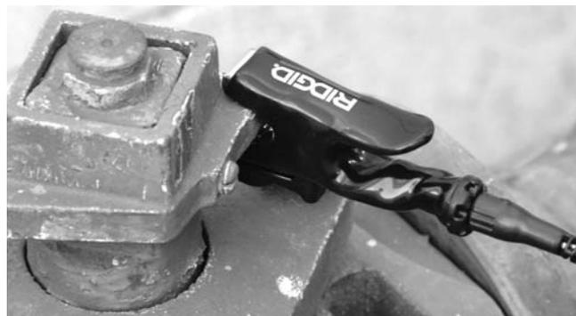
Figure 8 – Connexion du câble au conducteur ciblé.
