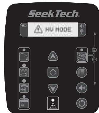
Figura 9 – Indicatore di alta tensione
