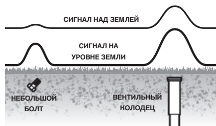
Рис. 6 – Подъем трассоискателя уменьшает сигналы-помехи
