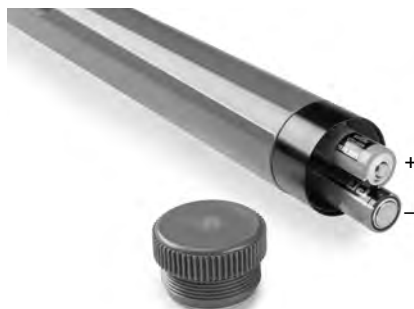
Figura 4 – Reemplazo de las baterías
