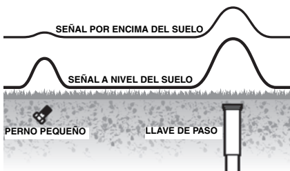
Figura 6 – Si levanta el localizador más lejos del suelo, se minimizan las señales indeseadas
