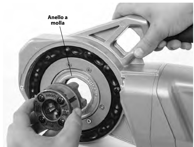
Figura 8 – Installazione di Teste di filettatura 11-R 1¼" o più piccole (solo 760 FXP 11-R)
