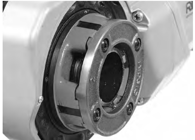
Obrázok 15 – Rúra zarovnaná s hranou závitnice
