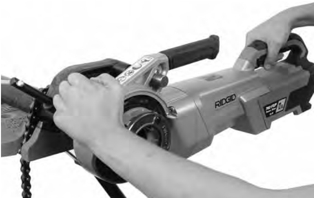
Εικόνα 13Β – Έναρξη της δημιουργίας σπειρώματος με χρήση του πέλματος ώθησης
