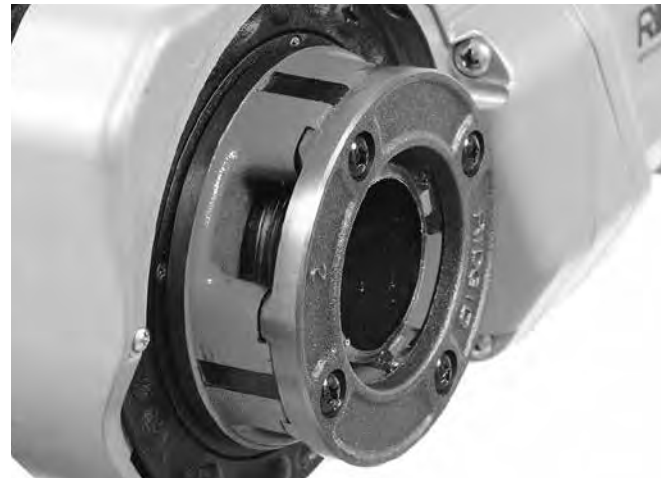
Figur 15 – Rør i niveau med kanten på bakkerne
