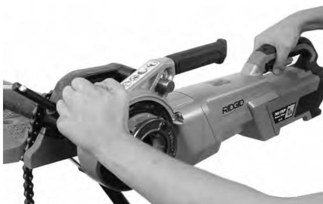
Slika 13B – Začetek rezanja navoja s pritisno ploščico
