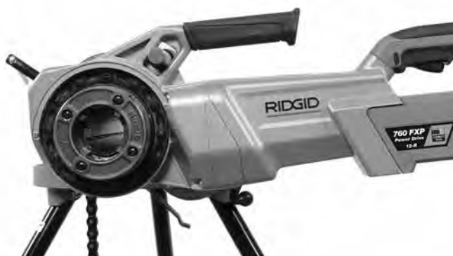
Slika 11 – Pravilno usmjerenje električne nareznice 760 FXP
