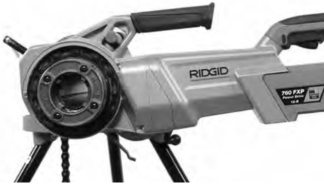
Figura 11 – Orientación correcta del accionamiento motorizado 760 FXP
