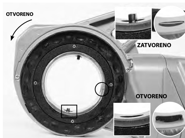
Slika 6A – Pričvrсни mehanizam (760 FXP 12-R)
