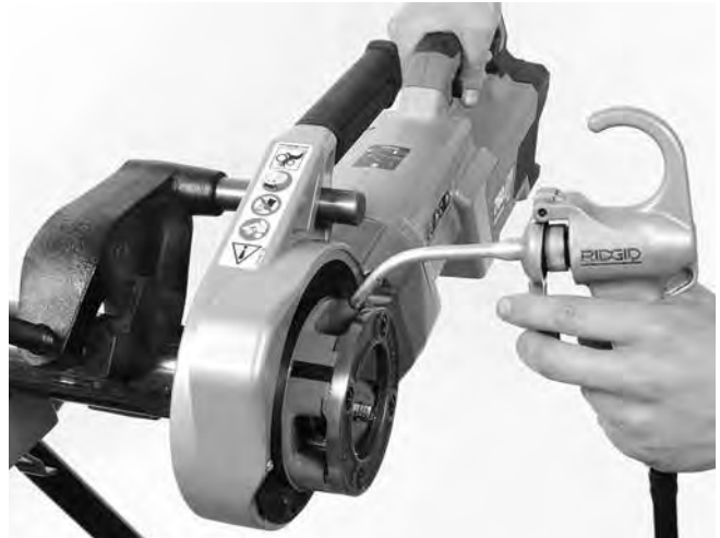
Figura 14 – Roscado de un tubo
