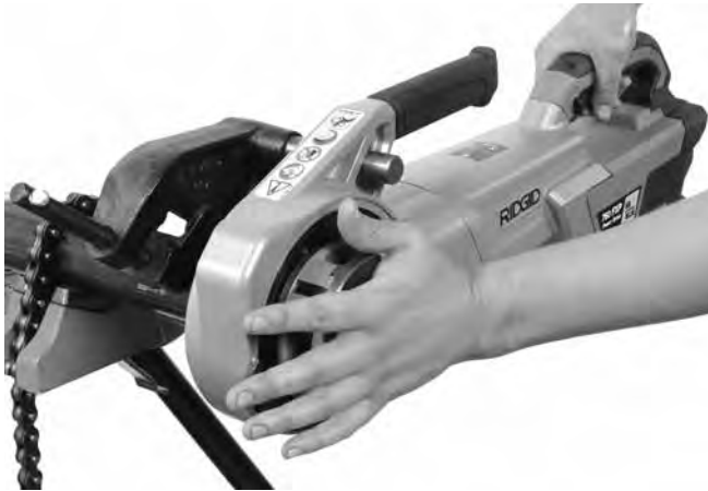
Figur 13A – Starte gjengingen med gjengehodets dekkplate
