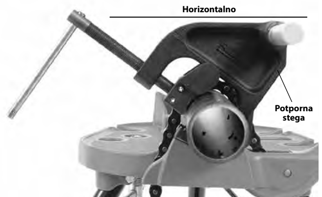
Slika 10A – Pozicioniranje potporne stega
