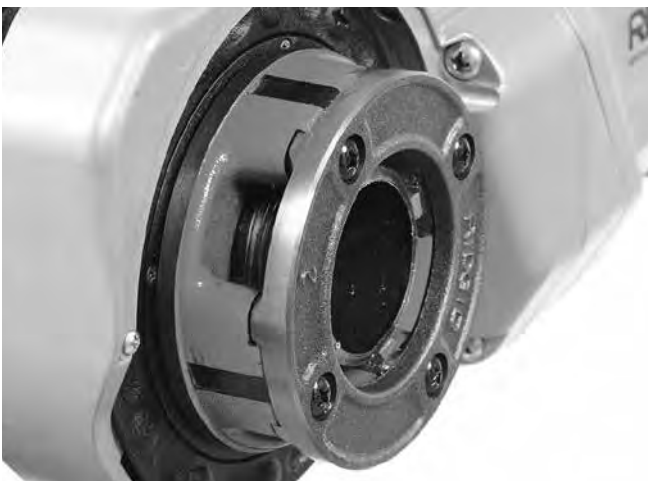
Abbildung 15 – Rohr fluchtet mit Kante der Schneidbacken
