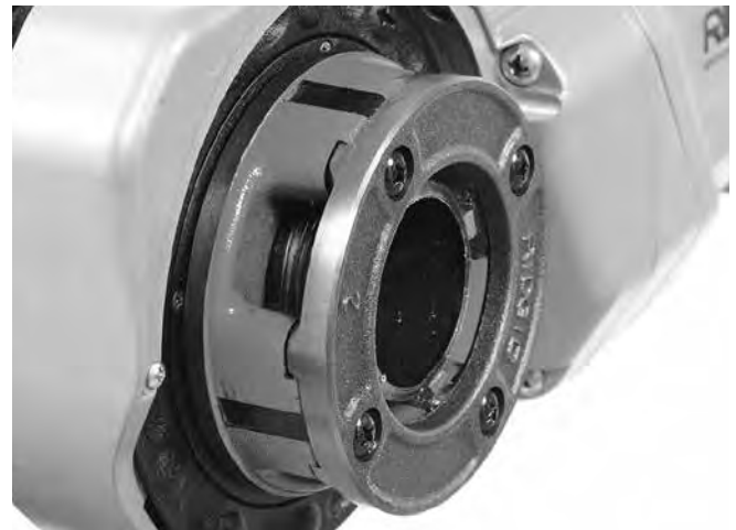
15. ábra – A cső a menetvágók szélével egy síkban van
