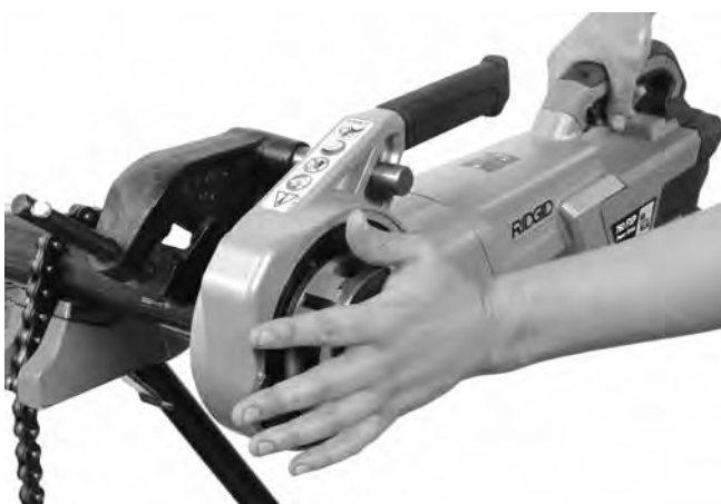
Slika 13A – Započinjanje navoja pomoću poklopca narezne glave
