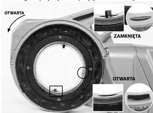
Rysunek 6A – Mechanizm mocujący (760 FXP 12-R)
