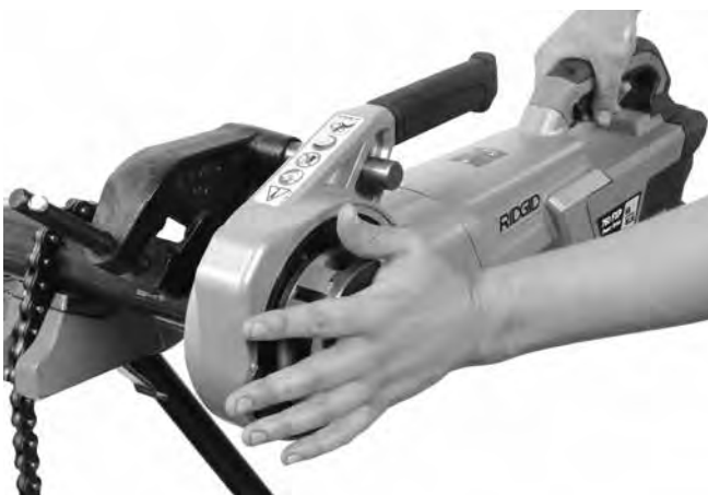
Rysunek 13A - Nacinanie początku gwintu przy użyciu płyty pokrywy głowicy gwinciarzkiej
