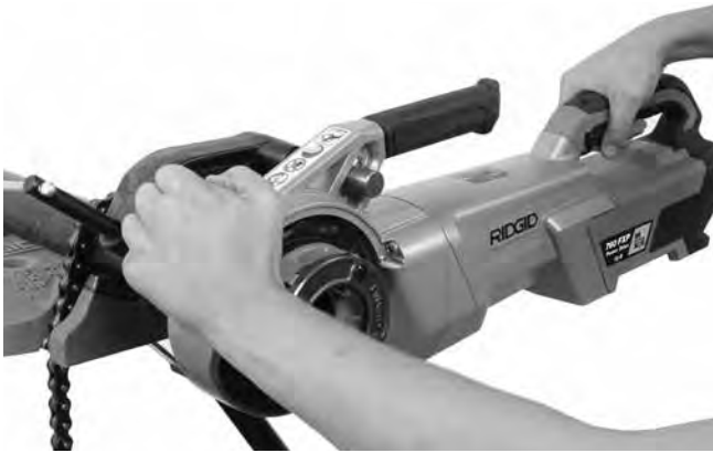
13B ábra – Menetvágás kezdése a nyomópárna használatával
