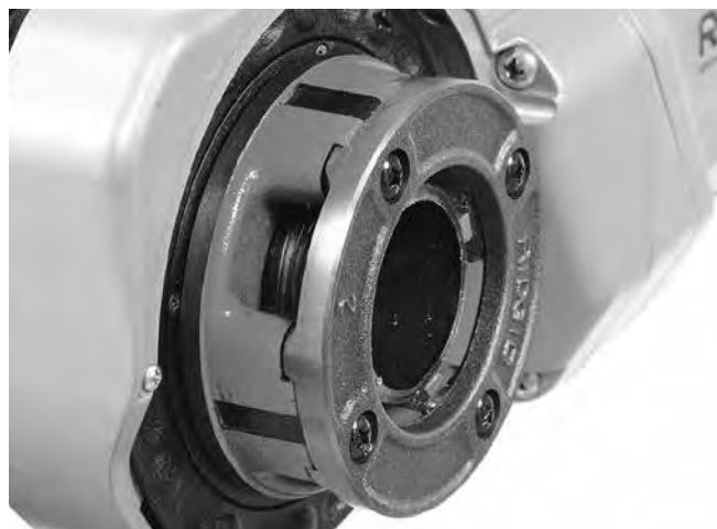
Figura 15 – Țeava la nivel cu marginea filierelor
