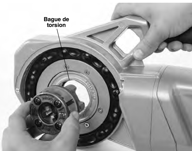
Figure 8 – Installation des têtes de filière 760 FXP 11-R d'un maximum de 1¼"
