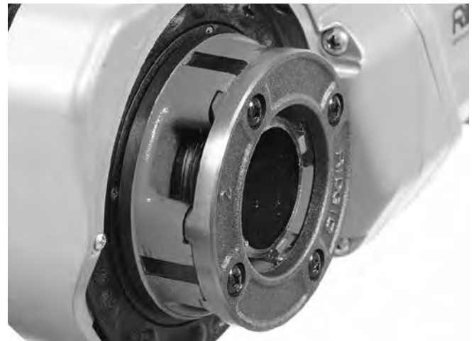
Figur 15 – Röret i linje med gängbackarnas kant
