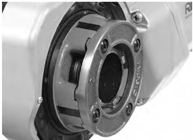
Figur 15 – Rør på linje med kanten av gjengebakkene
