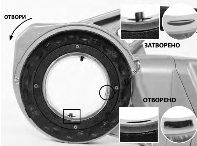
Фигура 6А – Задържащ механизъм (760 FXP 12-R)
