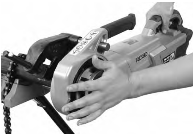
Kuva 13A – Kierteen aloittaminen käyttämällä kierrepään suojalevyä
