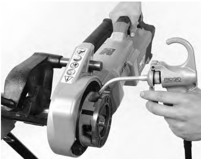
Figur 14 – Gevindskæring af rør
