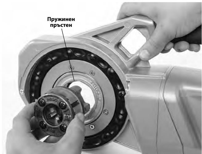
Фигура 8 – Инсталиране на 1¼" или по-малки 11-R глави на матрици (само 760 FXP 11-R)
