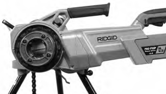
Figur 11 – Korrekt orientering av 760 FXP Power Drive
