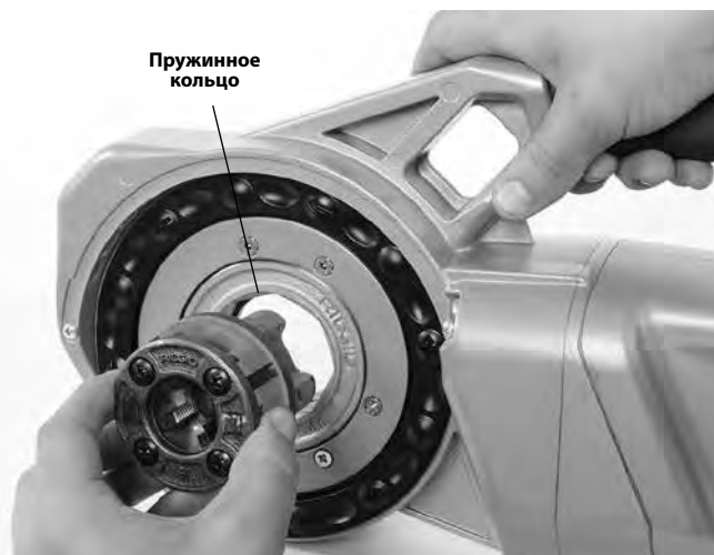
Рис. 8 - Установка 1¼" резьбонарезных головок меньшего размера 11-R (только 760 FXP 11-R)
