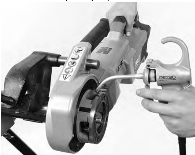
Obrázok 14 – Rezanie závitov na rúru
