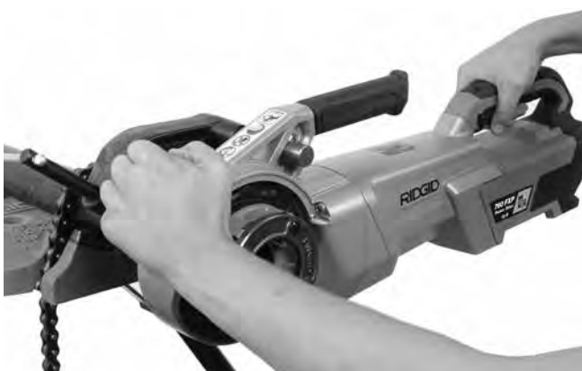
Slika 13B – Započinjanje navoja pomoću podloge za guranje
