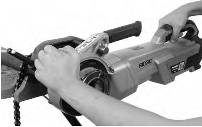
Şekil 13B – İtme Plakası Kullanarak Diş Açmanın Başlatılması
