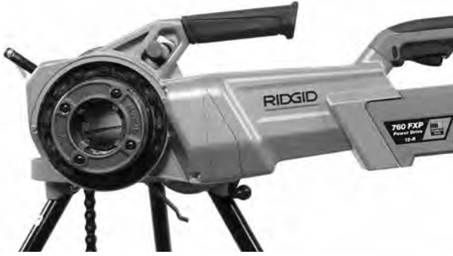
Şekil 11 – 760 FXP Elektrikli El Paftasının Doğru Yönü
