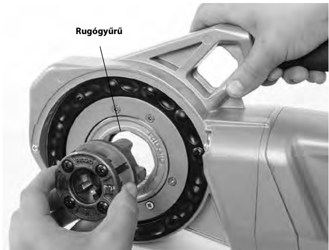
8. ábra – 1¼" vagy kisebb 11-R menetvágófejek (csak 760 FXP 11-R) beszerelése
