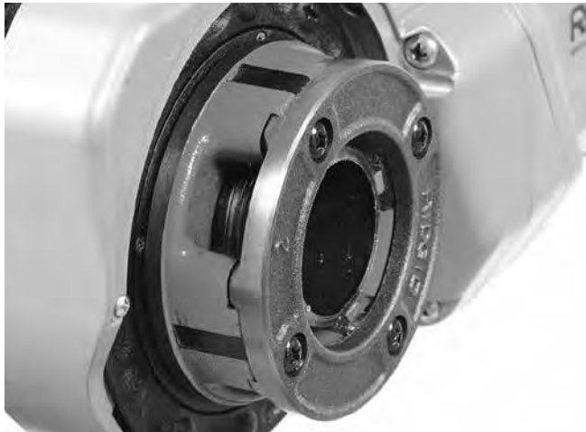
Figura 15 – El extremo del tubo está al ras con el borde de las terrajas
