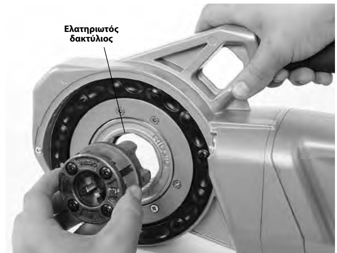
Εικόνα 8 – Εγκατάσταση φιλιέρας 11-R για μέγεθος 1¼" ή μικρότερα (760 FXP 11-R μόνο)
