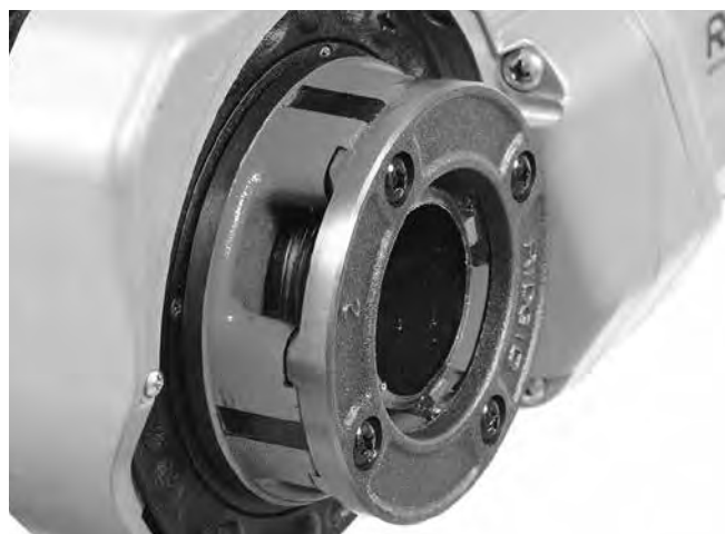
Obrázek 15 – trubka zarovnaná s okrajem řezných matic
