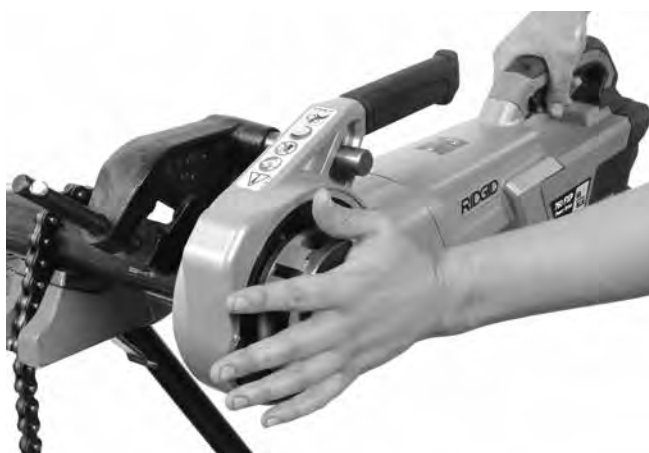
Slika 13A – Začetek rezanja navoja s pokrovno ploščo glave navojnega rezalnika
