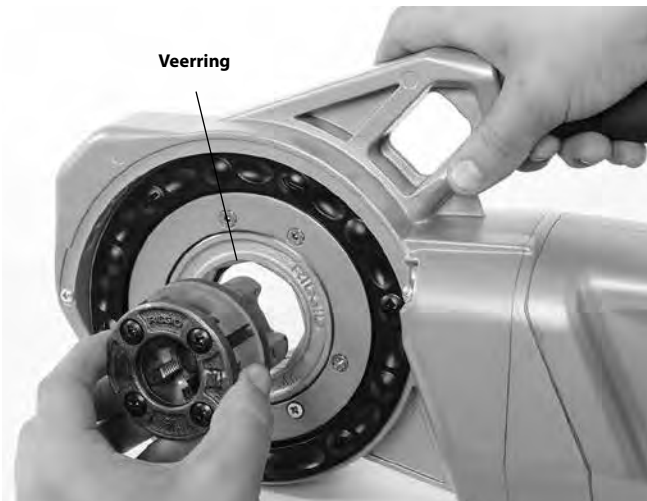
Afbeelding 8 – Draadsnijdkoppen van het type 11-R van 1 1/4" of kleiner monteren (alleen 760 FXP 11-R)
