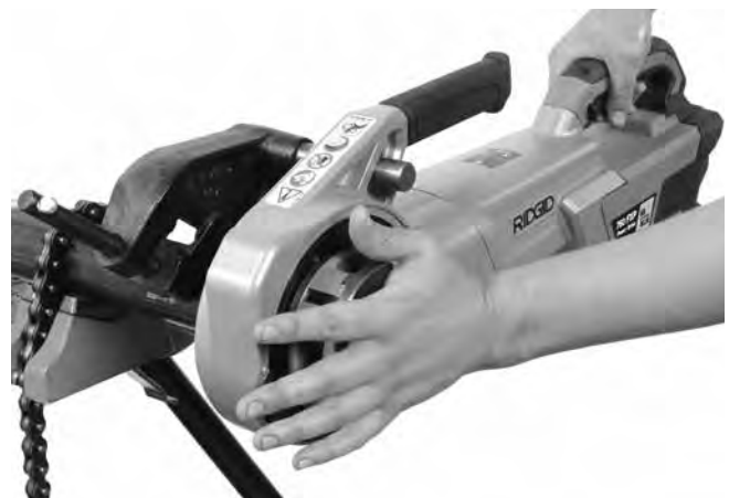
Obrázok 13A – Spustenie rezania závitov pomocou krycej dosky závitoreznej hlavy
