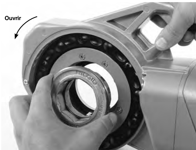
Figure 7 – Installation de l'adaptateur
