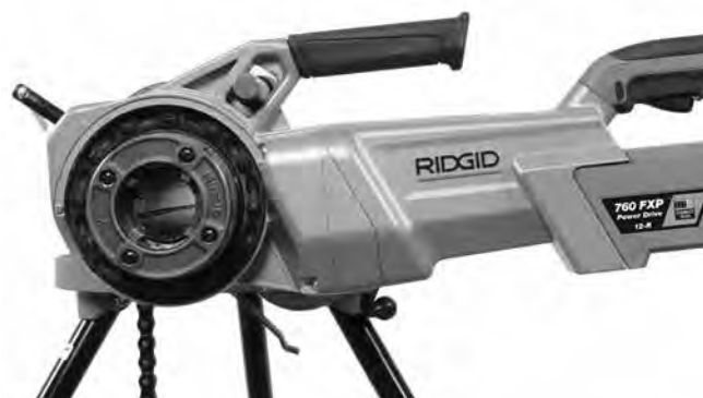
Рис. 11 - Правильная ориентация силового привода 760 FXP
