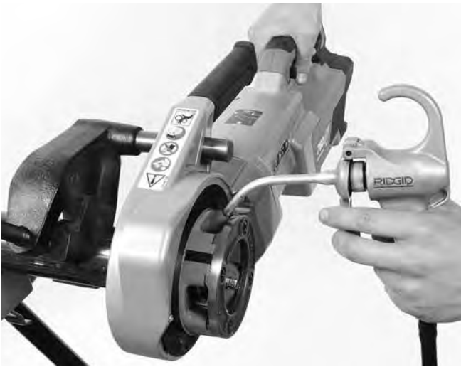
Abbildung 14 – Gewindeschneiden in Rohr
