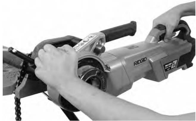
Rysunek 13B - Rozpoczęcie nacinania gwintu przy użyciu przycisku płytkowego
