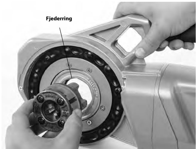
Figur 8 – Montering af 11-R skærehoveder, 1¼" eller derunder (kun 760 FXP 11-R)
