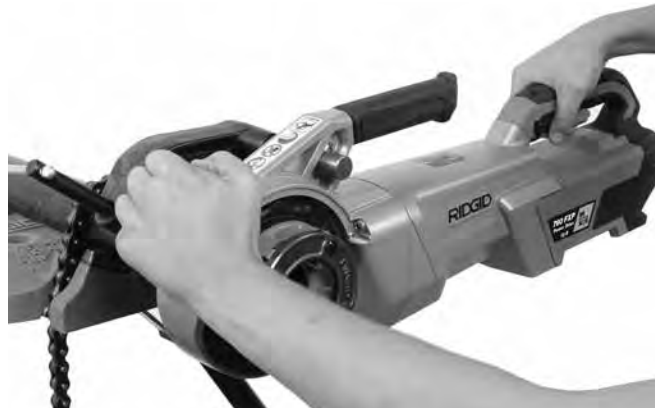
Рис. 13В - Начало нарезания резьбы с помощью нажимной площадки
