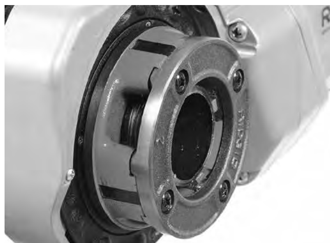
Slika 15 – Cev je poravnana z robom rezalnih nastavkov
