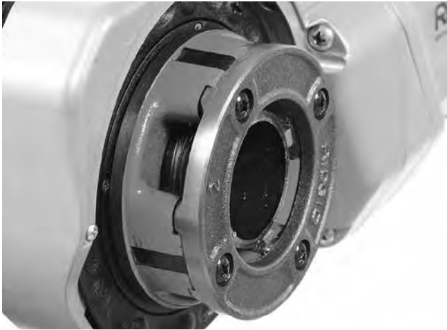
Εικόνα 15 – Σωλήνας στο ίδιο επίπεδο με το άκρο των μαχαιριών
