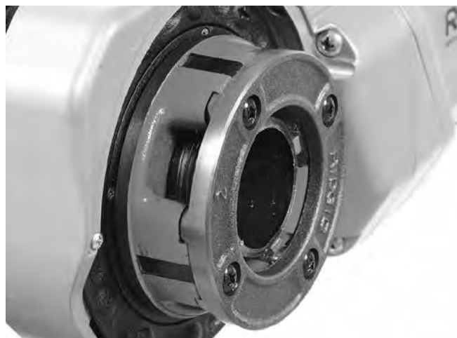
15-сурет – Кескіштер жиегімен бір деңгейдегі құбыр
