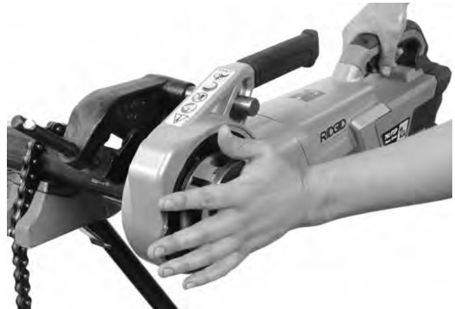
Şekil 13A – Pafta Kafası Kapak Plakasını Kullanarak Diş Açmanın Başlatılması
