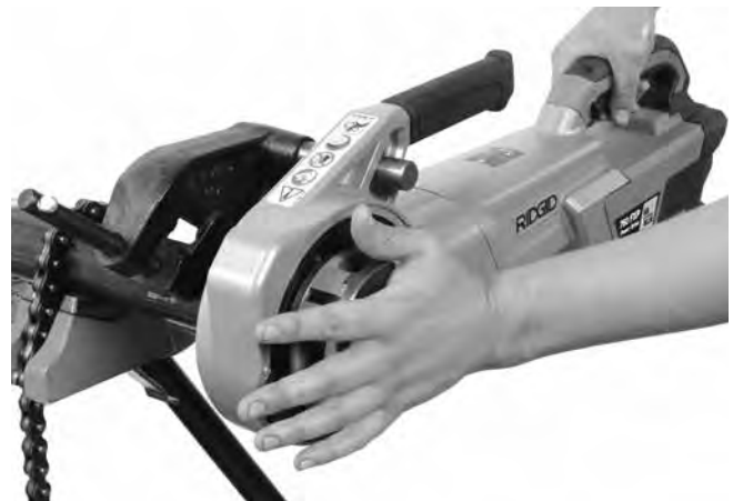
13A ábra – A menetvágás elkezdése a menetvágófej fedőlapjának használatával
