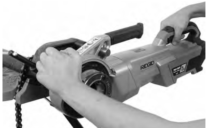
Slika 13B – Pokretanje narezivanja s pomoću pritisne ploče
