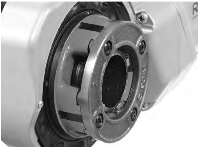
Rysunek 15 – Koniec rury wyrównany z krawędzią noży
