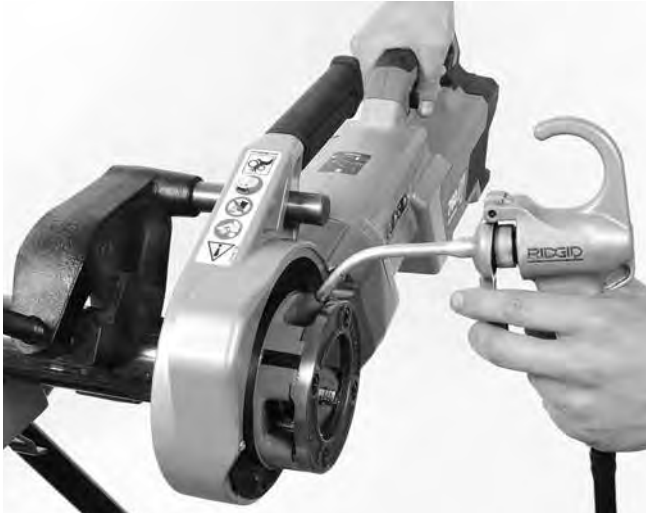
Şekil 14 – Boruya Diş Açılması
