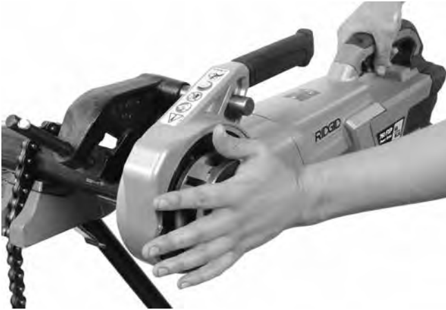
Εικόνα 13Α – Έναρξη της δημιουργίας σπειρώματος με χρήση της πλάκας καλύμματος της φιλιέρας
