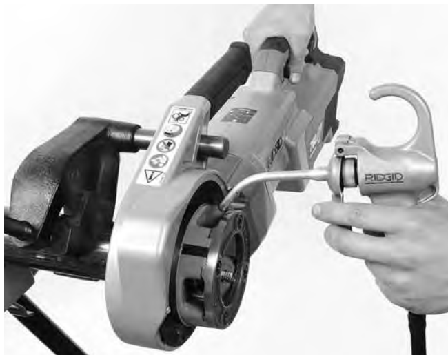
Рис. 14 – Нарезание резьбы на трубе
