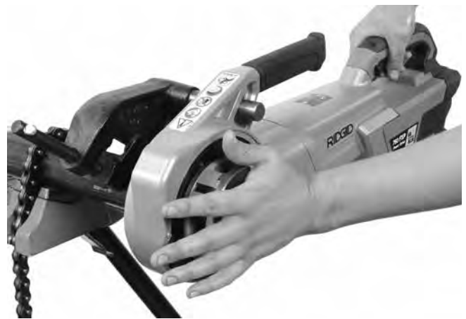
Figura 13A – Início da Rosca com a Placa de Cobertura da Cabeça de Roscar
