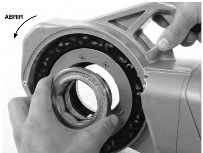
Figura 7 – Montaje del adaptador
