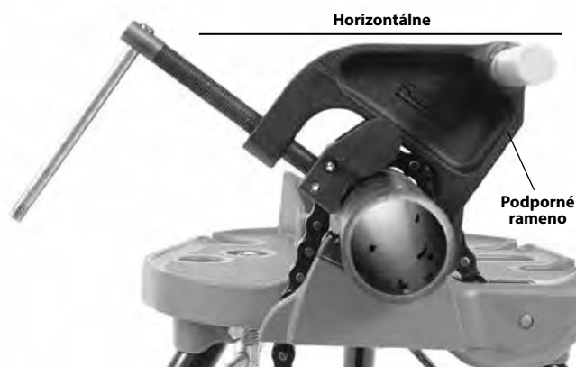
Obrázok 10A – Umiestnenie podporného ramena
