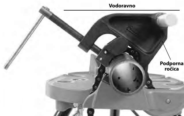
Slika 10A – Nameščanje podporne roke
