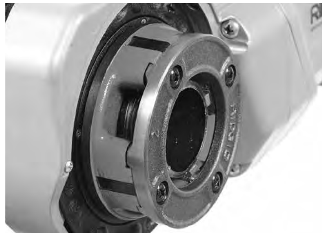
Figura 15 – Tubo allineato al bordo degli stampi
