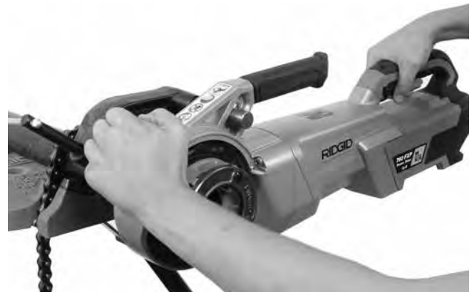
Abbildung 13B - Gewindeschneiden mithilfe des Druckkissens starten
