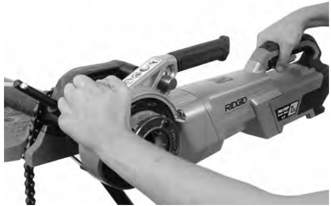
Kuva 13B – Kierteen aloittaminen käyttämällä työntölevyä
