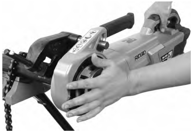
Рис. 13А - Начало нарезания резьбы с помощью крышки резьбонарезной головки
