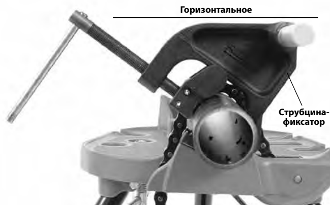
Рис. 10А - Позиционирование трубины-фиксатора
