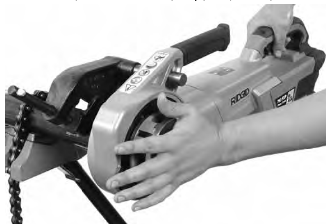
Figura 13A – Pornirea filetării prin utilizarea capacului capului-filieră
