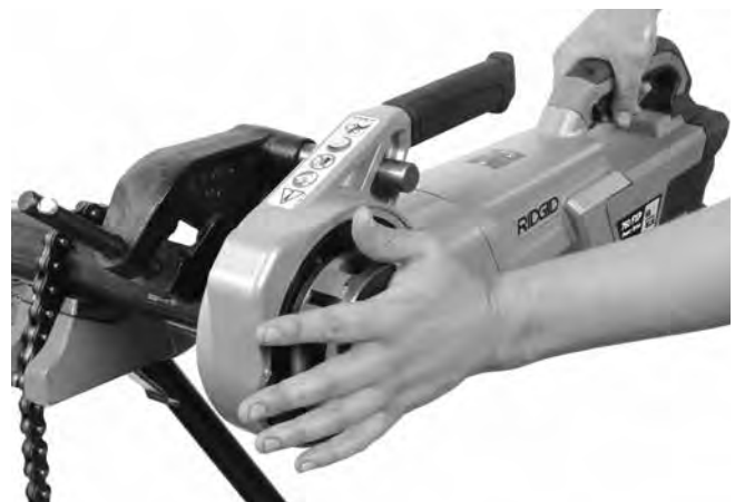
Figur 13A – Starta gängning med gänghuvudets täckplatta
