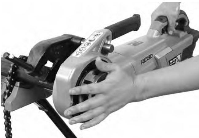
Abbildung 13A - Gewindeschneiden mithilfe der Schneidkopfabdeckplatte starten
