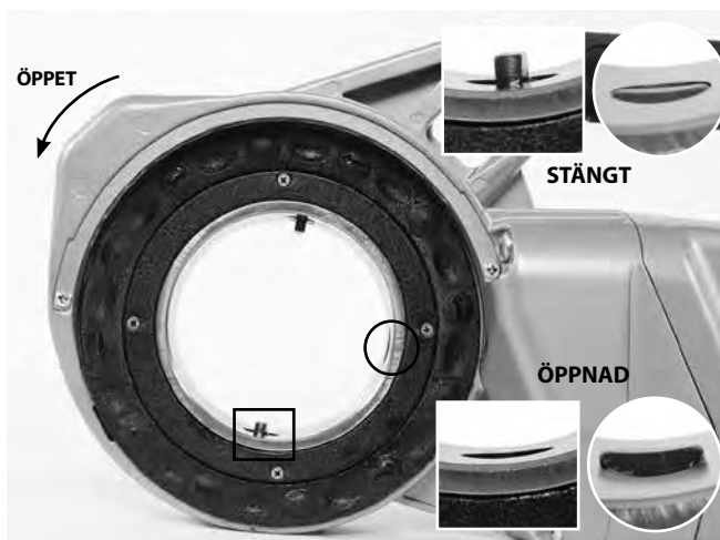
Figur 6A – Hållmekanism (760 FXP 12-R)
