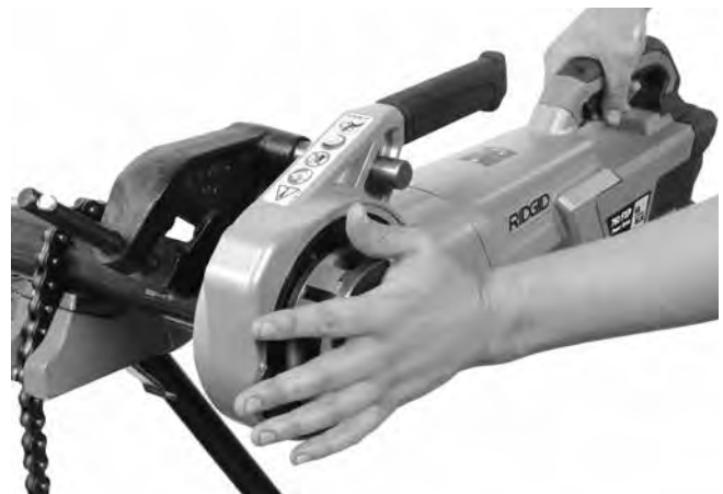
Фигура 13А – Започване на резбване с използване на капака на главата за матрици
