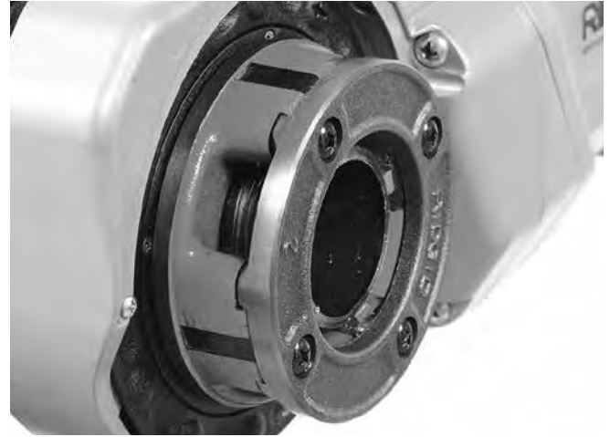
Şekil 15 – Paftanın Kenarıyla Hizalı Boru
