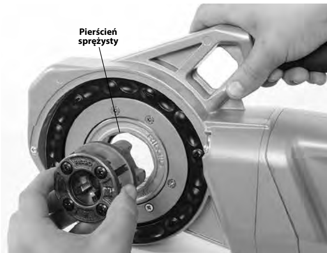
Rysunek 8 - Instalacja głowic 1 1/4" lub mniejszych 11-R (tylko 760 FXP 11-R)
