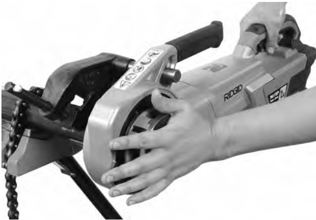
Figura 13A – Avvio filettatura utilizzando la piastra di copertura della testa di filettatura
