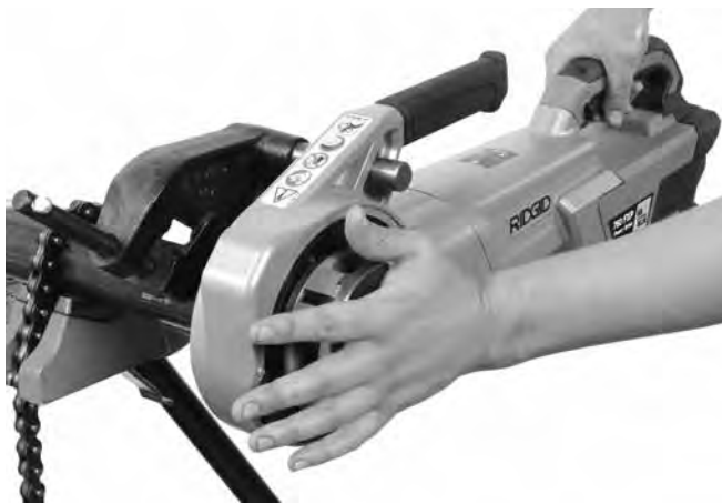
Afbeelding 13A – Met draadsnijden beginnen met behulp van de afdekplaat voor de draadsnijkop
