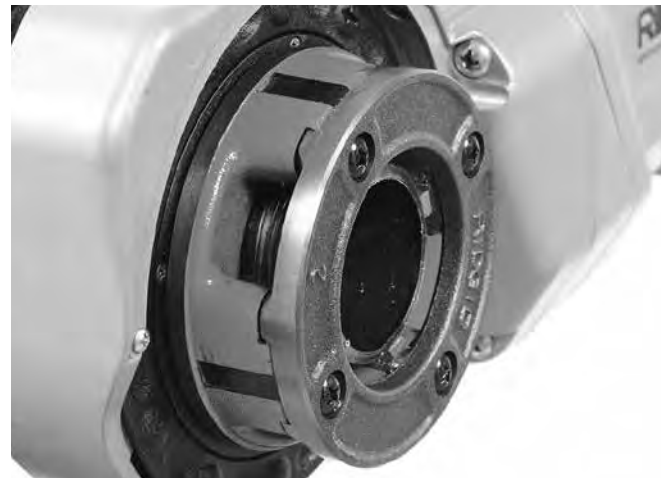
Figura 15 – Tubo alinhado com extremidade das tarraças
