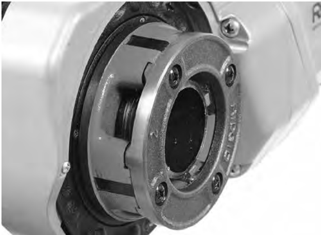
Slika 15 – Cijev poravnata s rubom noževa
