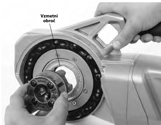
Slika 8 – Nameščanje 1¼" ali manjših 11-R glav navojnega rezalnika (samo 760 FXP 11-R)
