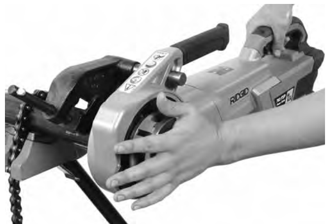
Obrázek 13A – Spuštění řezání závitů pomocí krycího plátu závitorezné hlavy
