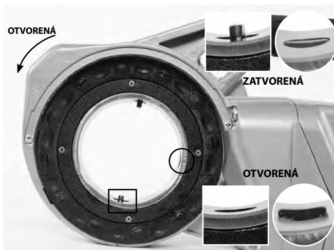
Obrázok 6A – Zaisťovací mechanizmus (760 FXP 12-R)
