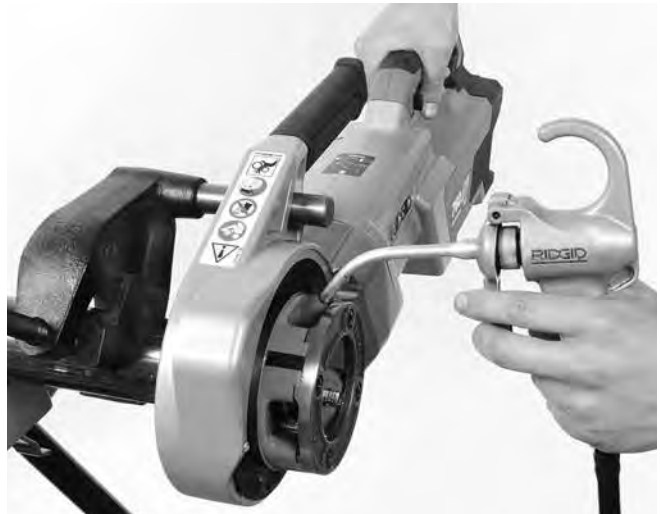
Figur 14 – Gjenging av rør
