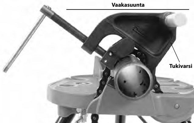
Kuva 10A – Tukivarren sijoittaminen
