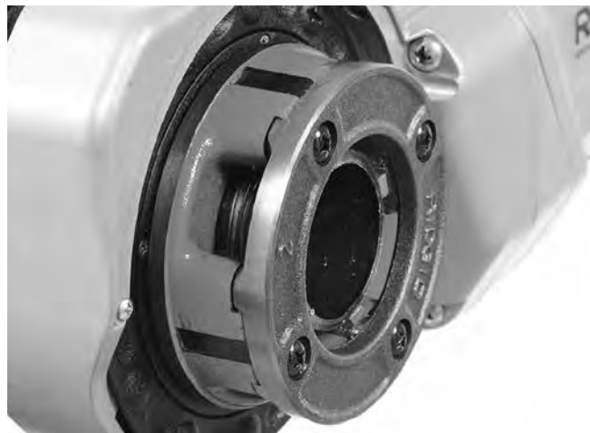
Рис. 15 – Торцы трубы ровный с кромкой резьбонарезных гребенок
