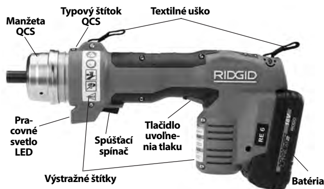
Obrázok 1 – RE 6/RE 60 – na pripojenie hlavice použite spojku QCS
