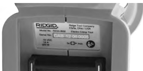
Obrázok 4 – Výrobné číslo náradia – prvé 4 číslice (zakrúžkované) označujú rok a mesiac výroby. (12 = rok, 06 = mesiac).
