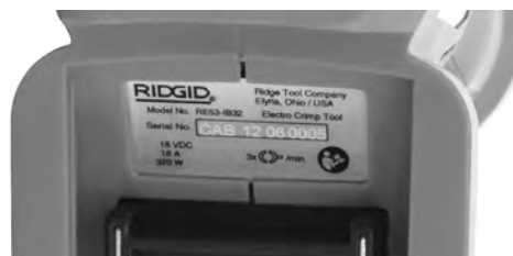
Kuva 4 – Koneen sarjanumero - Ensimmäiset 4 numeroa (ympyröity) tarkoittavat valmistusvuotta ja -kuukautta. (12 = vuosi, 06 = kuukausi).
