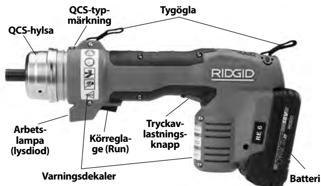
Figur 1 – RE 6/RE 60 – Använd QCS-koppling för huvudanslutning
