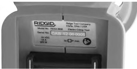
4. ábra – A gép sorozatszám - Az első 4. számjegy (bekarikázva) mutatja a gyártás évét és hónapját. (12 = év, 06 = hónap).
