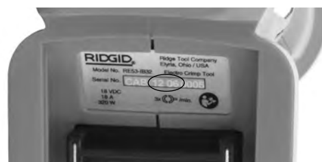
Figura 4 – Número de serie de la máquina. Los 4 dígitos iniciales (marcados con un círculo) indican el año y el mes de fabricación (12 = año, 06 = mes).
