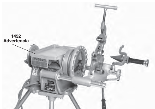
Figura 7 B – Instalación del carro 311 y herramientas
