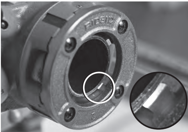
Figure 19 – Tuyau à fleur de l'extrémité des filières
