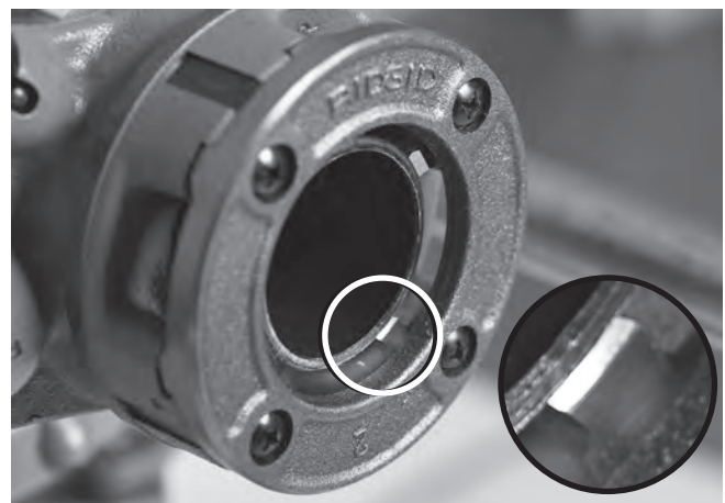
Figura 19 – Tubo al ras con el borde de las terrajas
